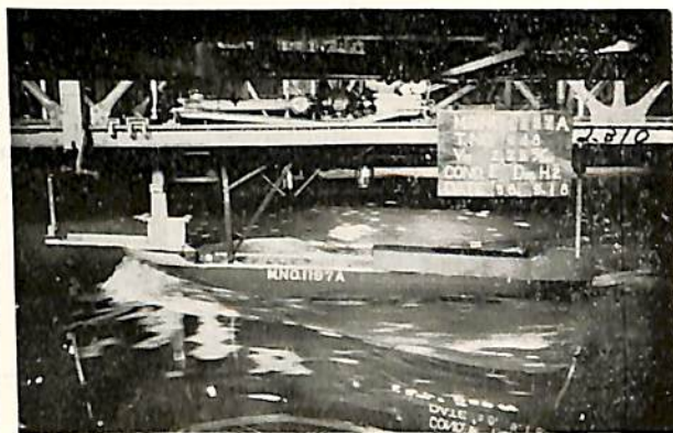
写真—11 V_m=2.310 m/sec H=45 cm 上限危険速度附近である。船尾トリムは相変わらず大きい。せき返し波は、丁度船首のところにあつて、まさに、船首はそのせき返し波をおしわけてゆく感じである。
