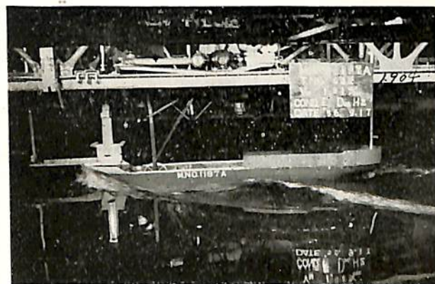
写真—8 V_m=1.904 m/sec H=6.00 cm 写真—7の速度に対応する水深が6.00mの場合である。両者の波型の相異、船尾トリムの大小がはつきりわかる。船尾には深水時の船尾波しかみえない。
