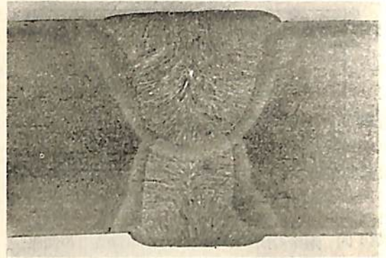
写真3 75 mm 鋼板の三電極溶接
