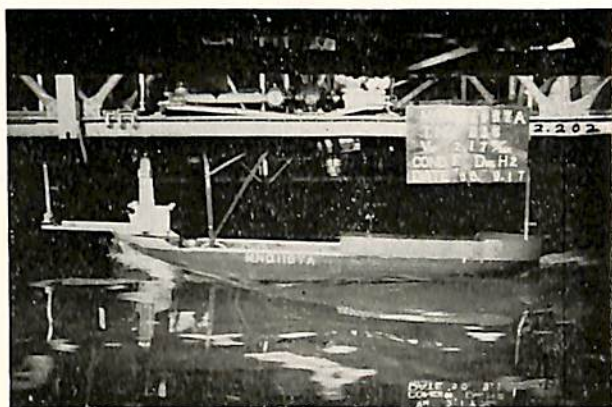
写真—10 V_m=2.202 m/sec H=45 cm 危険速度範囲内である。船尾トリムは相変わらず大きい。せき返し波が船首前方のごく近くにみえる。
