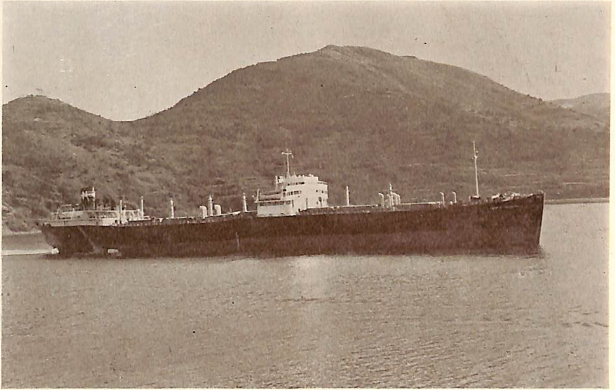
WORLD TREASURE (船体引延し油槽船を撒積貨物船に改造)
