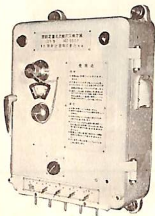
炭酸ガス測定器 (201型) (果物品質保持用)
