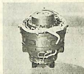
第16図 American Bosch Arma 社で開発されたフローティングジャイロ
