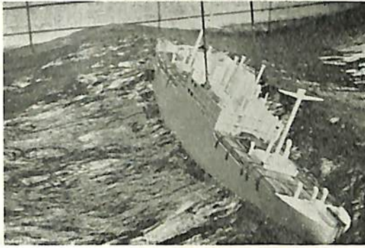
写真3 波による動揺試験
