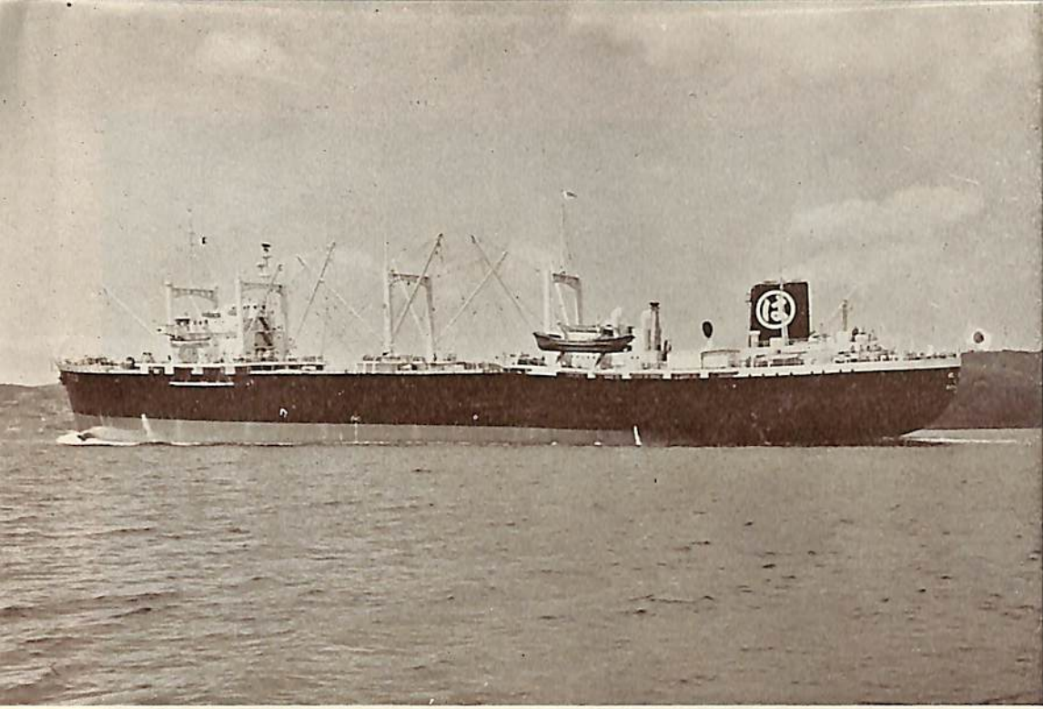
壮洋丸 全景 (ミール製造装置付冷凍冷蔵運搬船)
