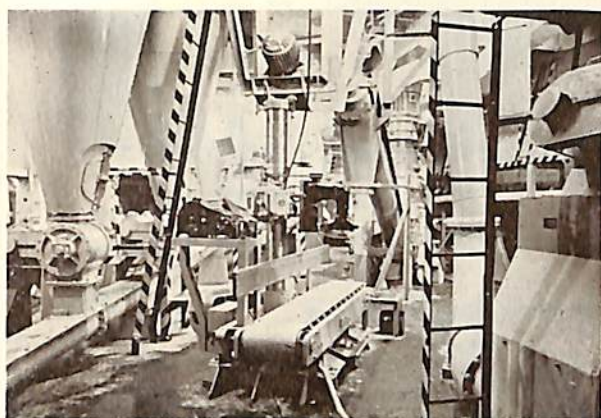
ミール工場 3rd Deck (左舷側を船尾より見る) 中央……Sewing Machine 左 ……Pre-drier Cyclones 右 ……Magnetic Separator & Pneumatic Meal Conveyor
