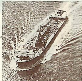
「シンクレア・ベトロロア」号は400,000バレルの石油あるいは67,000吨の鉄鉱石を輸送します。吃水線の長さは240米です。
