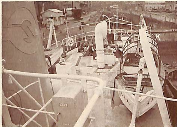
作業艇搭載状況
