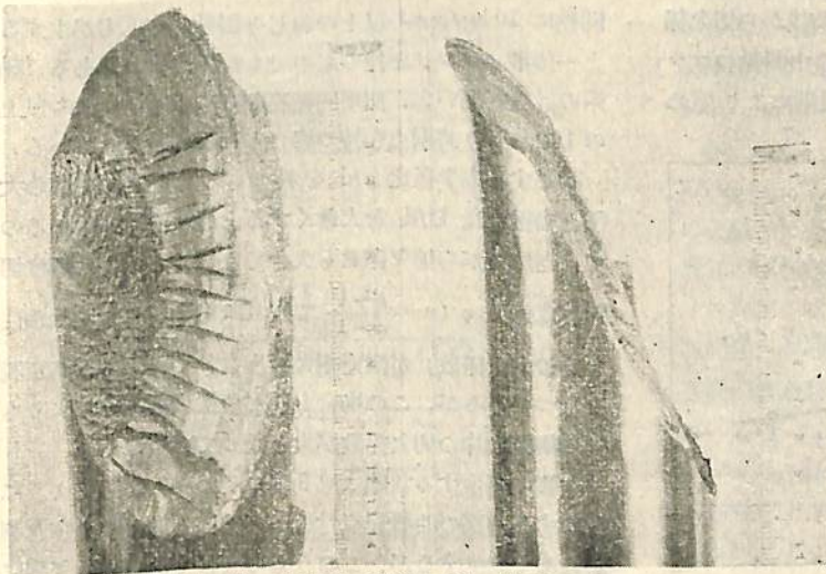
第4図 平滑軸の破断の例 (S20C (B) 材)
