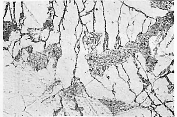
第13図 分岐した先端部のき裂 (×300)
