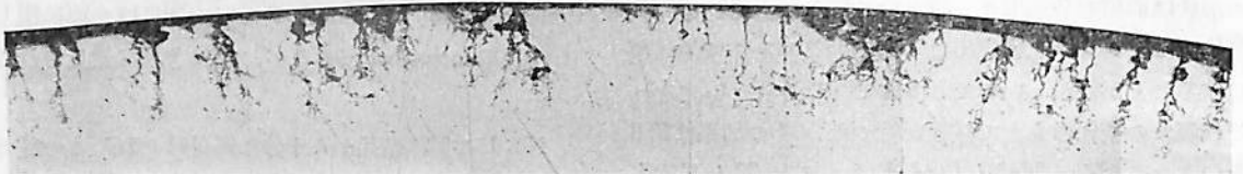
第14図 試験片の表面に分布した腐食疲れき裂 (×10)
