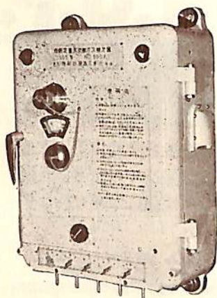
炭酸ガス測定器 (201型) (果物品質保持用)
