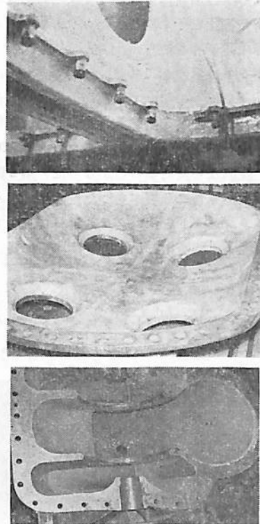
第 1 図 防蝕用ライニングとしてコードボンドを用いた例、上よりシーチェスト、コンデンサーカバー、ポンプ筐
