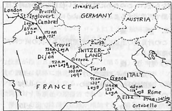
第1図 計算機に設定するレグの方位距離 (St. Inglevert-Rome 間航空路)
