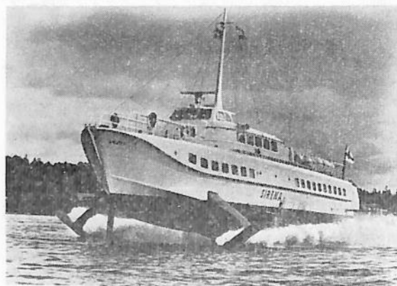
写真4 水中翼艇 PT 50, 速力41節, 逆転機 BW 800 機関 2×MB 820 Db 1,350 ps/1,500 r. p. m
