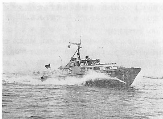
写真3 15.6米水上警備艇, 速力19.3節, 逆転機 BW 200, 機関 MB 836 500 ps/1,500 r. p. m
