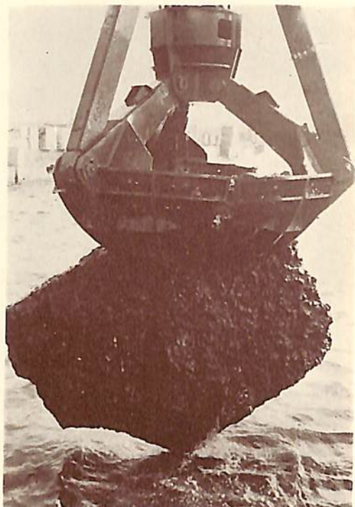
浚渫用新型グラブ・バケット
