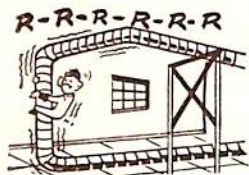
コンプレッサー 配管の振動
