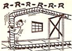
コンプレッサー 配管の振動
