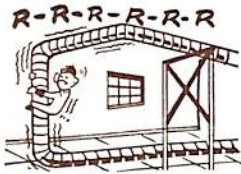
コンプレッサー 配管の騒音
