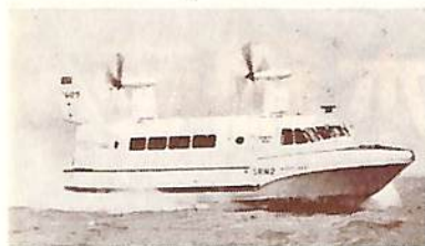
ウエストランドSR.N2はニムス エンジン4基装着
