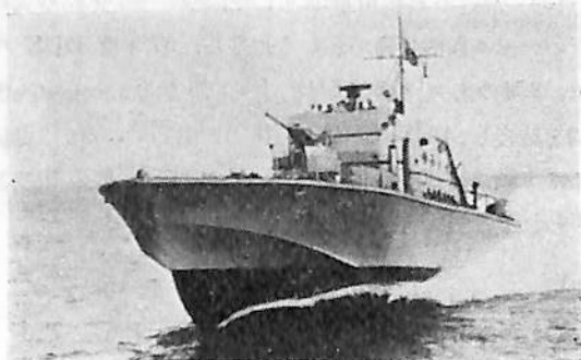
第1図 Brave Borderer, 主機にも補機にもガスタービン以外のエンジンは積んでいない。
