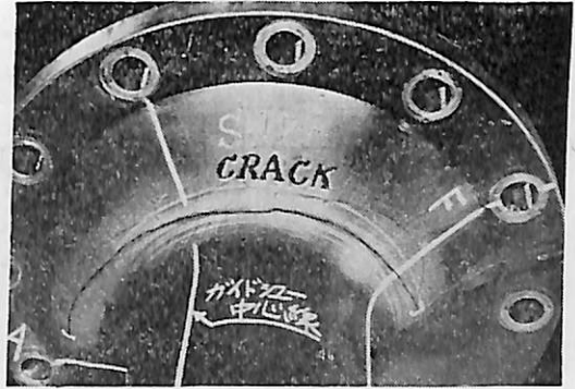
図13 ピストン・ロッド上部フランジのき裂 （繰返し数 3.7\times 10^7 ）
