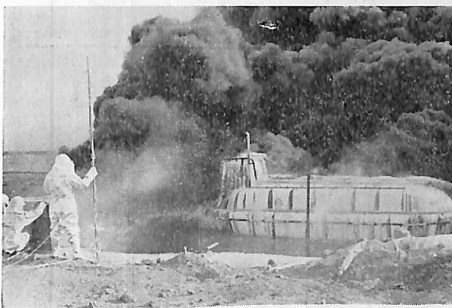
図-5 点火6分後の艇および火災状況 (A 実験)
