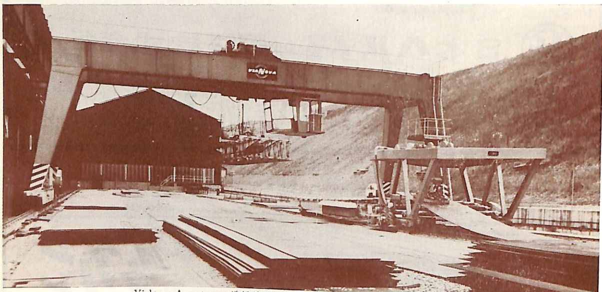
Vickers-Armstrongs 造船所で使用中の15トン、マグネット・ガントリー・クレーンとキャプチベーター 同装置は日本鋼管鶴見造船所にも稼動中
