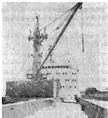
第 11 図 MS “Krasnograd” 号に装備された“ハーレン”式振廻しブームの配置図
