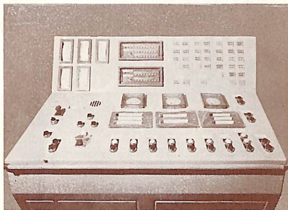
MOSKING号の多点温度監視盤
