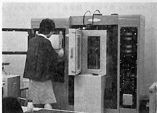
写真1 単糸の強伸度引張試験, 単糸の引張試験は恒温恒湿室において写真のような高性能引張試験装置を使用する
