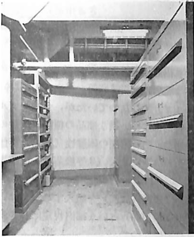
写真 3. 機関室（第一補機室） 倉庫内引出式キャビネットの配置例
