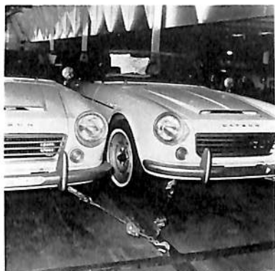
ホールドに納まった車は このよ うに止め具で固縛される。
