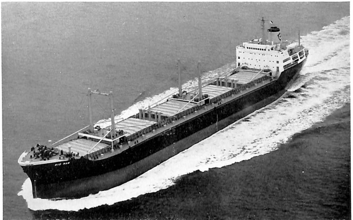
RIO MAR (ばら積貨物船) 船主 MARALADA COMPANIA NAVIERA (リベリア) 造船所 株式会社 大阪造船所 全長 180.00 m 長(垂) 170.00 m 幅(型) 23.30 m 深(型) 13.70 m 吃水 9.45 m 総噸数 16,334.33 噸 載貨重量 30,810.00 噸 速力 15.40 ノット 主機 浦賀スルザー 7 RD 76 型ディーゼル機関1基 出力 10,080 PS×117 RPM 船級 AB 起工 40-6-3 進水 40-8-23 竣工 40-11-10
