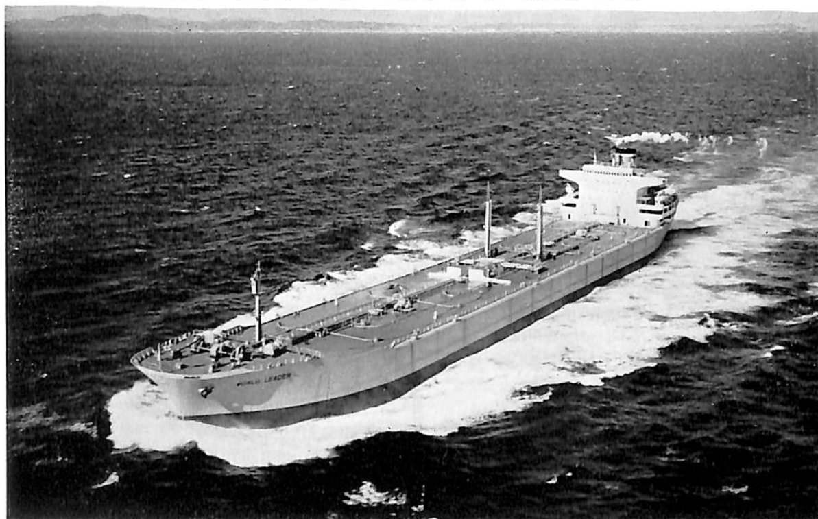
WORLD LEADER (油槽船) 船主 THE UNICORN SHIPPING CO. (ホンコン) 造船所 浦賀重工・浦賀工場 長(垂) 224.00 m 幅(型) 32.20 m 深(型) 16.05 m 吃水 11.55 m 総噸数 34,725.95 噸 載貨重量 55,755.00 噸 速力 16.5 ノット 主機 浦賀スルザー8 RD 90 型 ディーゼル機関1基 出力 18,400 PS×122 RPM 船級 LR 起工 40-5-10 進水 40-9-7 竣工 41-1-12
