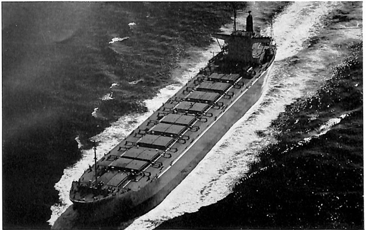
尾道丸 (ばら積貨物船) 船主 日本郵船株式会社 造船所 日本鋼管・鶴見造船所 長(垂) 216.4 m 幅(型) 31.7 m 深(型) 17.3 m 吃水 11.5 m 総噸数 34,500 噸 載貨重量 55,000 噸 速力 15.1 ノット 主機 浦賀スルザー 6 RD 90型ディーゼル機関1基 出力 15,000 PS×122 RPM 船級 NK 起工 40-5-25 進水 40-10-15 竣工 40-12-25
