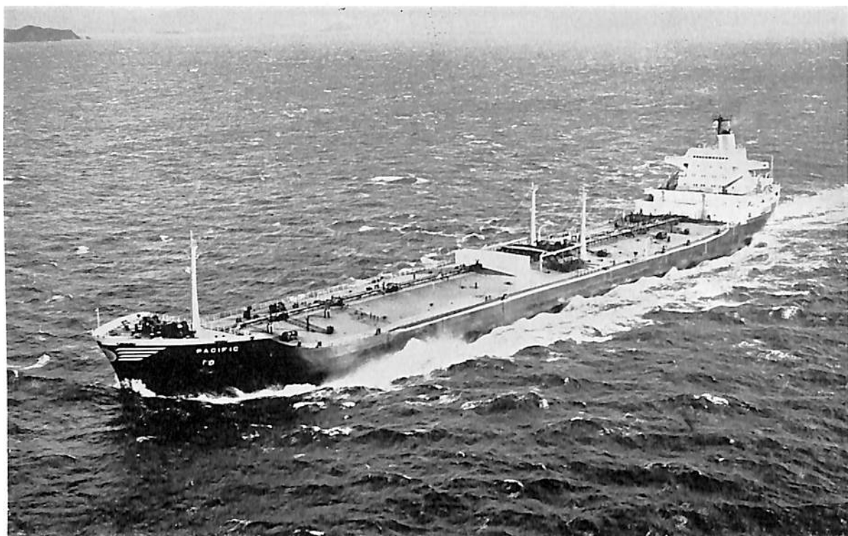
PACIFIC (油槽船) 船主 CELESTIAL SHIPPING CORP.(パナマ) 造船所 石川島播磨重工・相生工場 長(垂) 225.45 m 幅(型) 31.7 m 深(型) 17.0 m 吃水 11.13 m 総噸数 39,000 噸 載貨重量 62,000 噸 速力 16.0 ノット 主機 IHI-タービン1基 出力(連続最大) 20,250 PS 船級 AB 起工 40-6-12 進水 40-8-23 竣工 40-12-4
