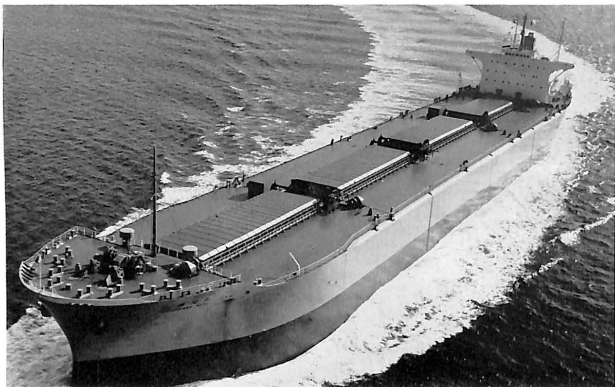
八 潮 川 丸 (鉱石運搬船) 船主 川崎汽船株式会社 造船所 株式会社 呉造船所 全長 223.26 m 長(垂) 213.00 m 幅(型) 31.70 m 深(型) 17.60 m 吃水 11.80 m 総噸数 35,100 噸 載貨重量 67,470 噸 速力 14.95 ノット 主機 IHI-スルザー6 RD 90型ディーゼル機関1基 出力 12,750 PS×118.5 RPM 船級 NK 起工 40-7-5 進水 40-9-24 竣工 40-12-20
