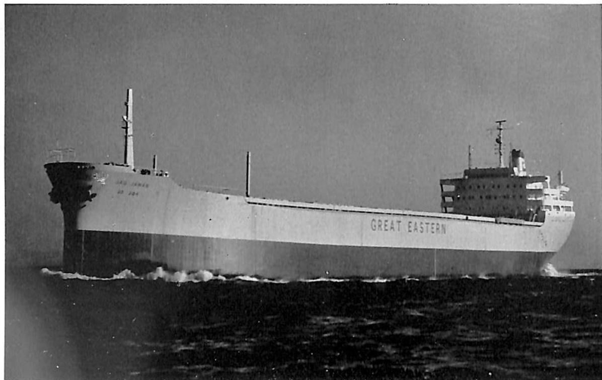
JAG JAWAN (ばら積貨物船) 船主 GREAT EASTERN SHIPPING CO. (インド) 造船所 日本钢管・鶴見造船所 長(垂) 185.00 m 幅(型) 28.00 m 深(型) 16.30 m 吃水 11.35 m 総噸数 23,500.00 噸 載貨重量 38,500.00 噸 速力 17.4 ノット 主機 佐世保 -Gotavov rken DM 850 /1,700 VGA 6 U 型ディーゼル機関1基 出力 13,200 PS×115 RPM 船級 LR 起工 40-9-8 進水 40-11-8 竣工 41-2-12
