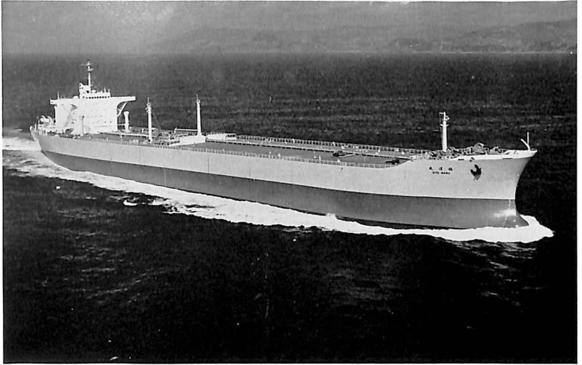
旺 洋 丸 (油槽船) 船主 大洋商船株式会社 造船所 佐世保重工・佐世保造船所 全長 247.50 m 長(垂) 237.00 m 幅(型) 36.50 m 深(型) 18.75 m 吃水 12.46 m 総噸数 46,269.51 噸 載貨重量 76,123.00 噸 速力 16.45 ノット 主機 三菱-スルザー 9 RD 90 型ディーゼル機関1基 出力(最大) 20,700 PS 船級 NK 起工 40-8-19 進水 40-11-9 竣工 41-2-15
