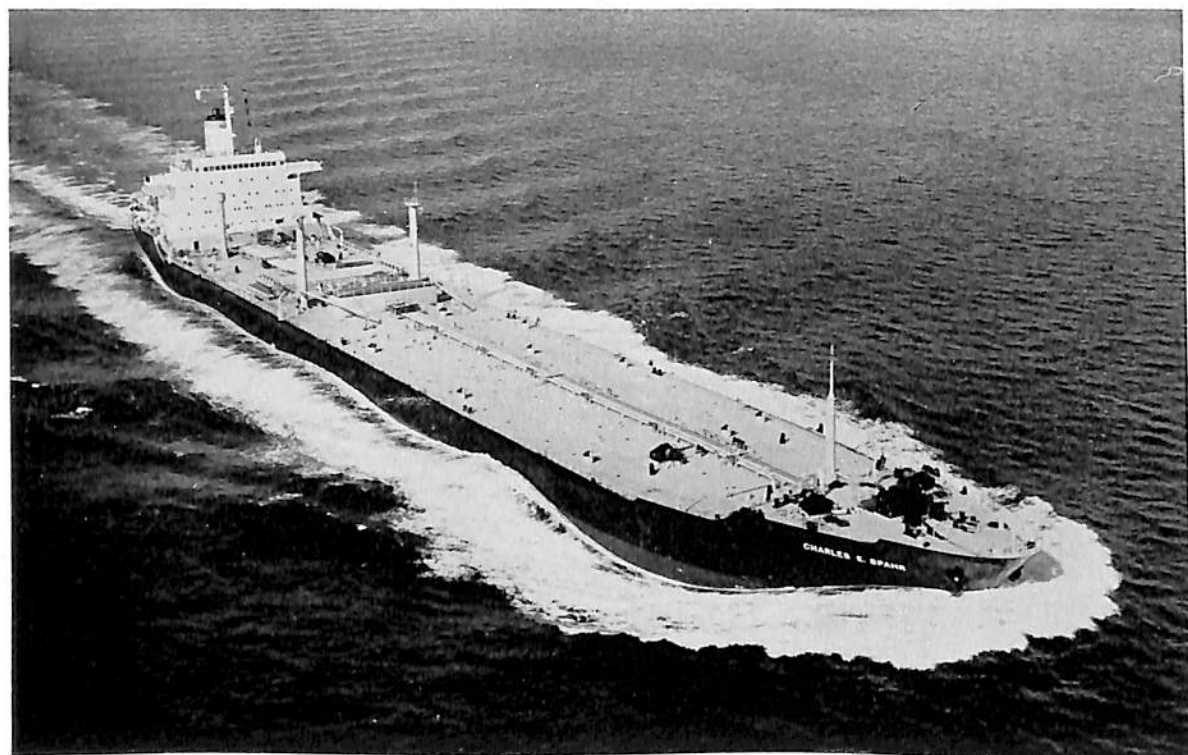
CHARLES E. SPAHR (油槽船) 船主 OSWEGO TANKER CORP. (リベリア) 造船所 三菱重工・長崎造船所 長(垂) 221.00 m 幅(型) 33.20 m 深(型) 16.60 m 吃水 12.20 m 総噸数 32,700.00 噸 載貨重量 61,000.00 噸 速力 17.1 ノット 主機 三菱船用蒸気タービンプラント 出力(最大) 22,000 PS 船級 AB 起工 40-7-31 進水 40-11-10 竣工 41-2-11
