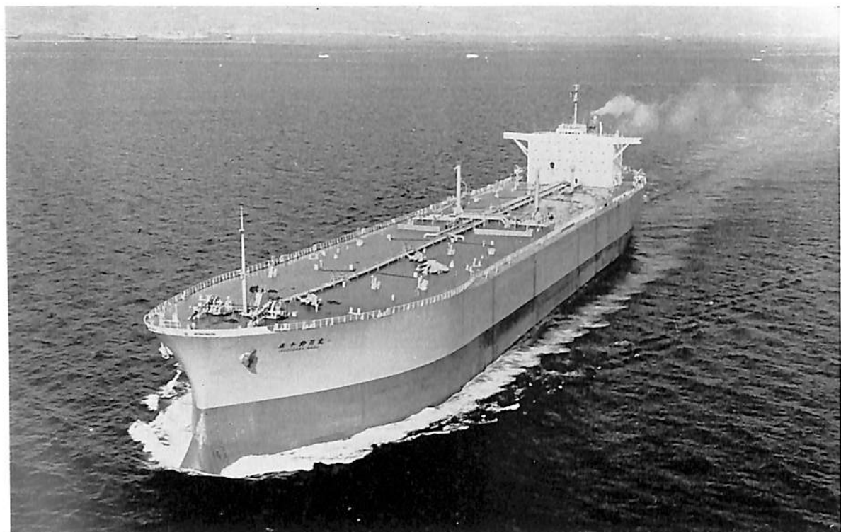
五十鈴丸 (油槽船) 船主 川崎汽船株式会社 造船所 川崎重工業株式会社 全長 273.75 m 長(垂) 260.00 m 幅(型) 42.00 m 深(型) 24.20 m 吃水 15.50 m 総噸数 74,433 噸 載貨重量 118,498 噸 速力 15.8 ノット 主機 川崎 MAN K 10 Z 90 /170 E 型 ディーゼル機 関 1 基 出力 22,100 PS×106 RPM 船級 NK 起工 40-5-15 進水 40-11-11 竣工 41-1-22
