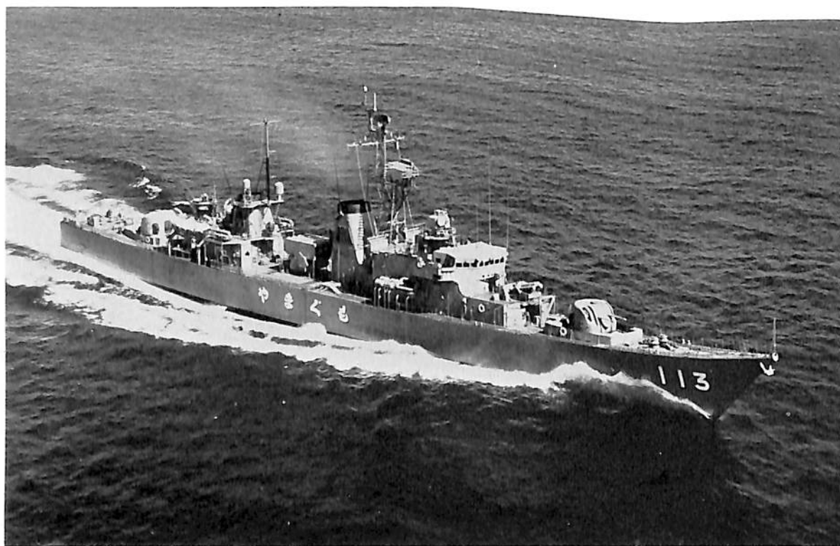
やまぐも (護衛艦, DDK) 船主 防衛庁 造船所 三井造船・玉野造船所 全長 114.00 m 最大幅 11.80 m 深 7.90 m 吃水 3.80 m 基準排水量 2,050.00 トン 推進軸数 2 速力 27.00 ノット 主機 三井 B&W ディーゼル機関 6 1軸当り 1628-V 3 BU-38 V 型 1 1228-V 3 BU-38 V 型 2 軸馬力 26,500 PS 乗員 25 名 起工 39-3-23 進水 40-2-27 竣工 41-1-29 主要兵器 50口径 3 インチ 連装速射砲 2 短魚雷発射管 (3 連装) 2 ポホース・ロケット ・ランチャー 1 アスロック・ランチャー 1
