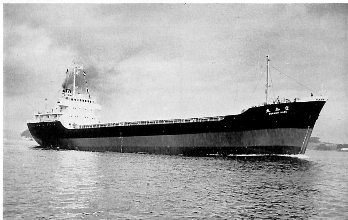
空 知 丸 (石炭専用船) 船主 北星海運株式会社 造船所 東北造船・塩釜造船所 長(垂) 94.00 m 幅(型) 14.70 m 深(型) 8.70 m 吃水 6.916 m 総噸数 3,367.24 噸 載貨重量 5,789.20 噸 速力 12.5 ノット 主機 ダイハツ 6 PSTb M-26 D-4 基 出力 2,600 PS× 225 RPM 船級 NK 起工 40-11-25 進水 40-12-9 竣工 41-2-14
