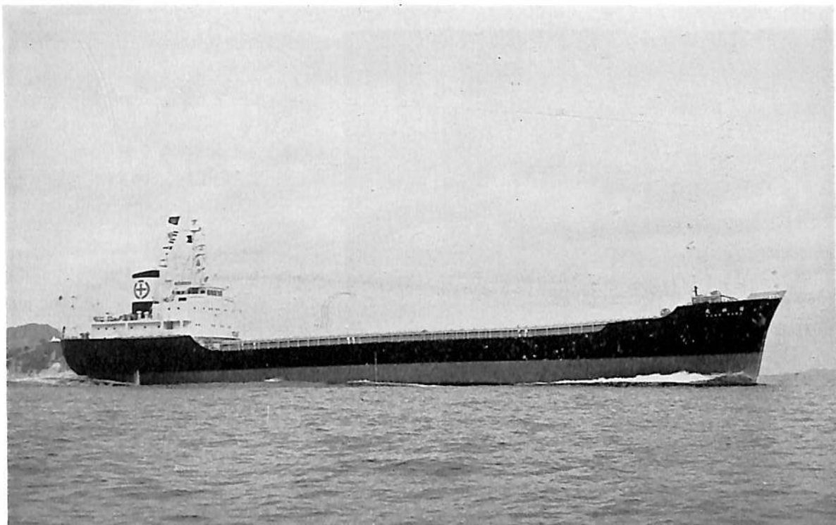
雄 鵬 丸 (石炭運搬船) 船主 特定船舶整備公団・八千代汽船株式会社 造船所 尾道造船株式会社 全長 105.75 m 長(垂) 98.25 m 幅(型) 14.80 m 深(型) 8.45 m 吃水 6.75 m 総噸数 3,522.18 噸 載貨重量 5,798.12 噸 速力 13.00 ノット 主機 三菱スルザー 2 サイクル 単動無気噴油過給機付ディーゼル機関 1 基 出力 2,805 PS×227.5 RPM 船級 NK 起工 40-11-25 進水 40-12-14 竣工 41-2-15
