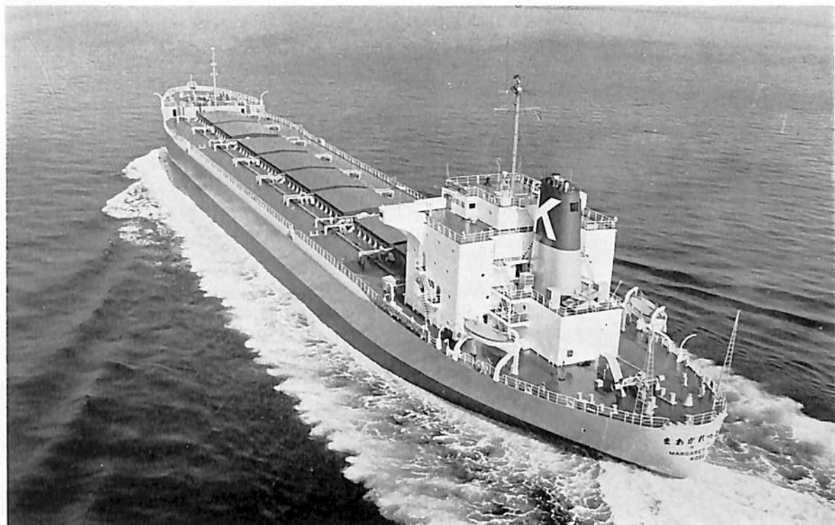
まあがれつと丸 (鉱石運搬船) 船主 川崎汽船株式会社 造船所 川崎重工業株式会社 全長 184.71 m 長(垂) 175.00 m 幅(型) 27.50 m 深(型) 13.30 m 吃水 8.964 m 総噸数 19,552 噸 載貨重量 28,552 噸 速力 15.5 ノット 主機 川崎 MAN K7Z 70/120 C 型ディーゼル 機関 1 基 出力 7,450 PS×128 RPM 船級 NK 起工 40-9-10 進水 40-12-8 竣工 41-2-10
