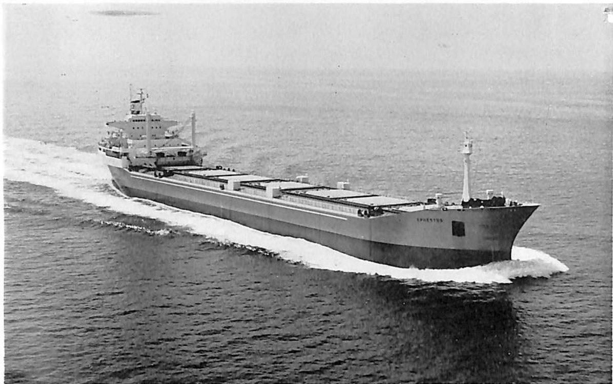
EPHESTOS (ばら積貨物船) 船主 VULCAN SHIPPING CO. (パナマ) 造船所 三井造船・千葉造船所 長(垂) 192.634 m 幅(型) 26.960 m 深(型) 14.783 m 吃水 10.134 m 総噸数 21,374.47 噸 載貨重量 35,234.00 噸 速力 15.86 ノット 主機 三井 B&W 684-VT 2 BF-180 型 ディーゼル機関 1 基 出力(最大) 13,800 PS×114 RPM 船級 AB 起工 40-7-29 進水 40-11-30 竣工 41-4-1
