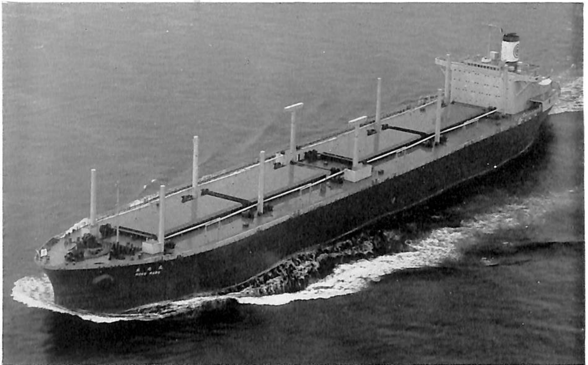
豊光丸 (鉾石運搬船) 船主 三光汽船株式会社 造船所 株式会社 大阪造船所 全長 215.40 m 長(垂) 205.00 m 幅(型) 31.00 m 深(型) 15.90 m 吃水 10.505 m 総噸数 30,001.39 噸 載貨重量 45,827.00 噸 速力(試) 16.362 ノット 主機 IHI-スルザー 8 RD 76 型ディーゼル機関 1 基 出力 12,800 PS×119 RPM 船級 NK 起工 40-8-25 進水 40-12-25 竣工 41-3-31
