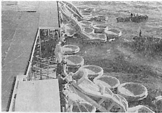
10 m 型シューターとゴムポート（海上に展開したところ）
