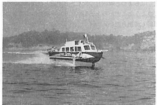
第8図 全没型翼実験艇の航走状況
