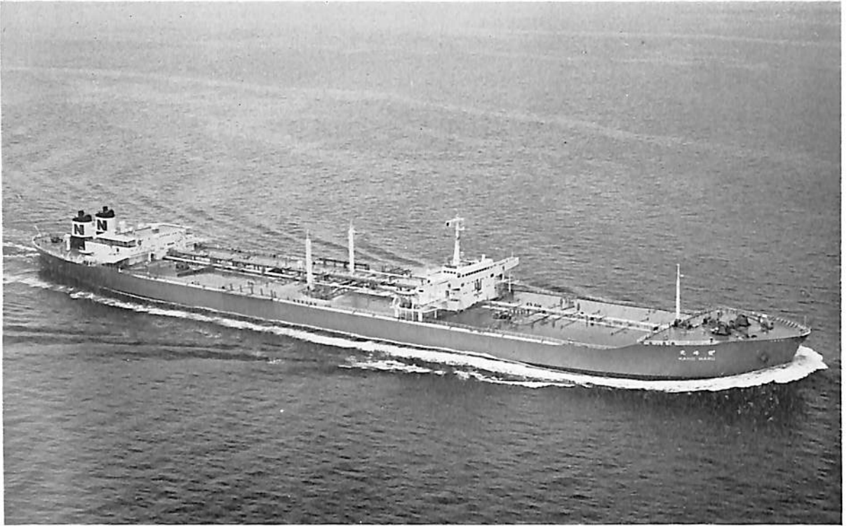
震 峰 丸 (油 槽 船) 船 主 日正汽船株式会社, 山下新日本汽船株式会社 造船所 日立造船・因島工場 全長 278.00 m 長(垂) 265.00 m 幅(型) 44.20 m 深(型) 21.50 m 吃水 15.00 m 総噸数 71,300 噸 載貨重量 119,300 噸 速力(試) 17.4 ノット 主機 日立 B&W 1284-VT 2 BF-180 型ディーゼル機関 1 基 出力(最大) 27,600 PS 船級 NK 起工 40 8-21 進水 41-2-23 竣工 41-5-25
