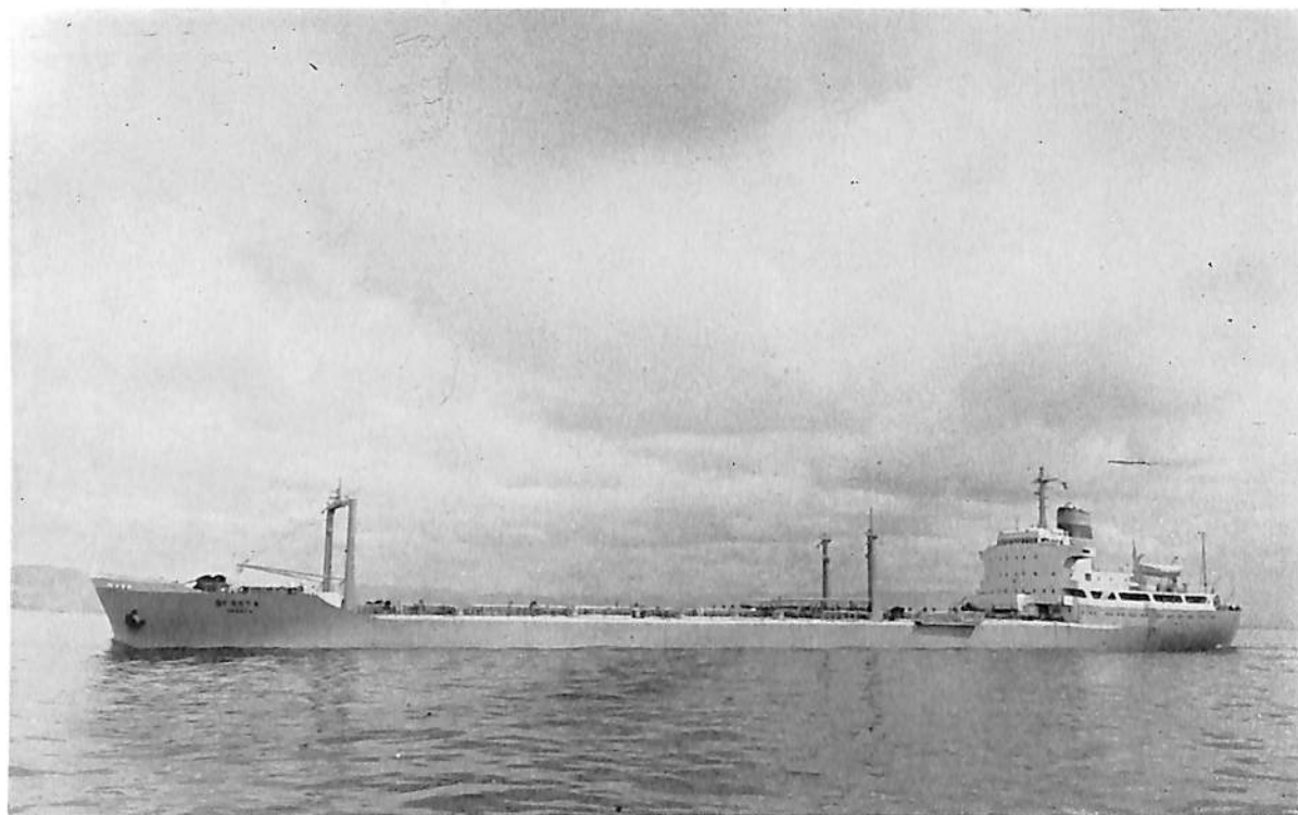
OGOSTA (油槽船) 船主 BULGATION CORP OF SHIPBUILDING & SHIPPING (ブルガリア) 造船所 株式会社 大阪造船所 長(垂) 166.00 m 幅(型) 24.00 m 深(型) 13.40 m 吃水 10.00 m 総噸数 15,856.50 噸 載貨重量 25,579.00 噸 速力(試) 15.679 ノット 主機 三井 B&W 762- VT 2 BF-140 型ディーゼル機関 1 基 出力 8,400 PS×139 RPM 船級 LR 起工 40-10-8 進水 41-2-3 竣工 41-4-30
