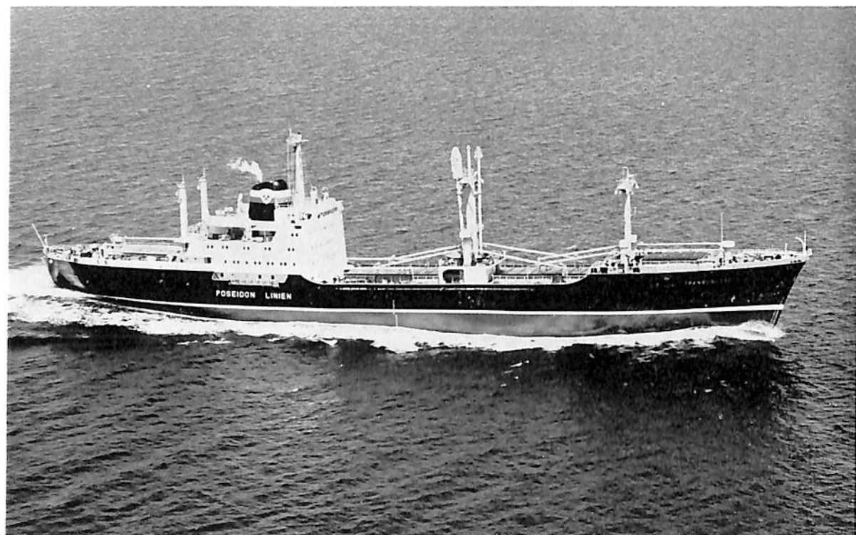
TRANSONTARIO (貨物船) 船主 POSEIDON SCHIFFFAHRT G. m. b. H. (西ドイツ) 造船所 三井造船・玉野造船所 長(垂) 120.00 m 幅(型) 17.60 m 深(型) 10.20 m 吃水 7.8845 m 総噸数 6,429.28 噸 載貨重量 7,945.00 噸 速力(試) 18.26 ノット 主機 三井 B&W 662-VT 2 BF-140 型ディーゼル機関 1 基 出力(最大) 7,200 PS×139 RPM 船級 GL 起工 40- 9-29 進水 41-1-13 竣工 41-4-20
