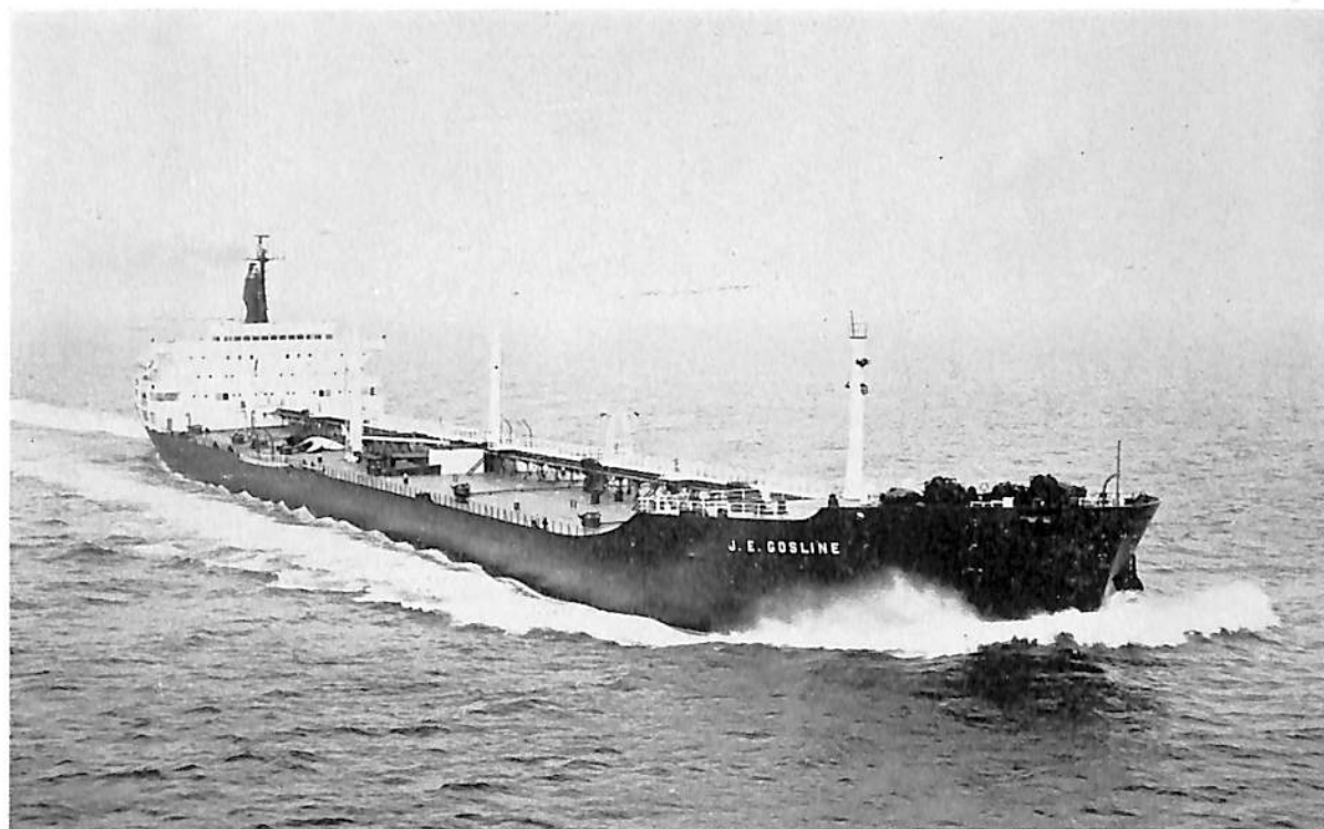
J. E. GOSLINE (油槽船) 船主 CHEVRON TRANSPORT CORP. (リベリア) 造船所 日立造船・因島工場 全長 239.00 m 長(垂) 230.00 m 幅(型) 31.84 m 深(型) 17.55 m 吃水 11.738 m 総噸数 33,672.00 噸 載貨重量 54,851.00 噸 速力(試) 17.414 ノット 主機 IHI-MST-13 型タービン 1 基 出力(最大) 19,250 PS×105.3 RPM 船級 AB 起工 40-8 -13 進水 40-10-21 竣工 41-4-12
