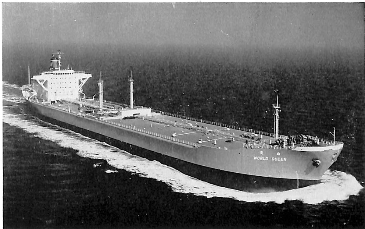
WORLD QUEEN (油槽船) 船主 THE RANK SHIPPING CO. (ホンコン) 造船所 三菱重工・広島造船所 長(垂) 226.00 m 幅(型) 34.84 m 深(型) 16.7 m 吃水 11.58 m 総噸数 40,432.70 噸 載貨重量 76,595.00 噸 速力 15.5 ノット 主機 三菱スルザー 8 RD 90 型デ ィーゼル機関 1 基 出力 18,400 PS 船級 LR, BV 起工 40-9-17 進水 40-12-15 竣工 40-3-22
