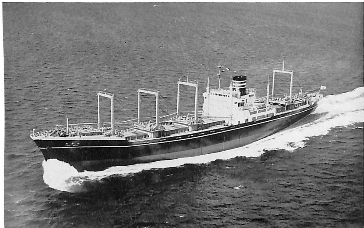
加賀丸 (貨物船) 船主 日本郵船株式会社 造船所 三菱重工・神戸造船所 長(垂) 160.0 m 幅(型) 23.0 m 深(型) 13.3 m 吃水 9.3 m 総噸数 11,930.39 噸 載貨重量 13,490.00 噸 速力(試) 24.63 ノット 主機 三菱 UEC 85/150 型ディーゼル機関 1 基 出力 18,400 PS 船級 NK 起工 40-10-1 進水 40-12-11 竣工 41-3-23
