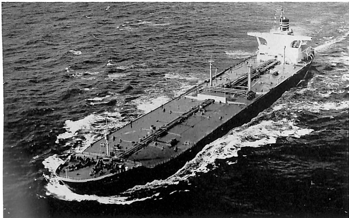
徳島丸 (油槽船) 船主 日本郵船株式会社 造船所 三菱重工・長崎造船所 長(垂) 256.0 m 幅(型) 42.5 m 深(型) 28.0 m 吃水 15.6 m 総噸数 67,653.00 噸 載貨重量 123,989.00 噸 速力 16.05 ノット 主機 MTP タービン 出力 24,000 PS 船級 NK 起工 40-9-10 進水 40 12-28 竣工 41-4-25
