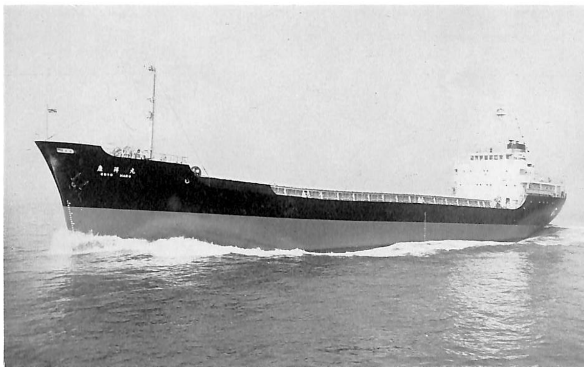
康 洋 丸 (石灰運搬船) 船主 特定船舶整備公団, 太平洋船舶株式会社 造船所 株式会社 藤永田造船所 全長 103.60 m 長(垂) 96.00 m 幅(型) 14.80 m 深(型) 8.35 m 吃水 6.684 m 総噸数 3,353.75 噸 速力 12.7 ノット 主機 三菱神戸 6 UD 45 型ディーゼル機関 1 基 出力 2,800 PS×227 RPM 船級 NK 起工 40-12-1 進水 41-2-23 竣工 41-4-28
