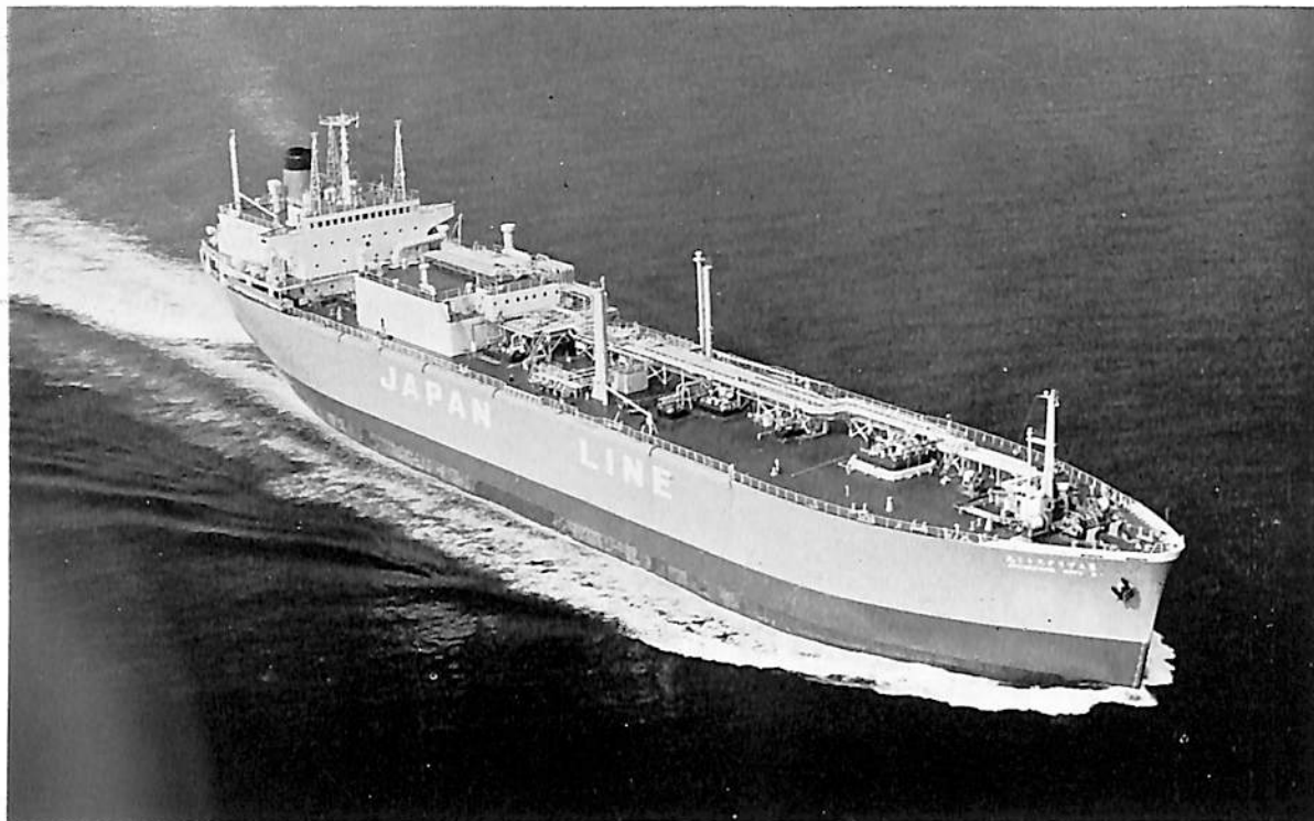
オミプリヂストン丸 (LPG タンカー) 船主 ジャパンライン株式会社 造船所 石川島播磨重工・名古屋工場 長(垂) 180.00 m 幅(型) 29.00 m 深(型) 18.00 m 吃水 9.60 m 総噸数 約 27,500 噸 載貨重量 約 33,800 噸 速力 15.0 ノット 主機 IHI スルザー7 RD 76 型ディーゼル機関 1 基 出力 11,200 PS 船級 NK 起工 40-7-7 進水 40-12-25 竣工 41-5-14
