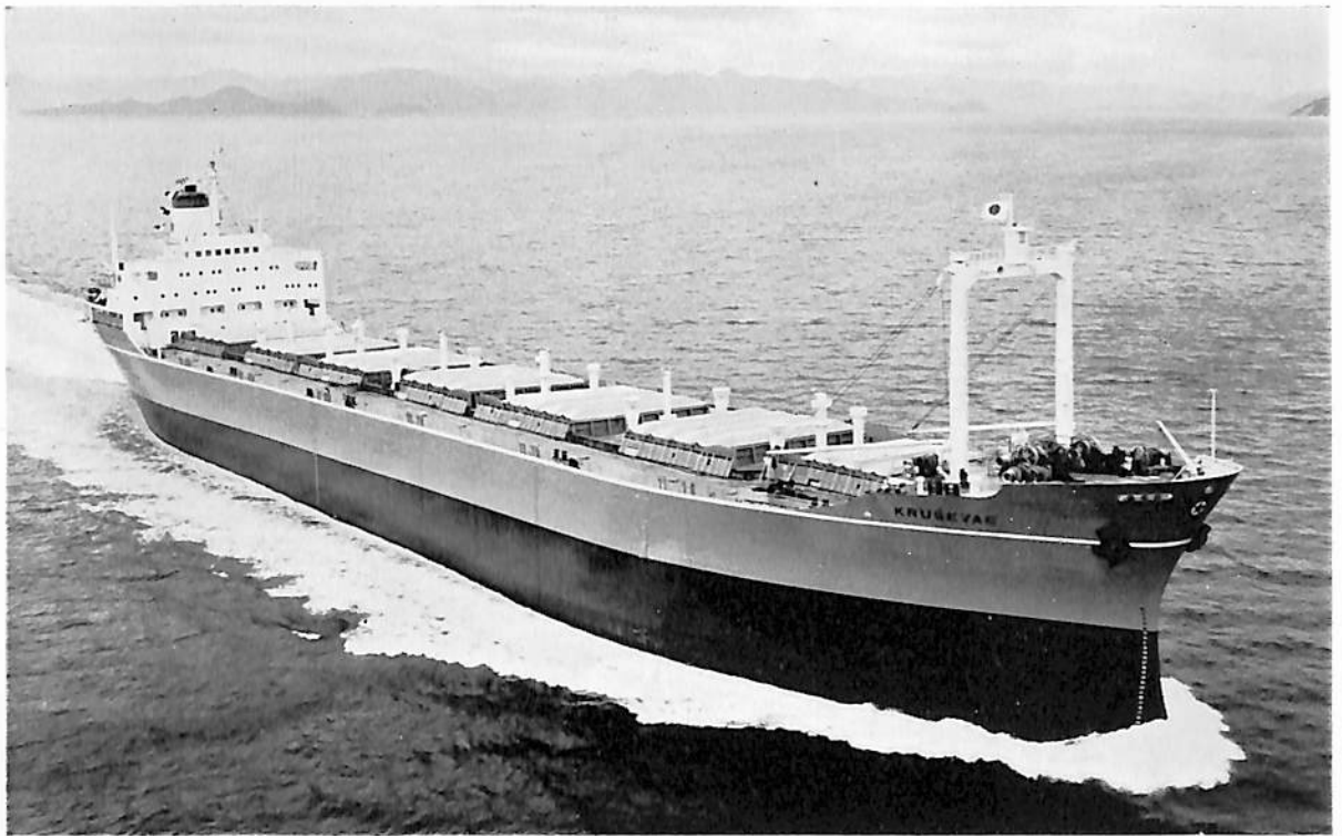
KRUSEVAC (ばら積貨物船) 船主 JUGOSLAVENSKA OCEANSKA PLOVIDBA (ユーゴスラビア) 造船所 株式会社 呉造船所 全長 199.50 m 長(垂) 188.00 m 幅(型) 27.50 m 深(型) 15.50 m 吃水 10.65 m 総噸数 23,243.41 噸 載貨重量 35,515.00 噸 載貨容積 50,585.51 m 3 速力 15.1 ノット 主機 IHI スルザーディーゼル機関 1 基 出力 12,000 PS 船級 LR 起工 40-11-15 進水 41-2-21 竣工 41-5-31
