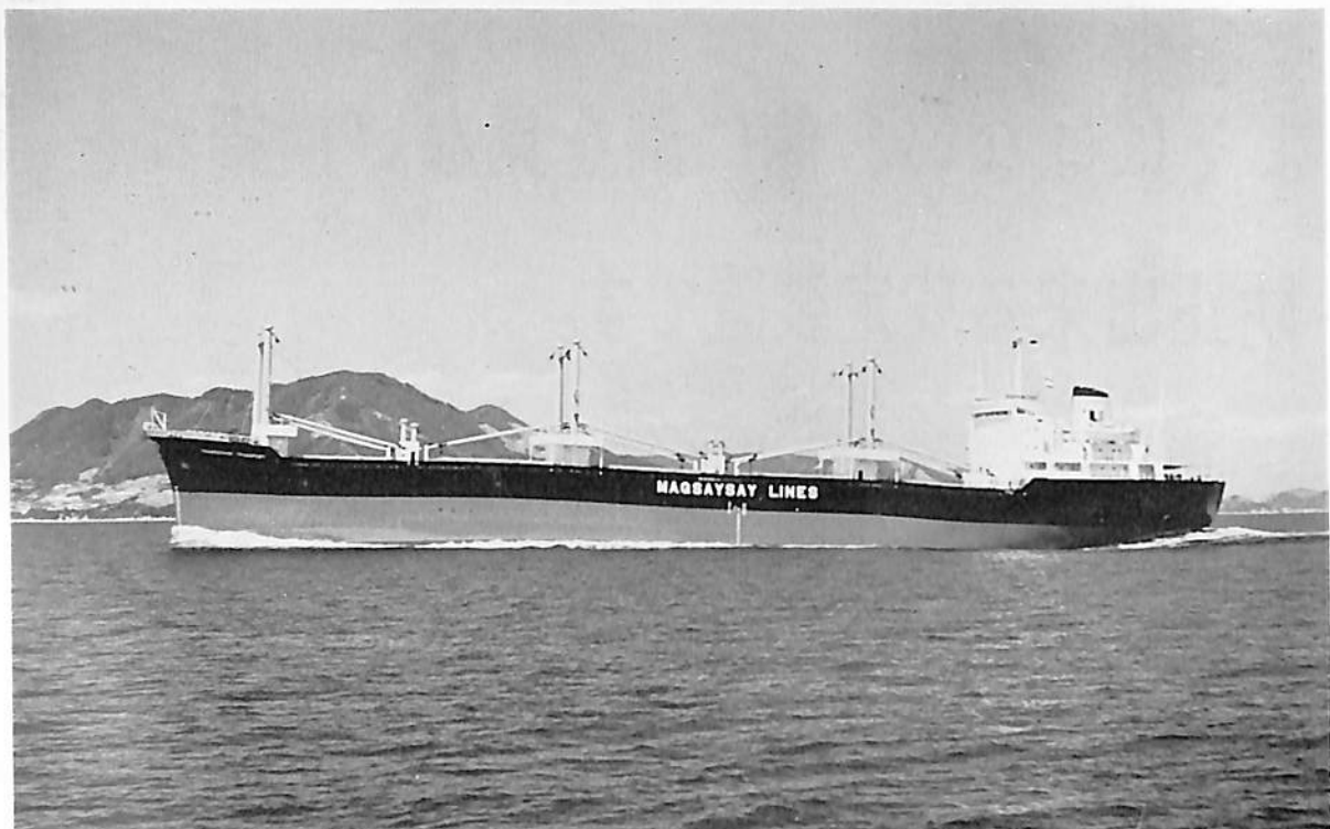
TRANSOCEAN TRANSPORT (ばら積貨物船) 船主 フィリッピン共和国政府 造船所 日立造船・向島工場 全長 153.00 m 長(垂) 146.00 m 幅(型) 22.60 m 吃水 9.307 m 総噸数 11,290.29 噸 載貨重量 18,990.00 噸 貨物倉(ベール) 23,490 m 3 (グレーン) 24,156 m 3 速力 15.2 ノット 主機 日立 B&W 762-VT 2 BF-140 型ディーゼル機関 1 基 出力 7,650 PS×135 RPM 乗組員 50 名 船級 AB 起工 40-5-12 進水 41-1-29 竣工 41-5-31
