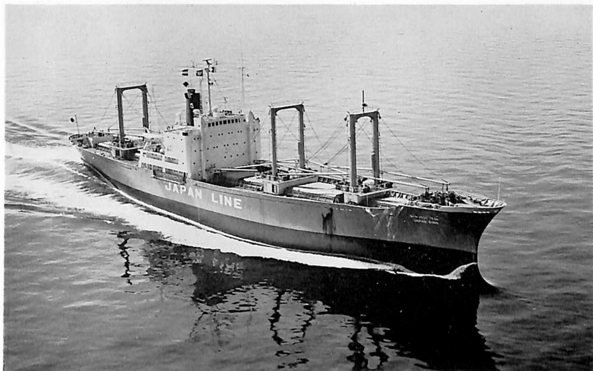
ジャパン リム (貨物船) 船主 ジャパンライン株式会社 造船所 石川島播磨重工・相生工場 長(垂) 130.00 m 幅(型) 19.20 m 深(型) 11.50 m 吃水 8.50 m 総噸数 約 7,200 噸 載貨重量 約 9,400 噸 速力 16.2 ノット 主機 IHI スルザー 6 RD 68 型ディーゼル機関 1 基 出力 7,200 PS 船級 NK 起工 40-9-17 進水 41-2-21 竣工 41-4-30
