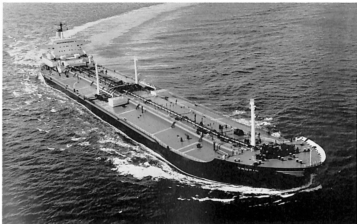
TROPIC (油槽船) 船主 CLIPPER SHIPPING CO. (パナマ) 造船所 石川島播磨重工・相生工場 長(垂) 251.60 m 幅(型) 37.85 m 深(型) 17.50 m 吃水 11.50 m 総噸数 約 50,000 噸 載貨重量 約 70,000 噸 速力 16.0 ノット 主機 IHP スルザー 9 RD 90 型ディーゼル機関 1 基 出力 20,300 PS 船級 AB 起工 40-12-29 進水 41-3-1 竣工 40-6-30
