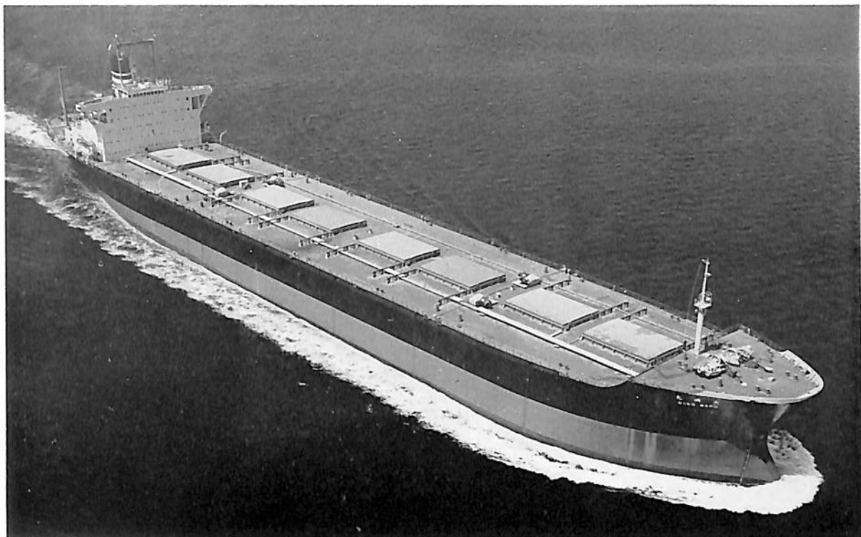
大 磯 丸 (鉾石運搬船) 船主 日本郵船株式会社 造船所 三菱重工・広島造船所 長(垂) 216.00 m 幅(型) 35.7 m 深(型) 18.7 m 吃水 12.58 m 総噸数 42,000.00 噸 載貨重量 68,350.00 噸 速力 14.9 ノット 主機 三菱スルザー6RD90型ディーゼル機関1基 出力 15,000 PS 船級 NK 起工 40-10-15 進水 41-4-5 竣工 41-6-30
