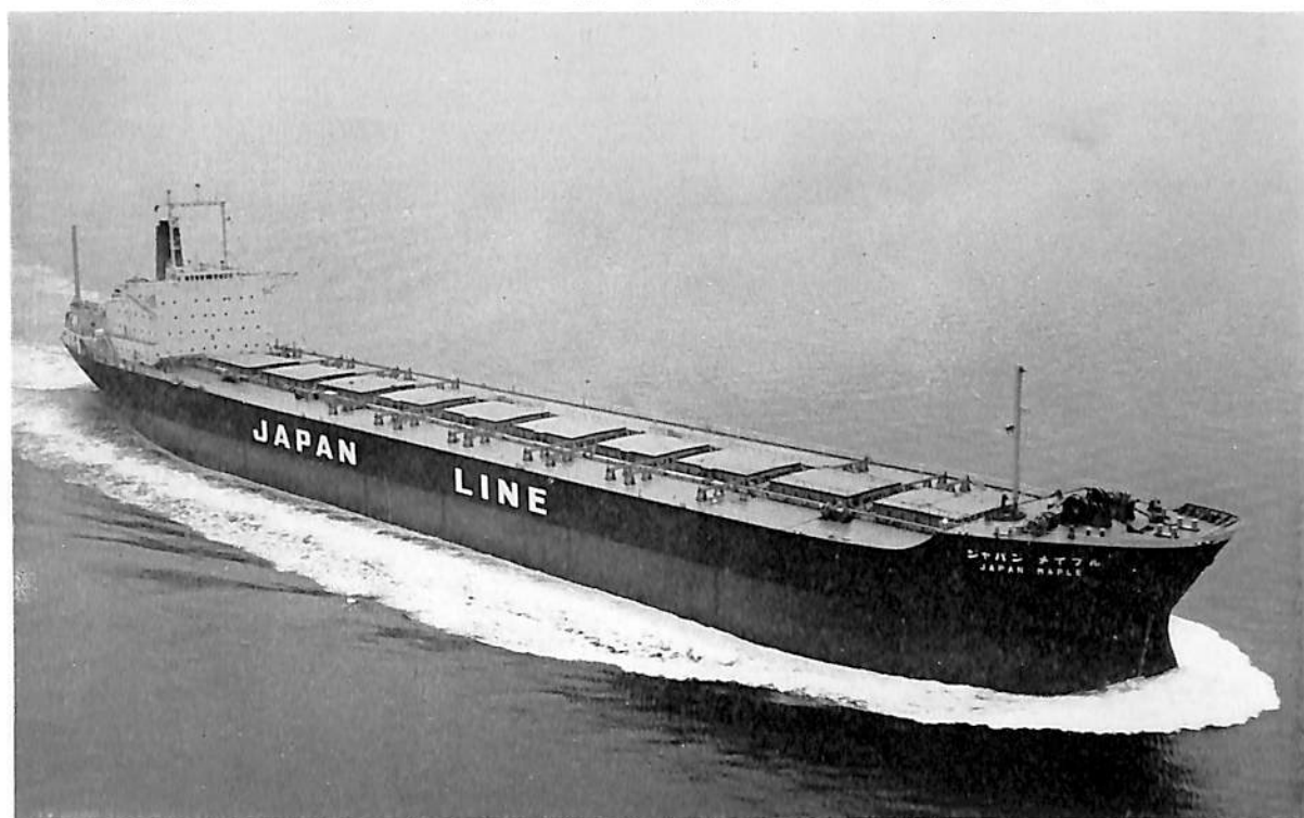
ジャパン メイプル (鉾石運搬船) 船主 ジャパンライン株式会社 造船所 三菱重工・広島造船所 長(垂) 211.0 m 幅(型) 31.8 m 深(型) 17.5 m 吃水 11.75 m 総噸数 34,518.60 噸 載貨重量 56,565.00 噸 速力 15.05 ノット 主機 三菱スルザー6RD90型ディーゼル機関1基 出力 15,000 PS 船級 NK 起工 40-9-24 進水 41-2-19 竣工 41-5-14
