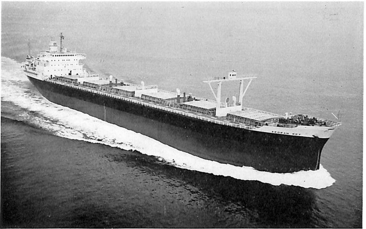
AEGEANSKY (ばら積貨物船) 船主 PACIFIC CARRIERES, S. A. (パナマ) 造船所 三菱重工・広島造船所 長(垂) 183.06 m 幅(型) 28.00 m 深(型) 16.10 m 吃水 11.80 m 総噸数 23,400.00 噸 載貨重量 36,140.00 噸 速力 17.6 ノット 主機 三菱スルザー 6 RD 90 型ディーゼル機関 1 基 出力 13,800 PS 船級 LR 起工 40-9-20 進水 41-1-26 竣工 41-7-15
