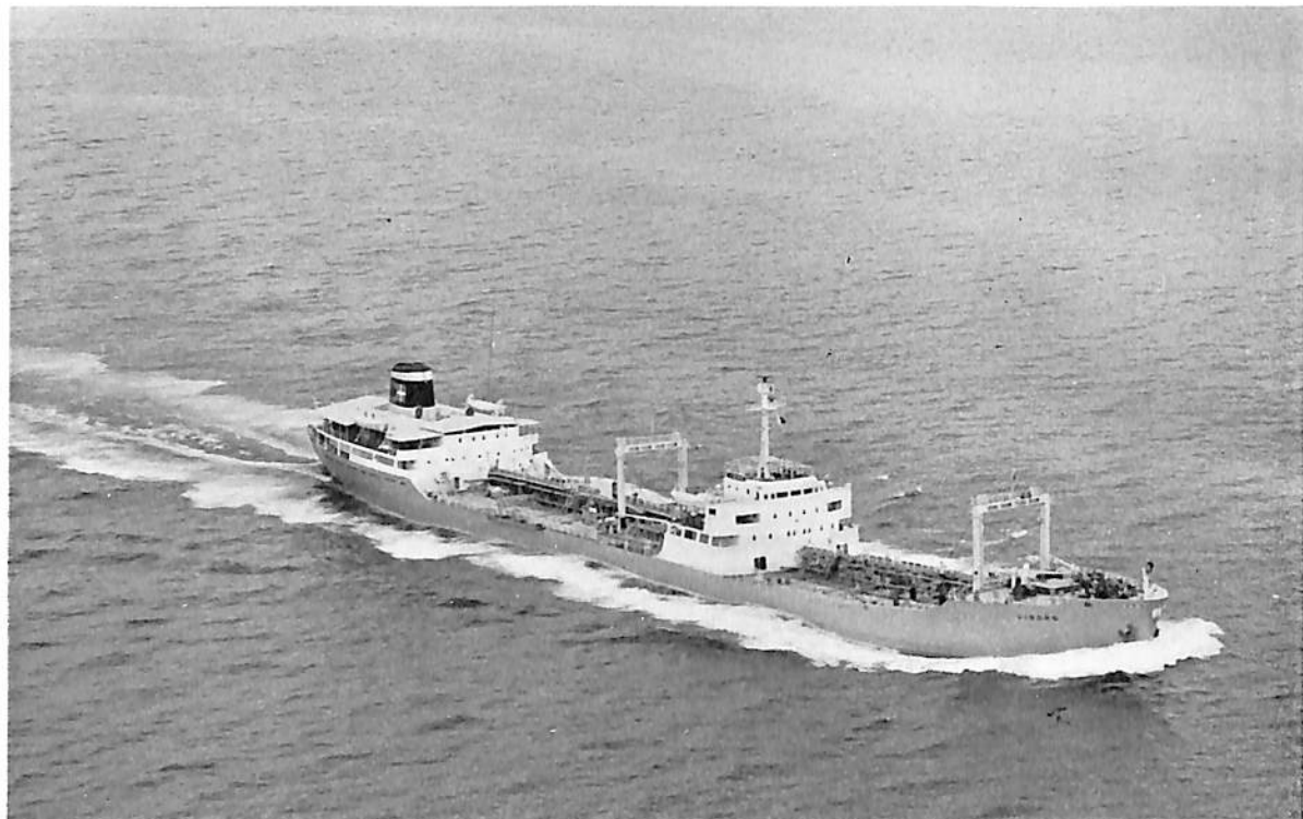
VIBORG (ケミカル タンカー) 船主 DANNEBROG STEAMSHIP CO. (デンマーク) 造船所 日立造船・堺工場 全長 170.68 m 長(垂) 163.00 m 幅(型) 22.00 m 深(型) 11.70 m 吃水 9.052 m 総噸数 12,400 噸 載貨重量 19,441 噸 貨物艙容積 24,683 m 3 速力 15.0 ノット 主機 日立 B&W 674-VTBF-160 型ディーゼル機関 1 基 出力 7,500 PS 乗組員 53 名 船級 LR 起工 40-12-20 進水 41-4-4 竣工 41-6-30
