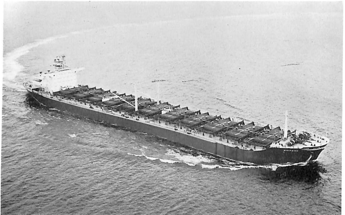
SIGTONE (油兼ばら積貨物船) 船主 TRIPPLE OCEAN OPERATION (リベリア) 造船所 株式会社 呉造船所 全長 250.00 m 長(垂) 240.00 m 幅(型) 39.00 m 深(型) 19.00 m 吃水 12.52 m 総噸数 43,500 噸 載貨重量 78,384 噸 速力 15.92 ノット 主機 IHI-スルザー 9 RD 90 型ディーゼル機関 1 基 出力(最大) 21,600 PS 船級 NV 起工 40-12-11 進水 41-3-10 竣工 41-6-28
