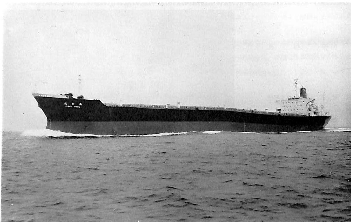
紀州丸 (石炭運搬船) 船主 大阪商船三井船舶株式会社 造船所 三菱重工・神戸造船所 長(垂) 211.00 m 幅(型) 31.8 m 深(型) 17.5 m 吃水 11.5 m 総噸数 33,170.86 噸 載貨重量 54,197.00 噸 速力 15.8 ノット 主機 三菱スルザー 8RD90 型ディーゼル機関 1 基 出力 18,400 PS 船級 NK 起工 40-10-21 進水 41-3-16 竣工 41-5-23
