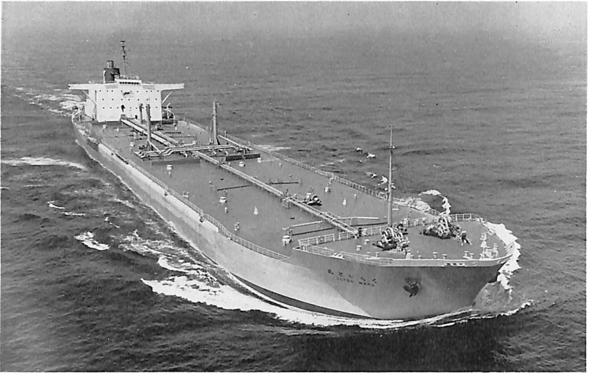
くらいど丸 (油槽船) 船主 川崎汽船株式会社 造船所 川崎重工工業株式会社 全長 245.97 m 長(垂) 235.00 m 幅(型) 38.30 m 深(型) 17.70 m 吃水 12.497 m 総噸数 45,161.95 噸 載貨重量 78,648.00 噸 貨物油倉 99,539.4 m 3 速力 16.28 ノット 主機 川崎 MAN ディーゼル機関 1 基 出力 16,300 PS×110 RPM 船級 NK 乗組員 38 名 起工 41-4-4 進水 41-5-20 竣工 41 7-30
