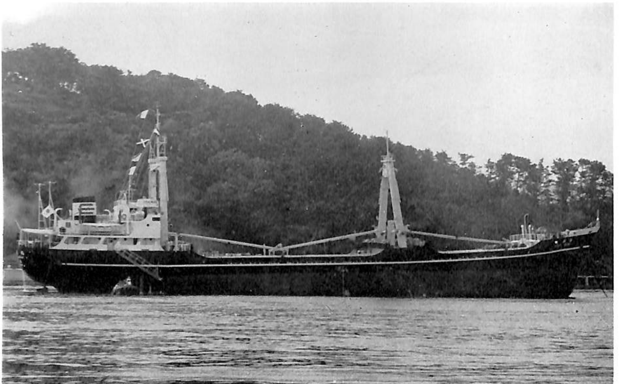
永洲丸 (貨物船) 船主 永和海運株式会社 造船所 新山本造船・高知造船所 全長 89.10 m 長(垂) 82.00 m 幅(型) 13.00 m 深(型) 6.60 m 吃水 5.668 m 総噸数 1,992.65 噸 載貨重量 3,313.00 噸 貨物容積(グレーン) 4,332.40 m 3 (ベール) 4,081.08 m 3 速力 12.0 ノット 主機 阪神内燃機製 Z 6 JSH 型ディーゼル機関 1 基 出力 1,785 PS×251 RPM 船級 NK 乗組員数 26 名 起工 41-5-15 進水 41-6-5 竣工 41-7-13
