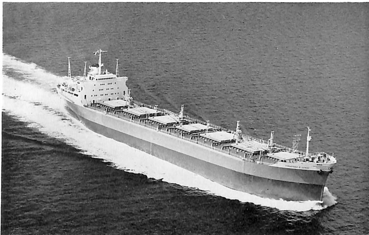
KYRIAKOULA D. LEMOS (ばら積兼鉱石運搬船) 船主 CAPETANDIAMANTIS COMPANIA MARITIMA (パナマ) 造船所 日立造船・因島工場 全長 194.00 m 長(垂) 184.00 m 幅(型) 28.20 m 深(型) 16.00 m 吃水 11.80 m 総噸数 20,516.42 噸 載貨重量 41,003.00 噸 貨物倉容積(アッパーウイングタンクを含む) 44,705.8 m 3 速力(試運転最大) 18.197 ノット 主機 日立 B&W 874-VT 2 BF-160 型ディーゼル機関 1 基 出力 13,200 PS 船級 LR 起工 41-4-4 進水 41-6-15 竣工 41-9-2
