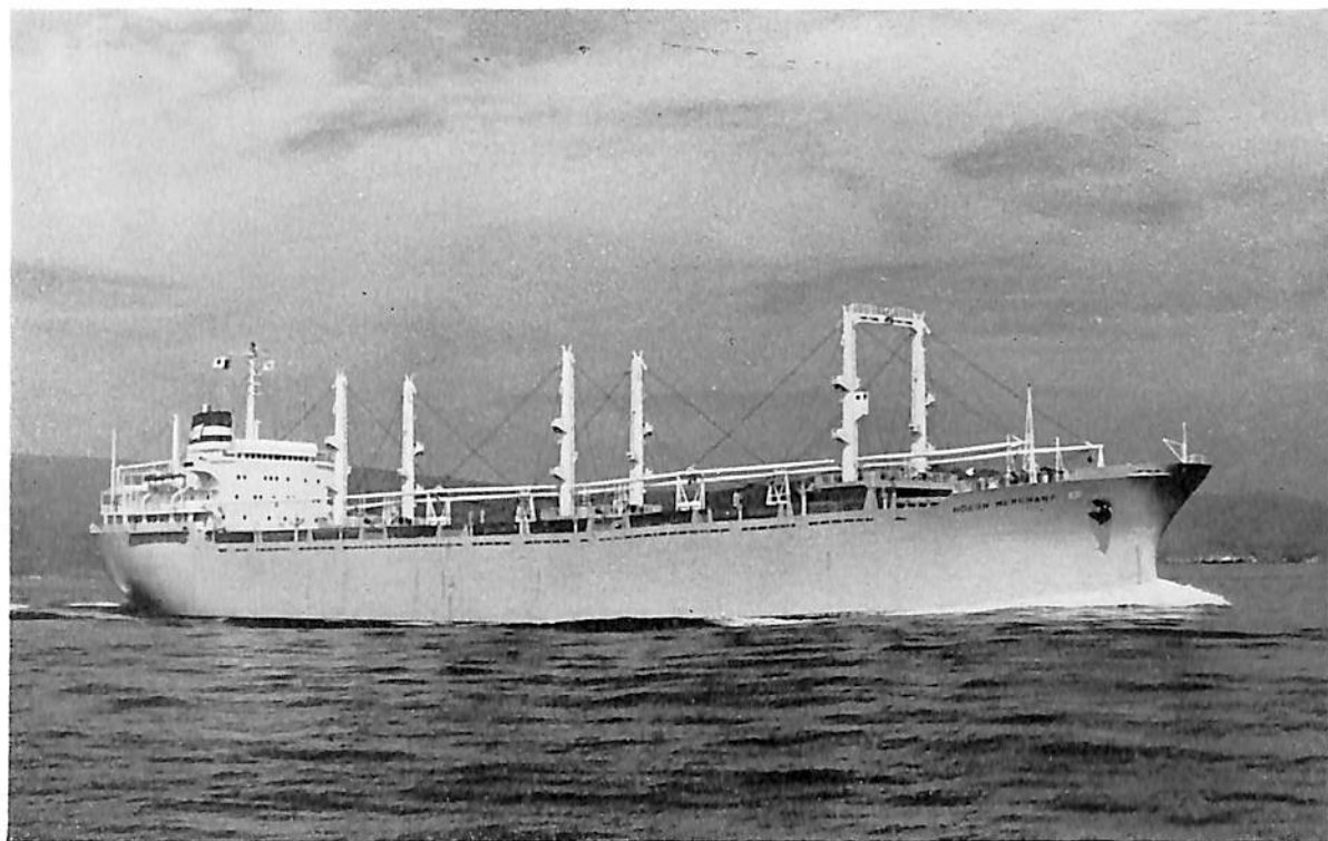
HøEGH MERCHANT (ばら積兼自動車運搬船) 船主 A/S ALLIANCE, BORRE (ノルウェー) 造船所 函館ドック株式会社 全長 178.50 m 長(垂) 171.79 m 幅(型) 22.80 m 深(型) 14.10 m 吃水 9.708 m 総噸数 16,464.45 噸 載貨重量 22,924.00 噸 車輛搭載数 1,668 台 貨物倉容積(ベール) 27,589 m 3 (グリーン) 28,964 m 3 速力 15.1 ノット 主機 川崎 MAN ディー ゼル機関 1 基 出力 9,450 PS×116 RPM 船級 NV 乗組員 41 名 起工 41-2-22 進水 41-6-10 竣工 41-8-29
