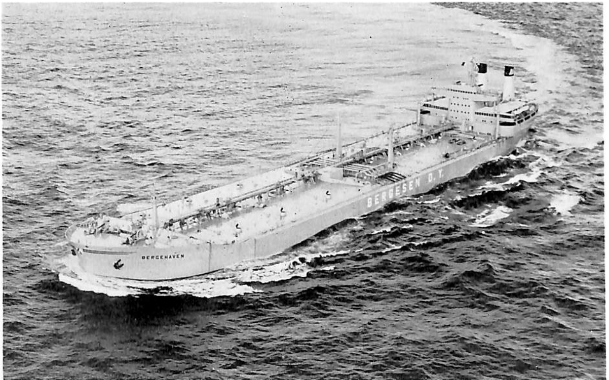
BERGEHAVEN (油槽船) 船主 Sig・BERGESEN d.y. (ノルウェー) 造船所 日立造船・堺工場 全長 279.00 m 長(垂) 265.00 m 幅(型) 44.20 m 深(型) 23.00 m 吃水 15.00 m 総噸数 78,784 噸 載貨重量 119,872 噸 速力 15.8 ノット 主機 日立 B&W 1284-VT 2 BF-180 型デ ーゼル機関 1 基 出力 27,600 PS 船級 NV 起工 40-9-6 進水 41-6-2 竣工 41-8-28
