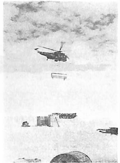
⑪ 20 kl 軽油タンクの スリング輸送
