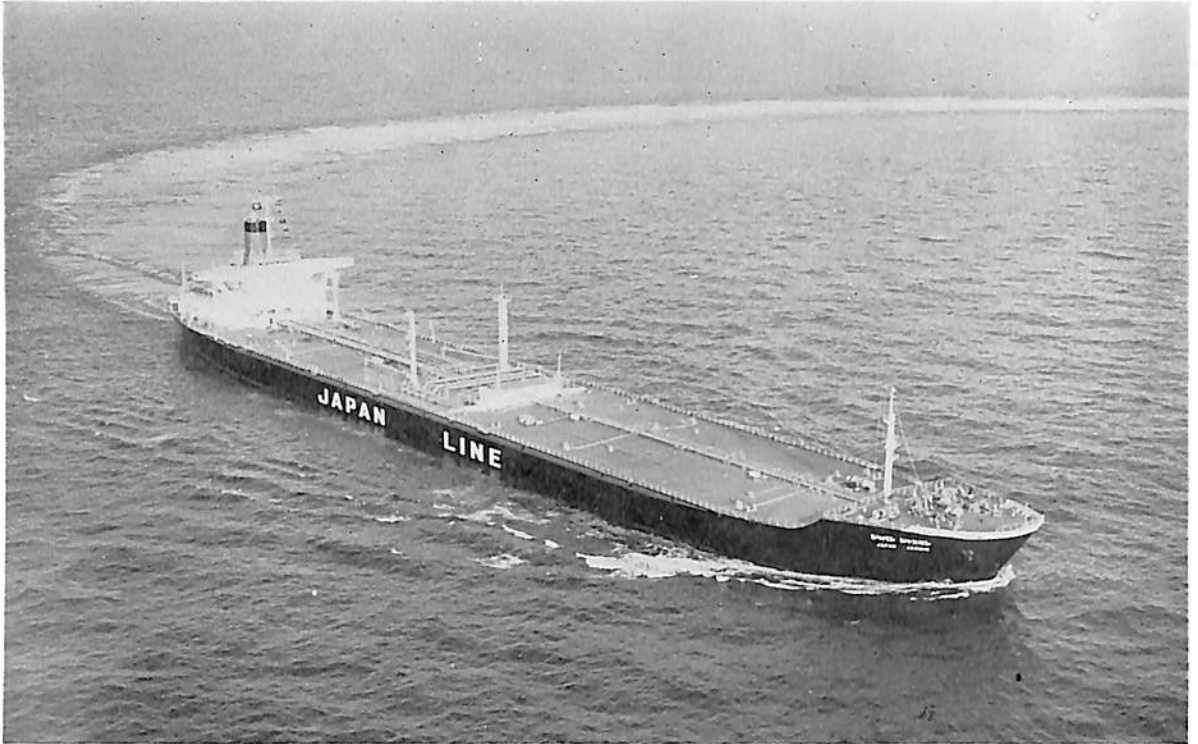
ジャパン ジャスミン (油槽船) 船主 ジャパンライン株式会社 造船所 三菱重工・長崎造船所 長(垂) 256.00 m 幅(型) 42.50 m 深(型) 22.00 m 吃水 15.80 m 総噸数 67,484.18 噸 載貨重量 123,886.00 噸 速力 16.05 ノット 主機 M.T.P 出力 24,000 PS 船級 NK 起工 41-11-19 進水 41-3-15 竣工 41-8-30
