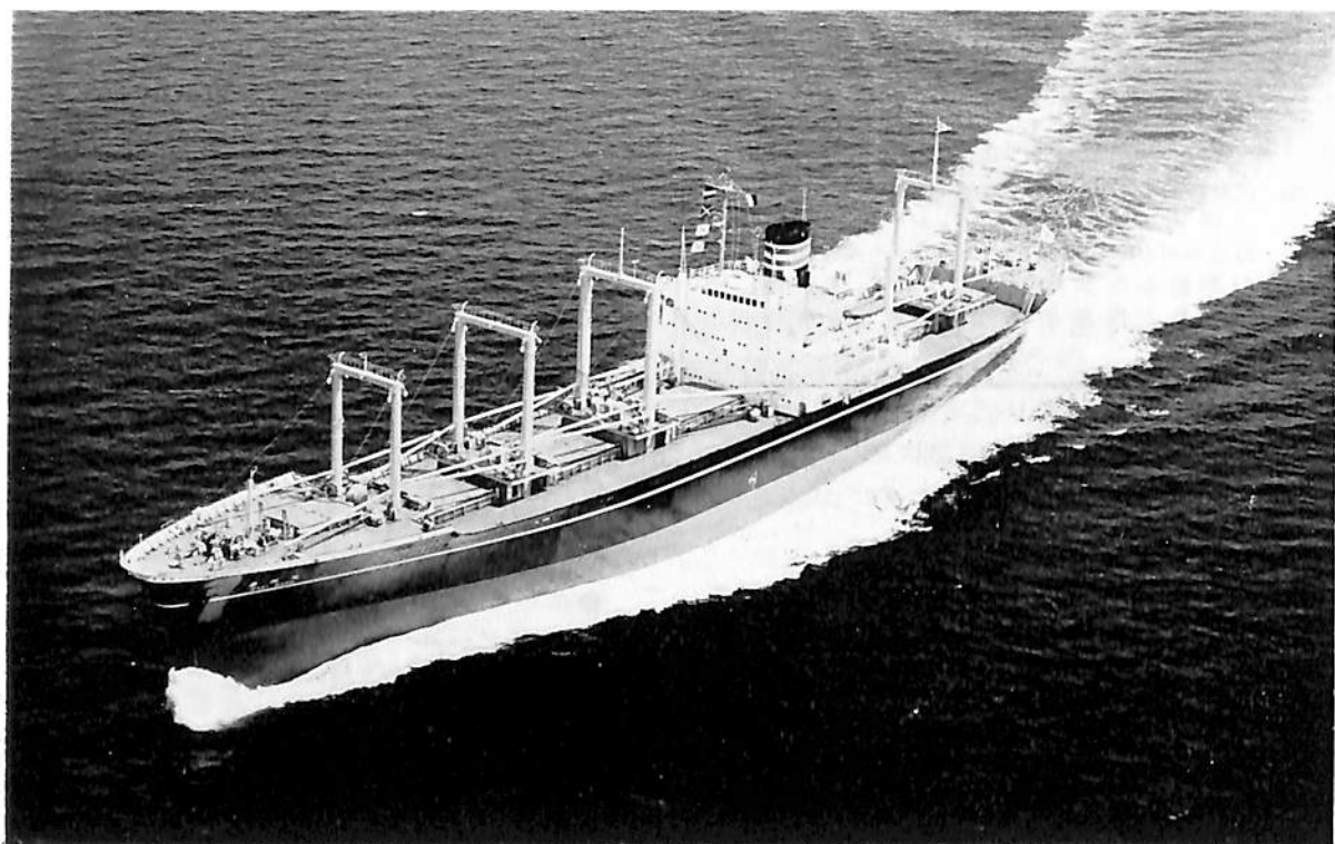
磐城丸 (貨物船) 船主 日本郵船株式会社 造船所 日立造船・向島工場 全長 157.00 m 長(垂) 146.00 m 幅(型) 22.00 m 深(型) 13.35 m 吃水 9.47 m 総噸数 10,497.4 噸 載貨重量 12,716.0 噸 貨物倉容積(グリーン) 21,815.1 m 3 (ベール) 20,039.2 m 3 速力(連続最大) 21.5 ノット 主機 日立 B&W 774-VT 2 BF-160 型ディーゼル機関 1 基 出力 10,500 PS 船級 NK 乗組員 40 名 起工 41-4-20 進水 41-6-21 竣工 41-9-19
