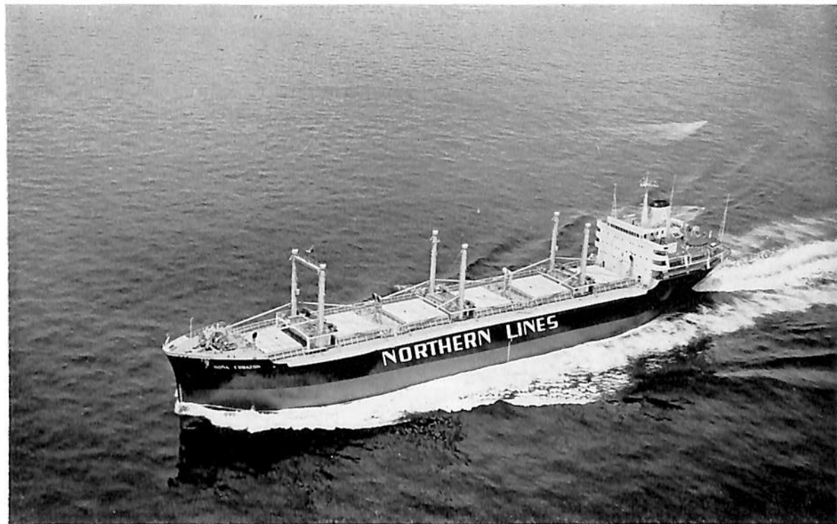
DONA CORAZON (ばら積貨物船) 船主 NORTHERN LINES INC. (フィリッピン) 造船所 株式会社 名村造船所 全長 154.98 m 長(垂) 146.00 m 幅(型) 22.60 m 深(型) 12.90 m 吃水 9.17 m 総噸数 12,139.71 噸 載貨重量 18,449.00 噸 貨物倉容積(グリーン) 24,519.43 m 3 速力(試運転最大) 17.621 ノット 主機 三井 B&W 762 VT 2 BF-140 型ディーゼル機関 1 基 出力 6,720 PS×129 RPM 船級 AB 乗組員 45 名 起工 41-1-29 進水 41-5-24 竣工 41-8-11
