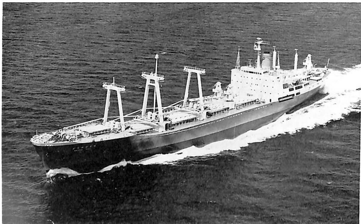
ふりすとる丸 (貨物船) 船主 大阪商船三井船舶株式会社 造船所 三井造船・玉野造船所 長(垂) 159.00 m 幅(型) 23.20 m 深(型) 12.90 m 吃水 9.00 m 総噸数 11,598.37 m 載貨重量 12,530.00 噸 貨物倉容積 一般貨物倉 20,706.3 m 3 冷凍貨物倉 648.6 m 3 ストロングルーム 301.5 m 3 メールルーム 140.0 m 3 特殊貨物倉 272.1 m 3 速力 20.47 ノット 主機 三井 B&W 884- VT 2 BF-180 型ディーゼル機関 1 基 出力 18,400 PS × 114 RPM 乗組員 44 名 船級 NK 起工 41-1-26 進水 41-6-15 竣工 41-9-18
