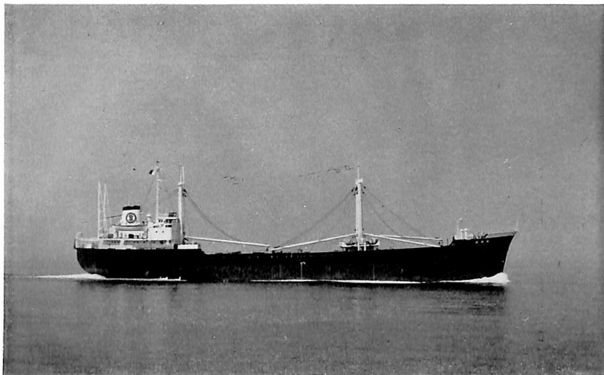
昭 宝 丸 (貨物船) 船主 三宝海運株式会社 造船所 株式会社 来島船渠 全長 98.38 m 長(垂) 91.00 m 幅(型) 15.20 m 深(型) 7.50 m 吃水 6.25 m 総噸数 2,981.55 噸 載貨重量 4,965.64 噸 貨物倉容積 (ベール) 5,997.52 m 3 (グレーン) 6,379.46 m 3 速力 11.5 ノット 主機 赤阪鉄工製 KD 7 SS 型 ディーゼル機関 1 基 出力 2,040 PS × 237 RPM 船級 NK 起工 41-3-27 進水 41-6-19 竣工 41-8-20
