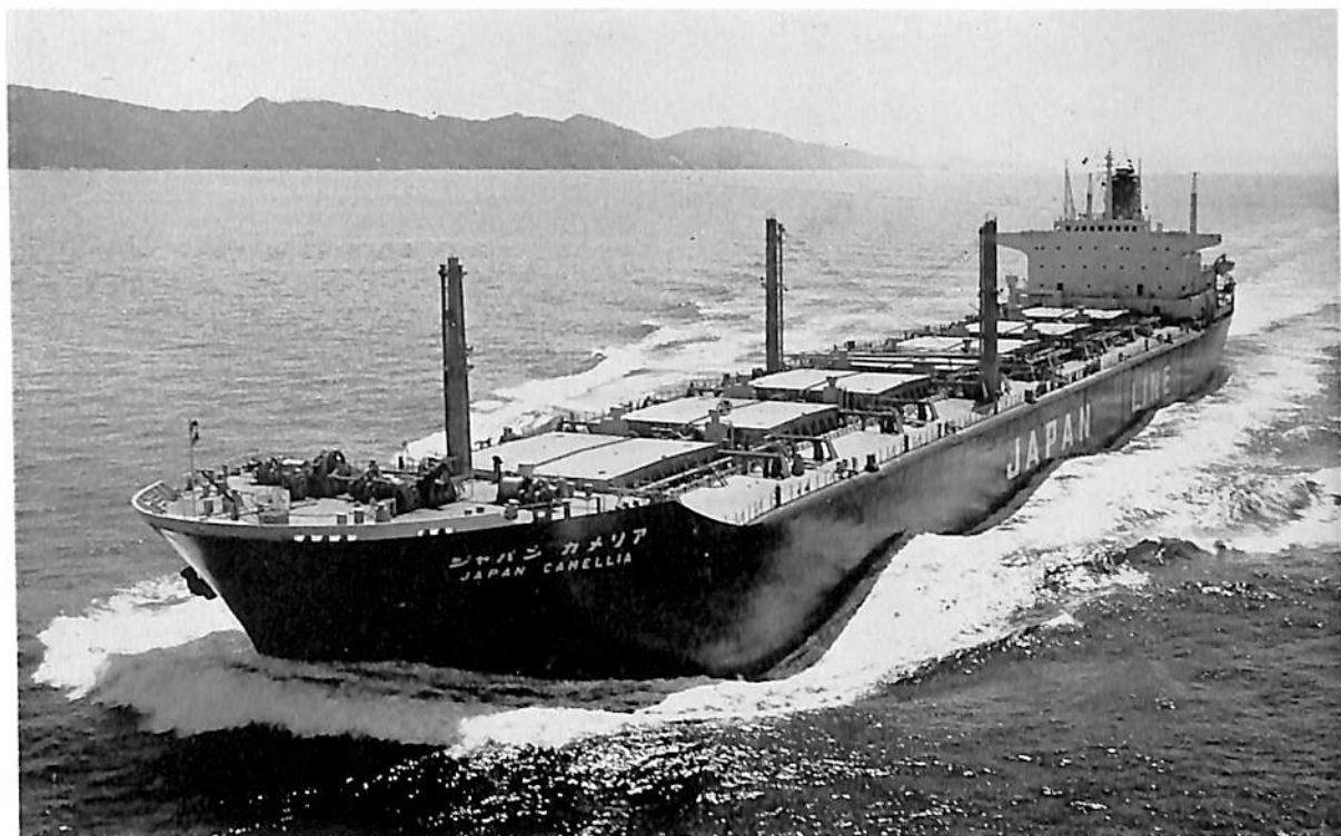
ジャパン カメリア (ばら積兼油槽船) 船主 ジャパンライン株式会社 造船所 株式会社 呉造船所 全長 234.00 m 長(垂) 222.00 m 幅(型) 31.70 m 深(型) 19.85 m 吃水 12.16 m 総噸数 40,600 噸 載貨重量 58,700 噸 速力 15.65 ノット 主機 IHI-スルザー 8 RD 90 型ディーゼル機関 1 基 出力 18,400 PS 船級 NK 起工 41-3-3 進水 41-7 竣工 41-9-26
