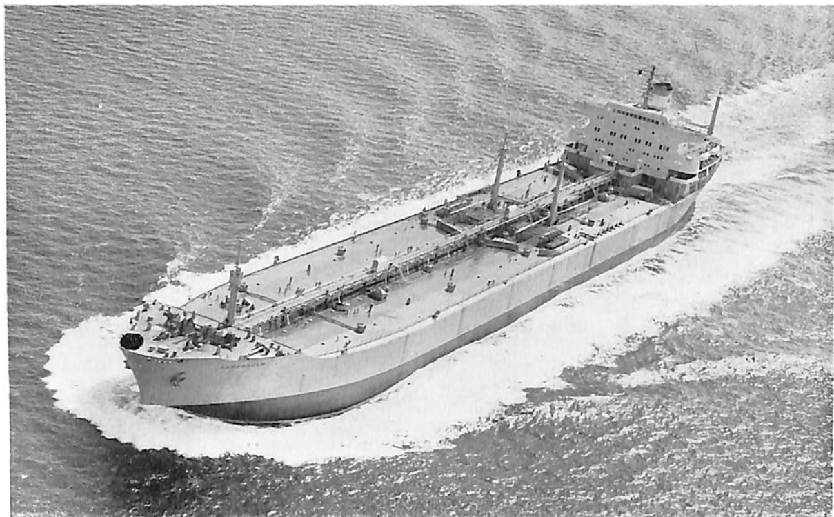
KONGSHOLM (油槽船) 船主 A. GOWART OLSEN (ノルウェー) 造船所 三井造船・玉野造船所 長(垂) 227.07 m 幅(型) 32.207 m 深(型) 16.942 m 吃水 11.659 m 総噸数 35,280.05 噸 載貨重量 55,693.00 噸 速力 約 17 ノット 主機 三井 B&W 984-VT 2 BF-180 型ディーゼル機関 1 基 速力 20,700 PS×114 RPM 船級 NV 起工 41-4-8 進水 41-7-1 竣工 41-9-27
