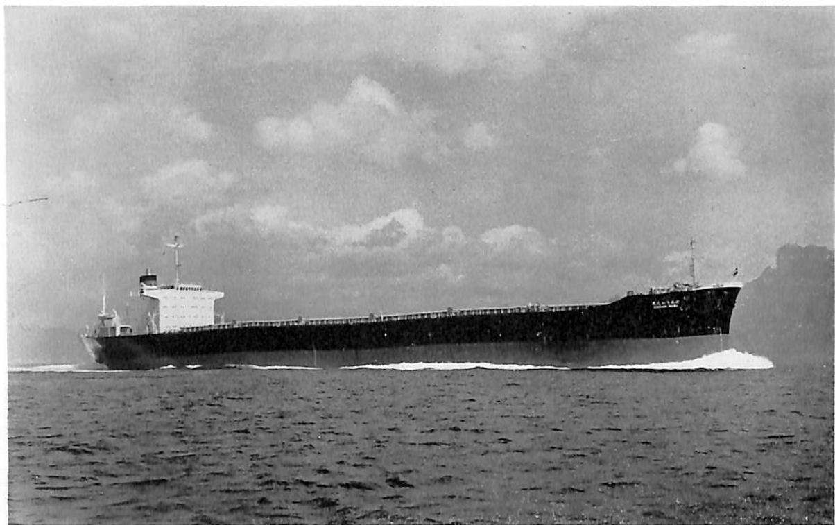
だ ぁ う い ん 丸 (鉾石運搬船) 船主 第一中央汽船株式会社 造船所 浦賀重工・浦賀工場 長(垂) 183.00 m 幅(型) 29.50 m 深(型) 14.90 m 吃水 10.06 m 総噸数 23,842.84 噸 載貨重量 37,822.00 噸 主機 浦賀スルザー 8 RD 76 型ディーゼル機関 1 基 出力 12,800 PS×122 RPM 船級 NK 起工 41-4-5 進水 41-8-1 竣工 41-9-26
