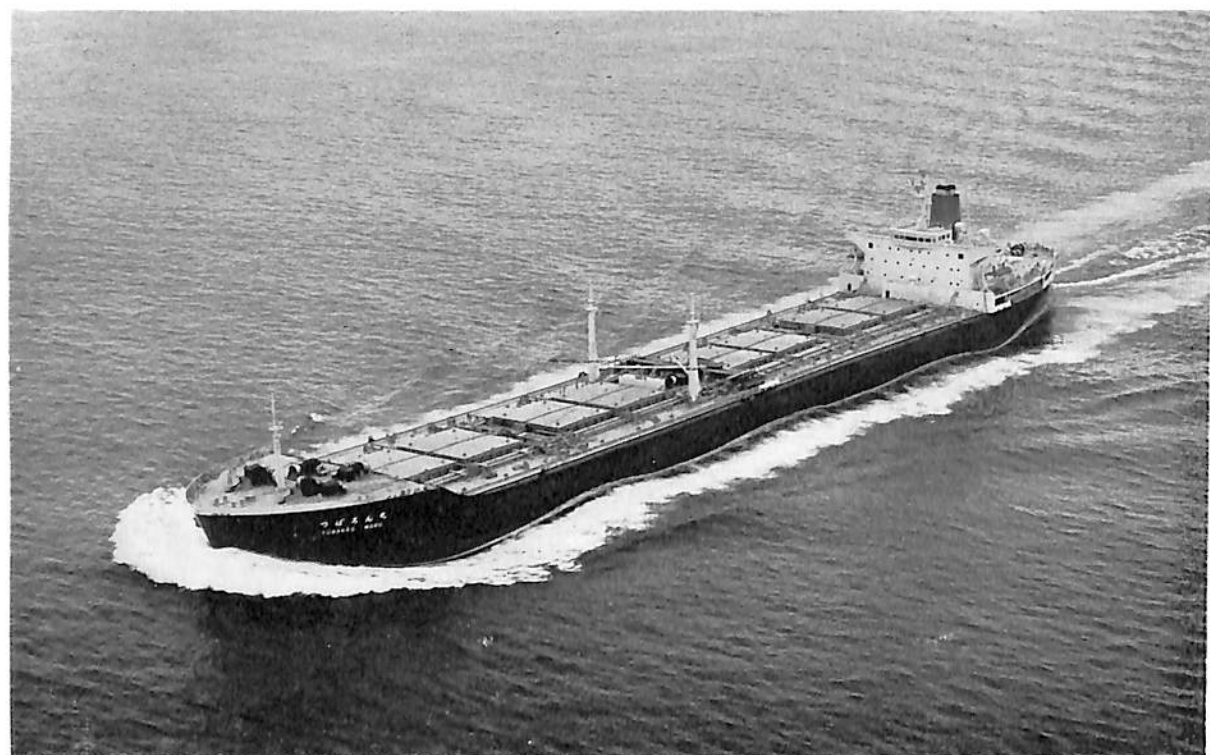
つばろん丸 (鉱石兼油運搬船) 船主 大阪商船三井船舶株式会社 造船所 三井造船・玉野造船所 全長 224.01 m 長(垂) 213.00 m 幅(型) 31.70 m 深(型) 17.60 m 吃水 11.864 m 総噸数 35,229.38 噸 載貨重量 55,605.00 噸 主機 三井 B&W DE 884 VT 2 BF-180 型ディーゼル 機関1基 出力 15,640 PS×108 RPM 船級 NK 起工 40-12-18 進水 41-4-27 竣工 41-7-15
