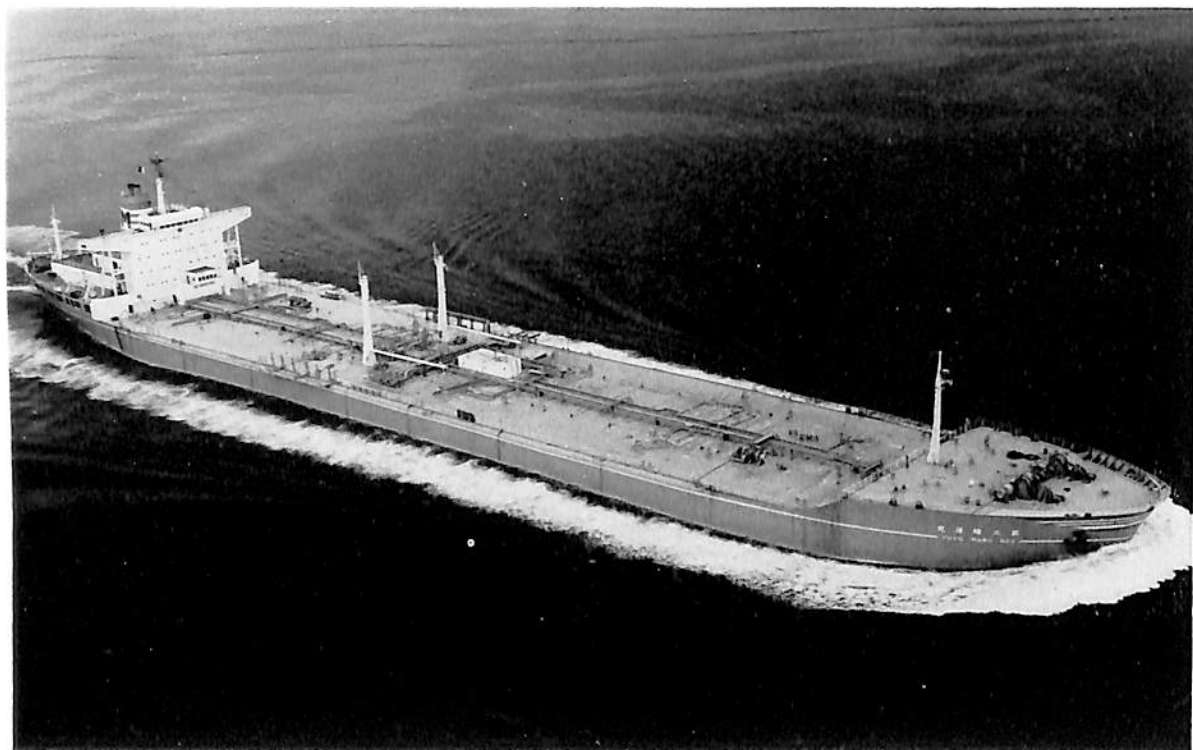
オ ニ 雄 洋 丸 (油 槽 船) 船 主 森田汽船株式会社 造船所 日立造船・因島工場 全長 238.60 m 長(垂) 227.00 m 幅(型) 36.50 m 深(型) 16.40 m 吃水 12.056 m 総噸数 38,878.87 噸 載貨重量 67,416.00 噸 貨物油倉 97,724.51 m 3 速力 15.61 ノット 主機 日立 B&W 884-VT 2 BF ディーゼル機関 1 基 出力 15,640 PS×108 RPM 船級 NK 乗組員数 35 名 起工 40 11-29 進水 41-5-6 竣工 41-7-15
