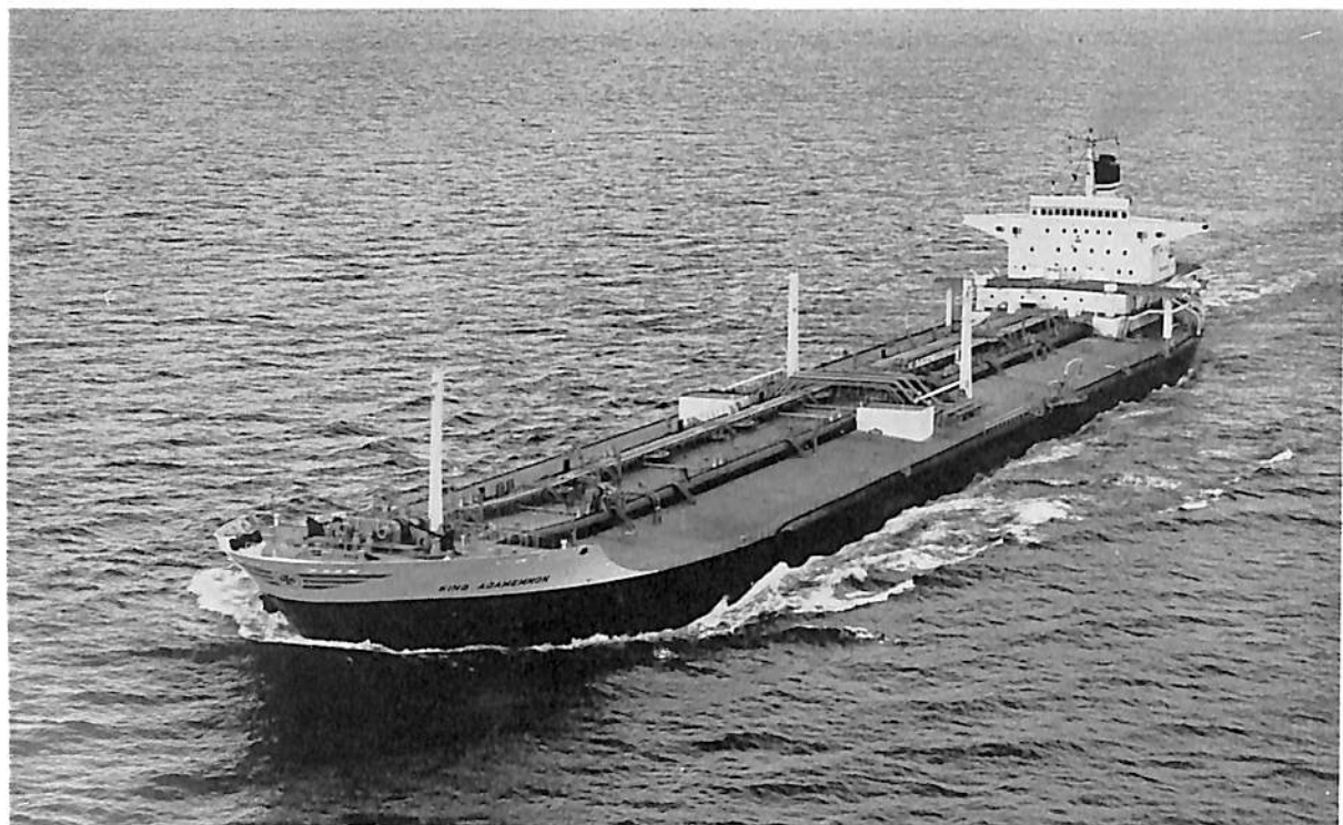
KING AGAMEMON (油槽船) 船主 MYCENANEAN SHIPPING CO. (リベリア) 造船所 石川島播磨重工・相生工場 長(垂) 240.0 m 幅(型) 38.0 m 深(型) 18.2 m 吃水 12.8 m 総噸数 47,000 噸 載貨重量 83,803 噸 速力 15.5 ノット 主機 IHI スルザー 9 RD 90 型ディーゼル機関1基 出力 20,700 PS 船級 AB 起工 41-3-2 進水 41-4-22 竣工 41-8-12
