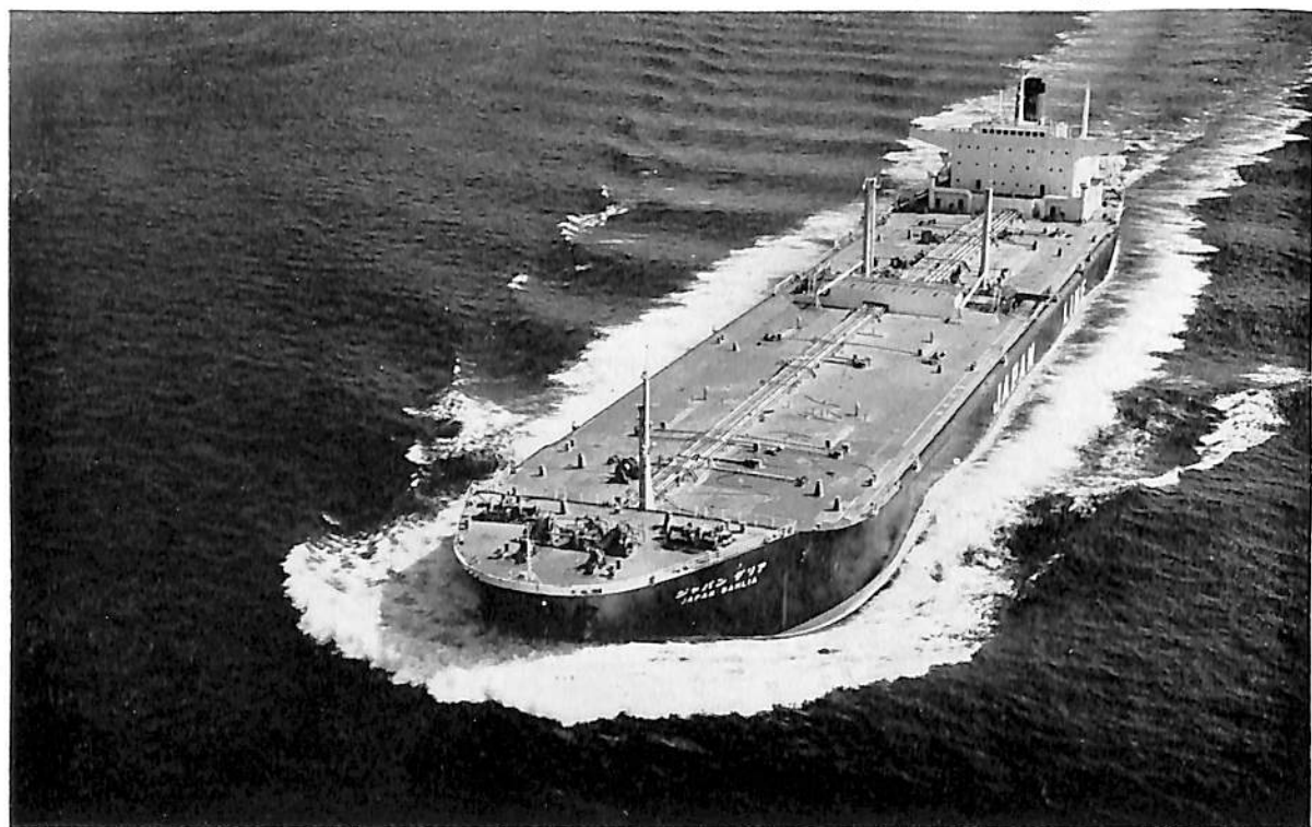
ジャパンダリア (油槽船) 船主 ジャパンライン株式会社 造船所 浦賀重工・浦賀工場 長(垂) 232.00 m 幅(型) 37.12 m 深(型) 18.00 m 吃水 12.46 m 総噸数 44,406.16 噸 載貨重量 76,931.00 噸 速力(公試) 16.66 ノット 主機 浦賀スルザー 9 RD 90 型ディーゼル機関 1 基 出力 20,700 PS×119 RPM 船級 NK 起工 41-1-11 進水 41-6-2 竣工 41-9-24
