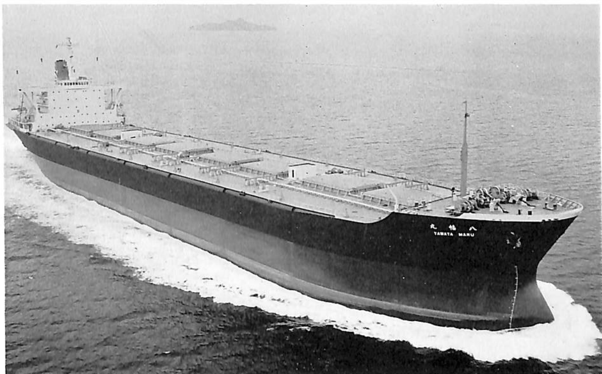
八 幡 丸 (鉾石運搬船) 船主 新和海運株式会社 造船所 三菱重工・広島造船所 長(垂) 216.0 m 幅(型) 35.7 m 深(型) 18.7 m 吃水 12.58 m 総噸数 42,000.00 噸 載貨重量 68,400.00 噸 速力 14.9 ノット 主機 三菱スルザー 6 RD 90 型ディーゼル機関 1 基 出力 15,000 PS 船級 NK 起工 41-1-11 進水 41-7-15 竣工 41-9-27
