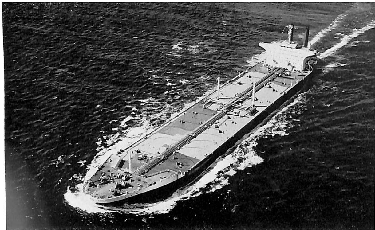
千 尋 丸 (油 槽 船) 船 主 シエル船舶株式会社 造船所 三菱重工・長崎造船所 長(垂) 256.00 m 幅(型) 42.50 m 深(型) 21.20 m 吃水 14.935 m 総噸数 64,070.92 噸 載貨重量 117,359.00 噸 速力 16.4 ノット 主機 三菱 M, T, P 出力 24,000 PS 船級 LR 起工 41-3-8 進水 41-5-20 竣工 41-9-28
