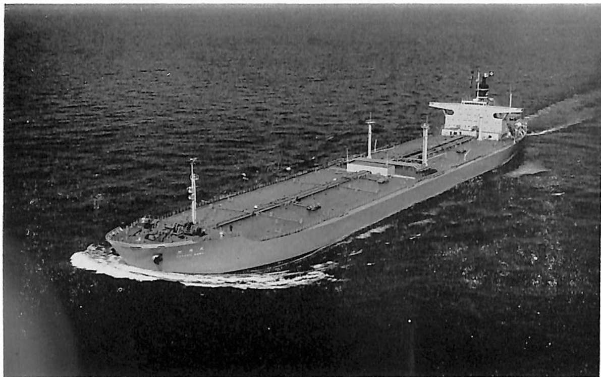
邦 鶴 丸 (油 槽 船) 船 主 日 邦 汽 船 株 式 会 社, 昭 和 海 運 株 式 会 社 造 船 所 三 菱 重 工 ・ 長 崎 造 船 所 長 (垂) 256.0 m 幅 (型) 42.5 m 深 (型) 20.0 m 吃 水 15.6 m 総 噸 数 67,544.88 噸 載 貨 重 量 122,684.00 噸 速 力 16.05 ノ ッ ト 主 機 三 菱 MTP 出 力 24,400 PS 船 級 NK 起 工 41-4-8 進 水 41-7-4 竣 工 41-10-16
