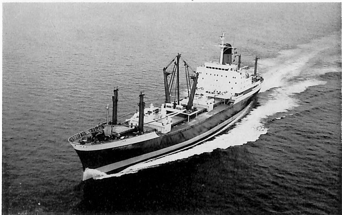
GLENALMOND (貨物船) 船主 GLEN LINE LTD. (イギリス) 造船所 三菱重工・長崎造船所 長(垂) 158.80 m 幅(型) 23.62 m 深(型) 13.41 m 吃水 9.12 m 総噸数 13,800 噸 載貨重量 11,700 噸 速力 21.0 ノット 主機 三菱スルザー9RD90型ディーゼル機関1基 出力 18,900 PS×110 RPM 船級 LR 起工 40-10-5 進水 41-2-22 竣工 41-9-20
