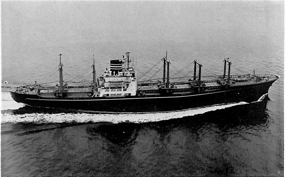
岩代丸 (貨物船) 船主 日本郵船株式会社 造船所 石川島播磨重工・相生工場 長(垂) 140.00 m 幅(型) 22.4 m 深(型) 13.35 m 吃水 9.45 m 総噸数 10,700 噸 載貨重量 12,712 噸 速力 18.35 ノット 主機 IHI-スルザー 7RD76 型ディーゼル機関 1 基 出力 10,500 PS 船級 NK 起工 41-4-1 進水 41-7-20 竣工 41-10-19
