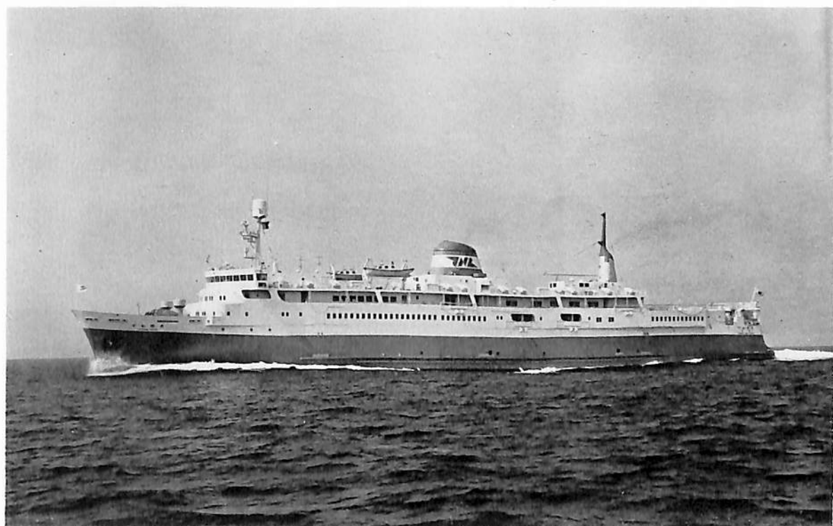
十 和 田 丸 (青函連絡船) 船主 日本国有鉄道 造船所 浦賀重工・浦賀工場 全長 132.0 m 幅(型) 17.9 m 深(型) 7.2 m 吃水 5.2 m 総噸数 8,335 噸 貨車搭載量 48 両 旅客 1,200 名 乗組員 88 名 速力 18.2 ノット 主機 川崎 MAN V 8 V 22/30 m AL ディーゼル機関8基 出力 1,600 PS×8 起工 41-2-15 進水 41-6-23 竣工 41-10-16
