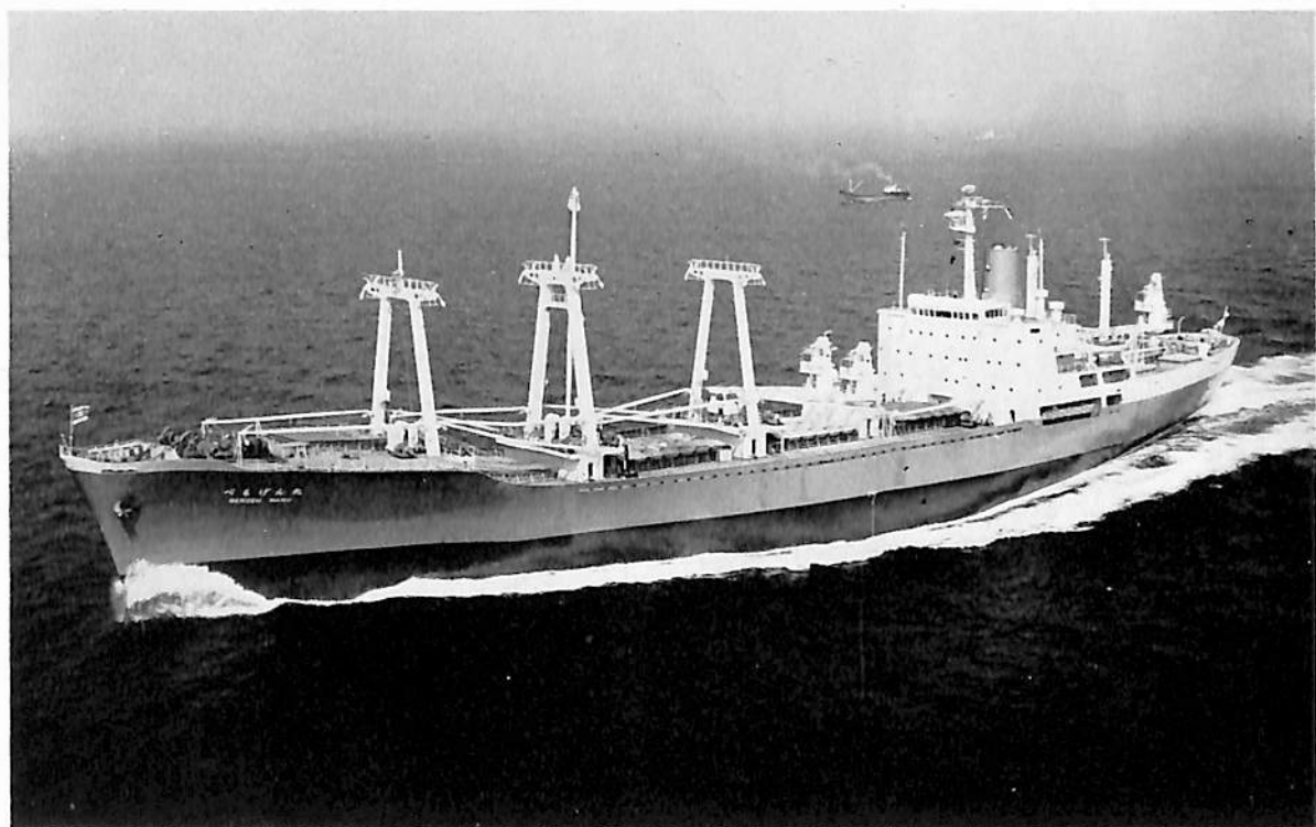
べるげん丸 (貨物船) 船主 大阪商船三井船舶株式会社 造船所 三菱重工・神戸造船所 長(垂) 156.00 m 幅(型) 23.20 m 深(型) 12.90 m 吃水 9.00 m 総噸数 11,616 噸 載貨重量 12,587 噸 速力 20.7 ノット 主機 三菱スルザー 8RD90 型ディーゼル機関 1 基 出力 18,400 PS 船級 NK 起工 41-2-16 進水 41-7-3 竣工 41-10-20
