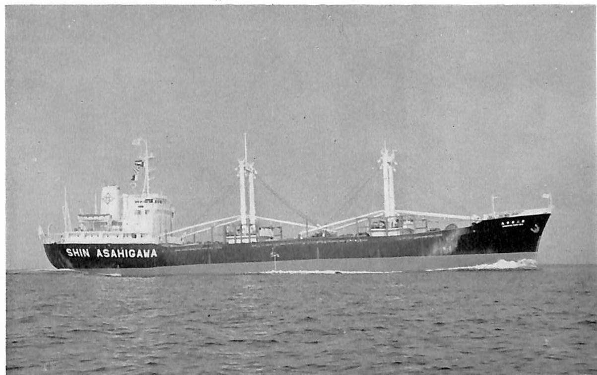
新旭川丸 (木材運搬船) 船主 新旭川株式会社 造船所 尾道造船株式会社 全長 108.70 m 長(垂) 100.40 m 幅(型) 16.40 m 深(型) 8.20 m 吃水 6.596 m (木) 6.956 m 総噸数 3,932.42 噸 載貨重量 6,013.73 噸 (木) 6,524.25 噸 貨物倉容積(ベール) 7,751.70 m 3 (グリーン) 8,387.12 m 3 速力(試運転最大) 16.058 ノット(航海) 12.70 ノット 主機 三菱 6UD 45 型ディーゼル機関 1 基 出力(連続最大) 3,500 PS×240 RPM (常用) 2,975 PS×227 RPM 乗組員 34 名 船級 NK 起工 41-4-8 進水 41-8-4 竣水 41-10-6
