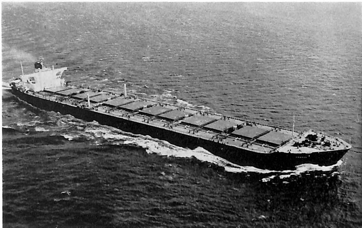
CEDROS (油兼ばら積貨物船) 船主 SEATANKERS, INC., (リベリア) 造船所 株式会社 呉造船所 長(垂) 286.5 m 幅(型) 43.3 m 深(型) 24.69 m 吃水 16.46 m 総噸数 約 88,400 噸 載貨重量 144,000 噸 速力 15.70 ノット 主機 G.E 社タービン 出力(連続最大) 27,500 PS 船級 AB 起工 41-2-7 進水 41-7-15 竣工 41-10-31
