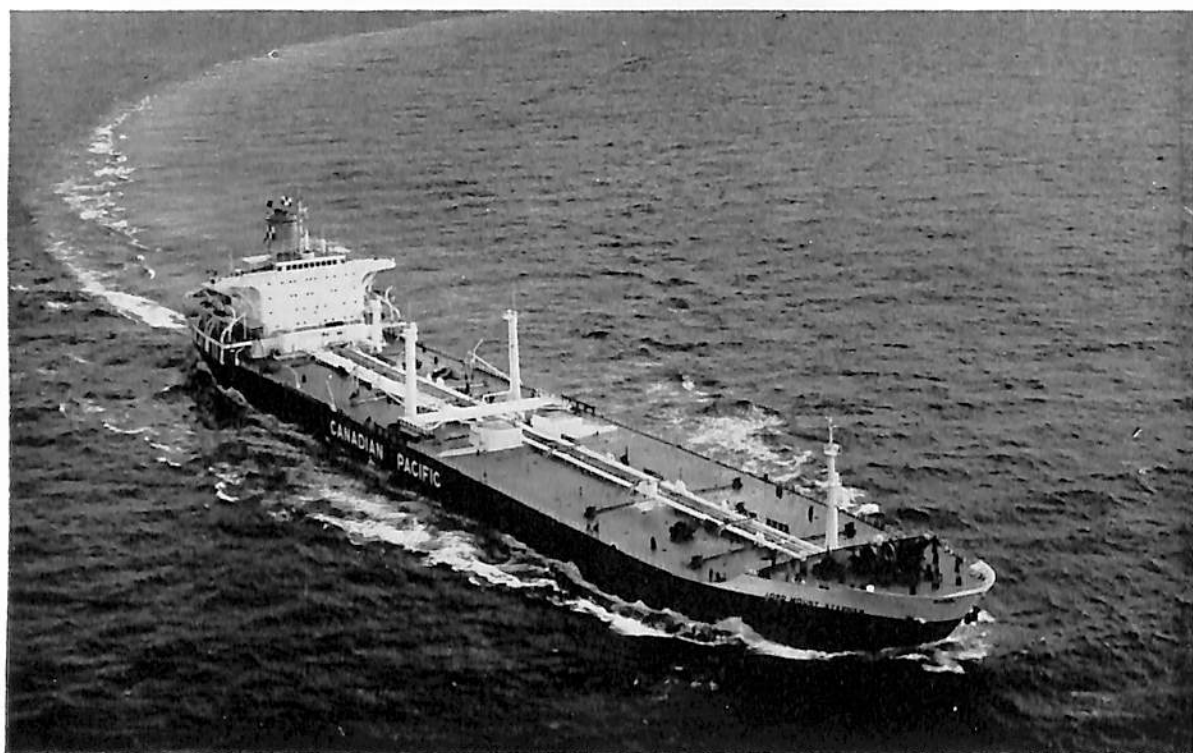
LOAD MOUNT STEPHEN (油 槽 船) 船 主 CANADIAN PACIFIC LTD. 造 船 所 三 菱 重 工 ・ 長 崎 造 船 所 長 (垂) 218.00 m 幅 (型) 35.98 m 深 (型) 17.4 m 吃 水 12.9 m 総 噸 数 40,500 噸 載 貨 重 量 65,000 噸 速 力 17.1 ノ ッ ト 主 機 三 菱 ス ル ザ ー 9 RD 90 型 デ ィ ー ゼ ル 機 関 1 基 出 力 20,700 PS 船 級 LR 起 工 41-4-8 進 水 41-8-3 竣 工 41-11-10
