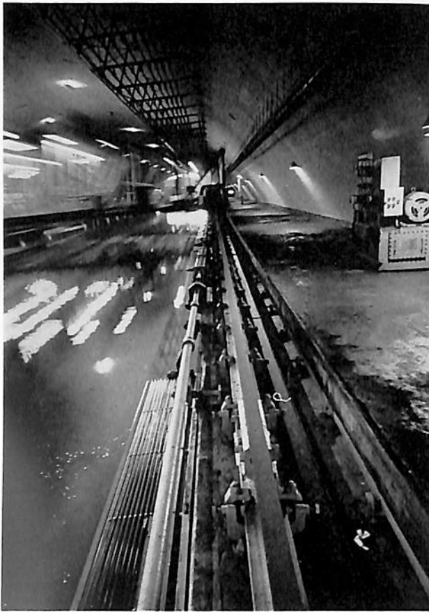
写真3 消渦レール 水側より 側面消波装置 走航用レール レール調整用溝 ブレーキ用レール
