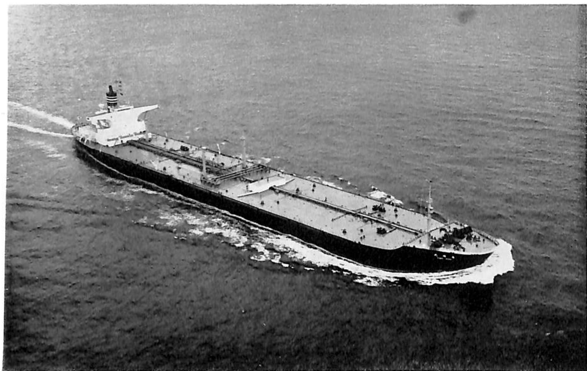
鳥 羽 丸 (油 槽 船) 船 主 日本郵船株式会社 造船所 三菱重工・長崎造船所 長(垂) 356 m 幅(型) 42.5 m 深(型) 22 m 吃水 15.82 m 総噸数 67,614.8 噸 載貨重量 123,672 噸 速力 16.05 ノット 主機 MPT 出力 24,000 PS 船級 NK 起工 41-4-28 進水 41-8-30 竣工 41-11-30
