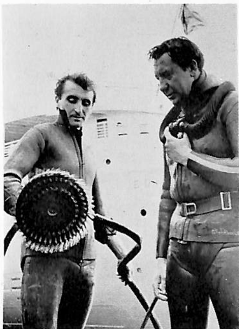
後方に見える“エディンバラ城”号の船底掃除に使用された直径12インチの柔い鋼のブラシを持上げる潜水夫
