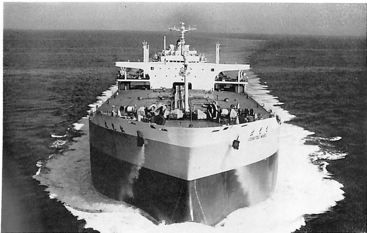
出 光 丸 (油 槽 船) 船 主 出光タンカー株式会社 造船所 石川島播磨重工・横浜工場 全長 342 m 長(垂) 326 m 幅(型) 49.80 m 深(型) 23.20 m 吃水 17.65 m 総噸数 108,500 噸 載貨重量 210,000 噸 貨物倉容積 245,000 m 3 速力 16.5 ノット 主機 IHI クロ スコンバウンド型衝動再熱式 2 段減速装置付船用蒸気タービンシングルプレーン式 1 基 出力 32,000 PS ×100 RPM 乗組員 32 名 船級 NK, AB 起工 41-2-1 進水 41-9-5 竣工 41-12-7
