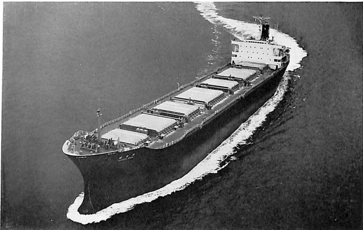
昭全丸 (ばら積貨物船) 船主 昭和海運株式会社 造船所 石川島播磨重工・相生工場 長(垂) 128.0 m 幅(型) 28.0 m 深(型) 16.0 m 吃水 10.0 m 総噸数 24,500 噸 載貨重量 37,259 噸 速力 15.0 ノット 主機 IHI-スルザー 8 RD 76 型ディーゼル機関 1 基 出力 12,800 PS 船級 NK 起工 41-5-10 進水 41-9-22 竣工 41-12-1
