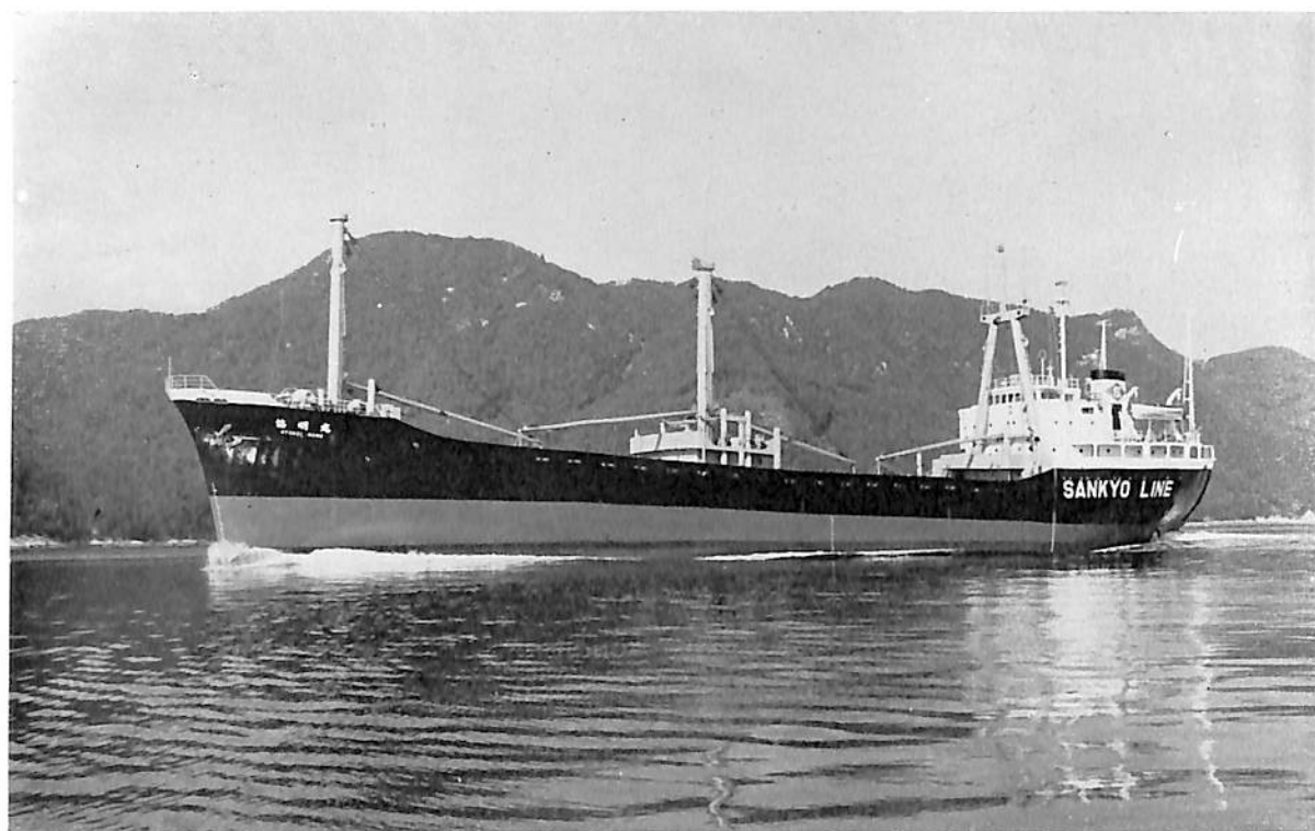
協 明 丸 (木材運搬船) 船主 長鋪汽船株式会社 造船所 株式会社 宇品造船所 総噸数 2,751.22 噸 純噸数 1,664.70 噸 船級 NK 載貨重量 4,616.33 噸 全長 94.80 m 長(垂) 88.00 m 幅(型) 14.50 m 深(型) 7.30 m 吃水 6.139 m 満載排水量 6,042.00 噸 主機 阪神内燃機製 Z 650 SH ディーゼル機関 1 基 出力 2,125 PS×241 RPM 速力 12.2 ノット 貨物倉容積(ベール) 5,328.90 m 3 (グレーン) 5,715.5 m 3 燃料油倉容積 349.98 m 3 清水倉容積 395.23 m 3 乗組員数 30 名 起工 41-8-22 進水 41-11-3 竣工 41-12-10
