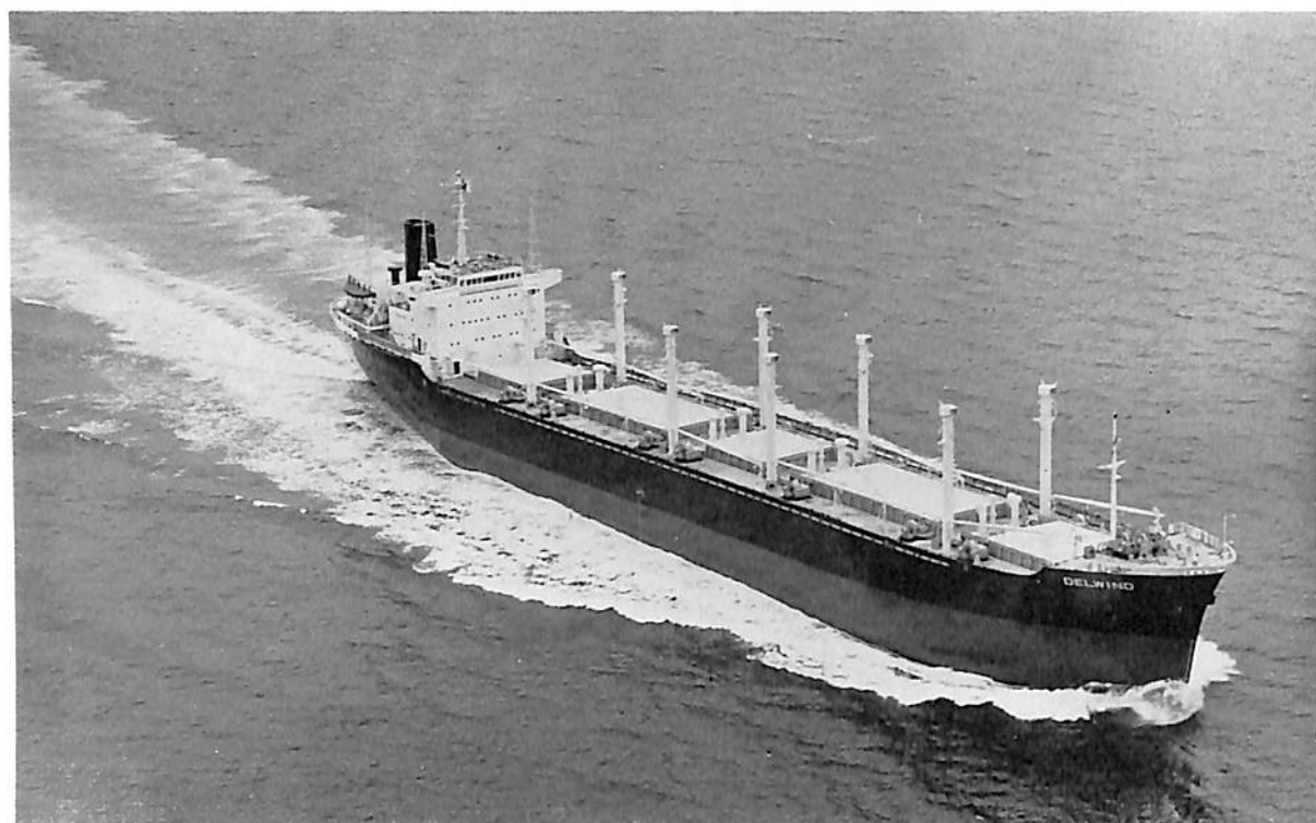
DELWIND (鉱石兼油運搬船) 船主 TAI SHIP CO., LTD (ホンコン) 造船所 佐野安船渠株式会社 総噸数 9,317.07 噸 純噸数 6,287.22 噸 船級 BV 載貨重量 16,654.6 噸 全長 147.52 m 長(垂) 140.00 m 幅(型) 20.50 m 深(型) 12.55 m 吃水 9.050 m 満載排水量 20,675.1 噸 主機 川崎 MAN K 6 Z 70/120 C 型ディーゼル機関 1 基 出力 6,480 PS×130 RPM 速力 14.4 ノット 貨物倉容積(ベール) 19,740.2 m 3 (グレーン) 20,702.2 m 3 燃料油倉容積 1,323.8 m 3 清水倉容積 594.4 m 3 乗組員数 42 名 起工 41-6-3 進水 41-8-12 竣工 41-10-6
