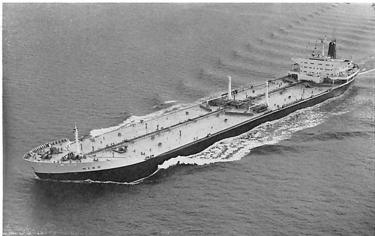
NISO (油槽船) 船主 SHELL TANKERS.NV (オランダ) 造船所 石川島播磨重工・相生工場 長(垂) 252.98 m 幅(型) 42.01 m 深(型) 20.20 m 吃水 14.30 m 総噸数 64,000 噸 載貨重量 108,600 噸 速力 14.5 ノット 主機 IHI-スルザー 9RD90 型ディーゼル機関 1 基 出力 18,000 PS 船級 LR 起工 41-4-23 進水 41-7-23 竣工 41-11-22
