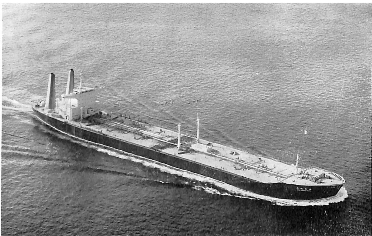
新大阪丸 (油槽船) 船主 大阪商船三井船舶株式会社 造船所 日立造船・因島工場 全長 258.50 m 長(垂) 246.00 m 幅(型) 40.20 m 深(型) 21.80 m 吃水 15.10 m 総噸数 61,657 噸 載貨重量 103,690 噸 貨物倉容積(ベール) 127,292 m 3 速力(試運転最大) 17.1 ノット 主機 日立 B&W 1084-VT 2 BF-180 型ディーゼル機関 1 基 出力(連続最大) 23,000 PS 乗組員 37 名 船級 NK 起工 41-6-14 進水 41-9-14 竣工 41-12-8
