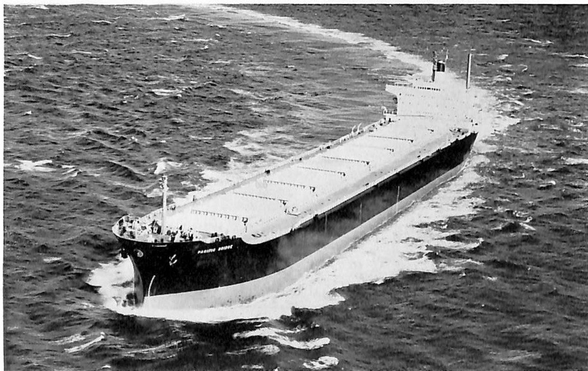
PACIFIC BRIDGE (ばら積貨物船) 船主 BIBBY LINE LTD. (英) 造船所 石川島磨播重工・相生工場 長(垂) 236.22 m 幅(型) 32.21 m 深(型) 20.10 m 吃水 12.58 m 総噸数 48,500 噸 載貨重量 65,800 噸 主機 IHI-スルザー 8RD 90 型ディーゼル機関 1 基 出力 18,400 PS 船級 LR 起工 41-8-22 進水 41-10-27 竣工 42-2
