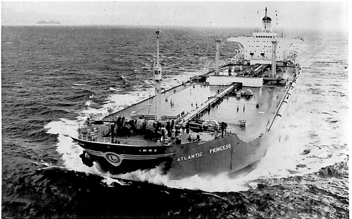
ATLANTIC PRINCESS (油槽船) 船主 ATLANTIC PRINCESS SHIPPING GO. (リベリア) 造船所 三菱重工・長崎造船所 長(垂) 243 m 幅(型) 38.5 m 深(型) 17.65 m 吃水 12.8 m 総噸数 40,884.46 噸 載貨重量 86,842 吨 速力 15.85 ノット 主機 三菱スルザー 9 RD 90 型デ ィーゼル機関 1 基 出力 20,780 PS 船級 AB 起工 41-6-27 進水 41-9-29 竣工 41-12-29
