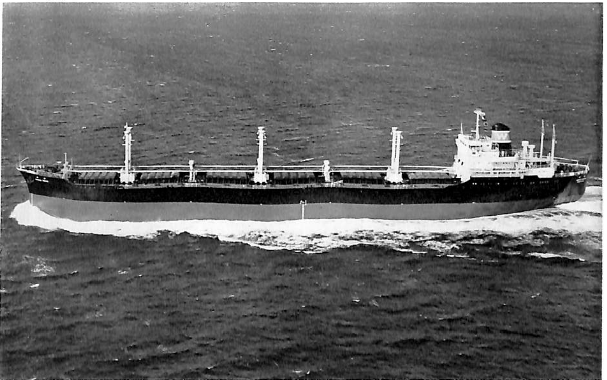
WORLD UNION (ばら積貨物船) 船主 WORLD COMBINATION CARRIERS LTD. (ホンコン) 造船所 株式会社 藤永田造船所 総噸数 16,436.09 噸 純噸数 10,643.82 噸 船級 LR 載貨重量 27,001 噸 全長 173.640 m 長(垂) 164.600 m 幅(型) 22.800 m 深(型) 14.700 m 吃水 10.866 m 満載排水量 33,305 噸 主機 IHI-スルザー 7 RD 76 型ディーゼル機関 1 基 出力 10,080 PS×118 RPM 燃料消費量 40.2 t/day 航続距離 19,500 海里 速力 15.6 ノット 貨物倉 容積(グリーン) 1,258.772 ft 3 燃料油倉(96%) 2.211 LT 清水倉 263 LT 乗組員 56 名 起工 41-7-14 進水 41-10-15 竣工 42-1-24
