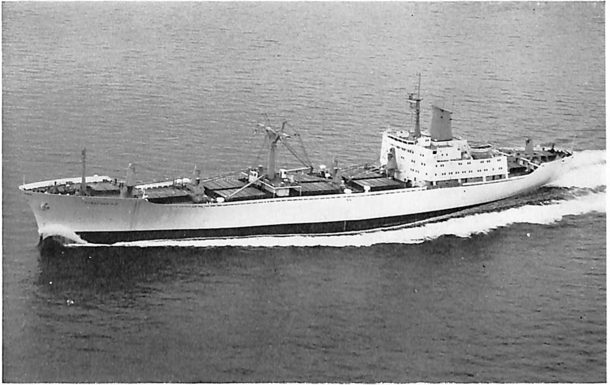
STRATHARDLE (貨物船) 船主 The P&O STEAM NAVIGATION CO. (英) 造船所 三井造船・玉野造船所 長(垂) 160.00 m 幅(型) 24.232 m 深(型) 13.97 m 吃水 (満) 9.147 m (航) 8.001 m 総噸数 13,057.06 噸 載貨重量 12,552 噸 速力(満) 22.45 ノット (航) 21 ノット (試) 24.46 ノット 主機 三井 B&W 984-VT 2 BF-180 型ディーゼル機関 1 基 出力 (連続最大) 20,700 PS×114 RPM 船級 LR 起工 41-6-20 進水 41-9-19 竣工 42-1-20
