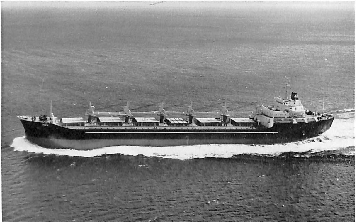
JEAN (ばら積貨物船) 船主 CARDENOSA COMPANIA S.A (リベリヤ) 造船所 株式会社 大阪造船所 長(垂) 162.60 m 幅(型) 24.84 m 深(型) 14.02 m 吃水 9.14 m 総噸数 15,996 噸 載貨重量 26,728 噸 速力(試運転最大) 16.915 ノット 主機 IHI スルザー 7 RD 型 ディーゼル機関 1 基 出力 11,200 PS × 122 RPM 船級 AB 起工 41-7-29 進水 41-11-12 竣工 42-3-3
