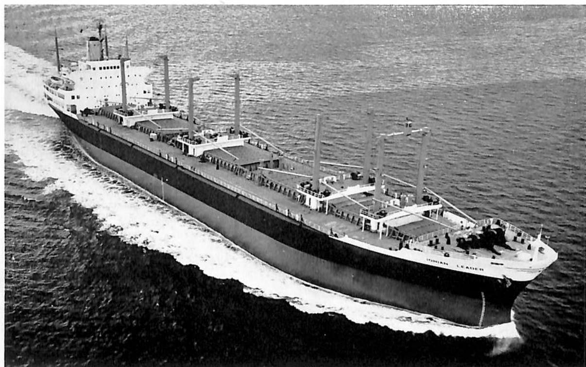
IONIAN LEADER (ばら積貨物船) 船主 VULCANIA STEAMSHIP CO. (リベリア) 造船所 三菱重工・広島造船所 長(垂) 185 m 幅(型) 27.4 m 深(型) 16.0 m 吃水 10.56 m 総噸数 20,959.15 噸 載貨重量 32,340.00 噸 速力 15.5 ノット 主機 三菱スルザー 7 RD 76 型ディーゼル機関 1 基 出力 11,200 PS 船級 AB 起工 41-8-30 進水 41-11-29 竣工 42-2-25
