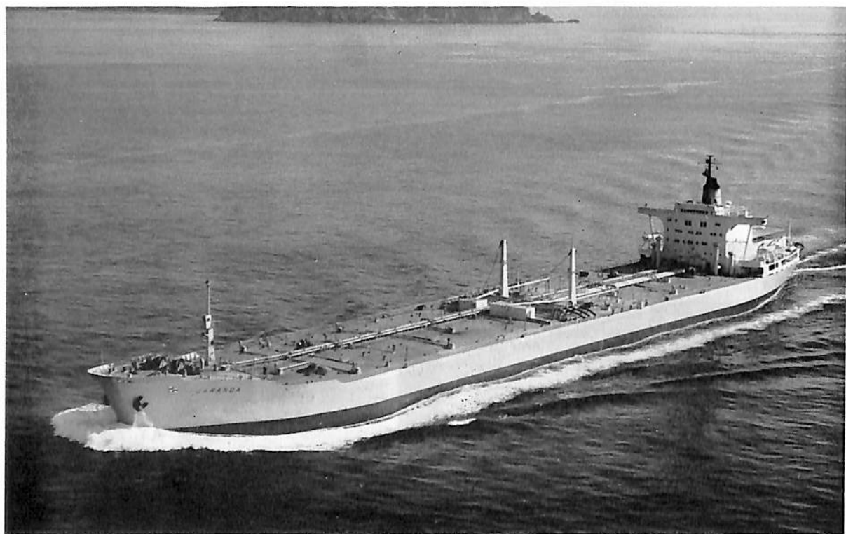
JARANDA (油槽船) 船主 ANDERS JAHRE REDERI III A.S. (ノルウェー) 造船所 日本鋼管・鶴見造船所 長(垂) 246.00 m 幅(型) 38.00 m 深(型) 19.50 m 吃水 14.17 m 総噸数 51,831.44 噸 載貨重量 98,332.67 噸 速力 15.35 ノット 主機 三井 B&W 984 VT 2 BF 180 型ディーゼル機関 1 基 出力 20,700 PS×114 RPM 船級 NV 起工 41-8-22 進水 41-11-30 竣工 42-2-23
