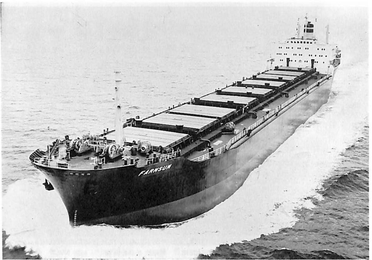
FARMSUM (ばら積貨物船) 船主 STOOMVAART MAATSCHAPPIJ OOSTEZEE (オランダ) 造船所 株式会社 呉造船所 長(垂) 196.00 m 幅(型) 27.396 m 深(型) 16.4 m 吃水 11.324 m 総噸数 25,465.97 噸 載貨重量 40,648.00 噸 速力 15 ノット 主機 三菱 MAN ディーゼル機関 1 基 出力(連続最大) 12,000 PS 船級 LR 起工 41-7-15 進水 41-11-2 竣工 42 3-10
