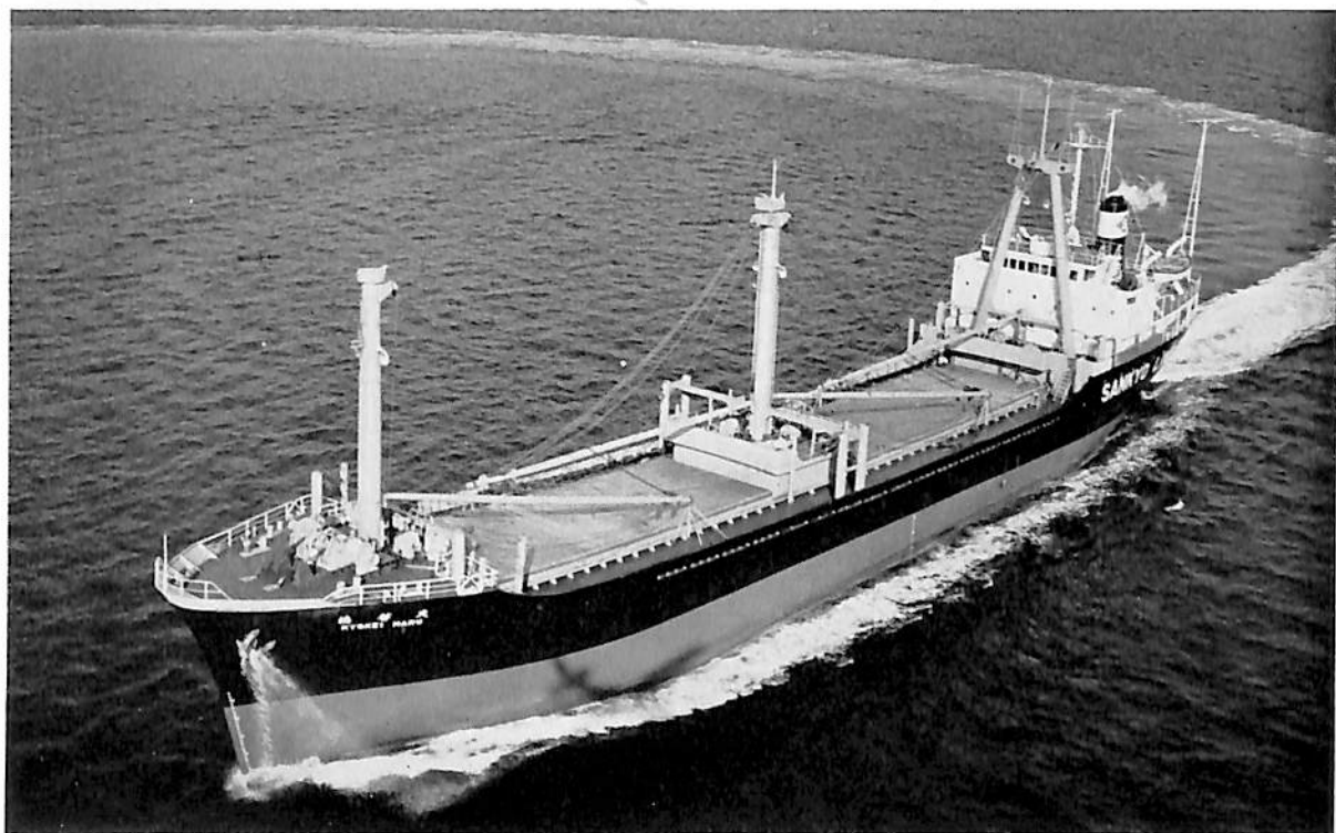
協 啓 丸 (貨物船) 船主 三協海運株式会社 造船所 株式会社 宇品造船所 総噸数 2,765.95 噸 純噸数 1,716.59 噸 船級 NK 載貨重量 4,600.59 噸 全長 94.80 m 長(垂) 88.00 m 幅(型) 14.50 m 深(型) 7.30 m 吃水 6.15 m 満載排水量 6,055 噸 主機 神戸 発動機製 6 UET 45/75 型ディーゼル機関 1 基 出力 2,805 PS×227 RPM 速力 12.5 ノット 貨物倉 容積(ペール) 5,440.5 m 3 (グレーン) 5,680.8 m 3 燃料油倉容積 364.81 m 3 清水倉容積 287.90 m 3 乗組員 25 名 予備 5 名 計 30 名 起工 41-11-3 進水 42-1-13 竣工 42-2-21
