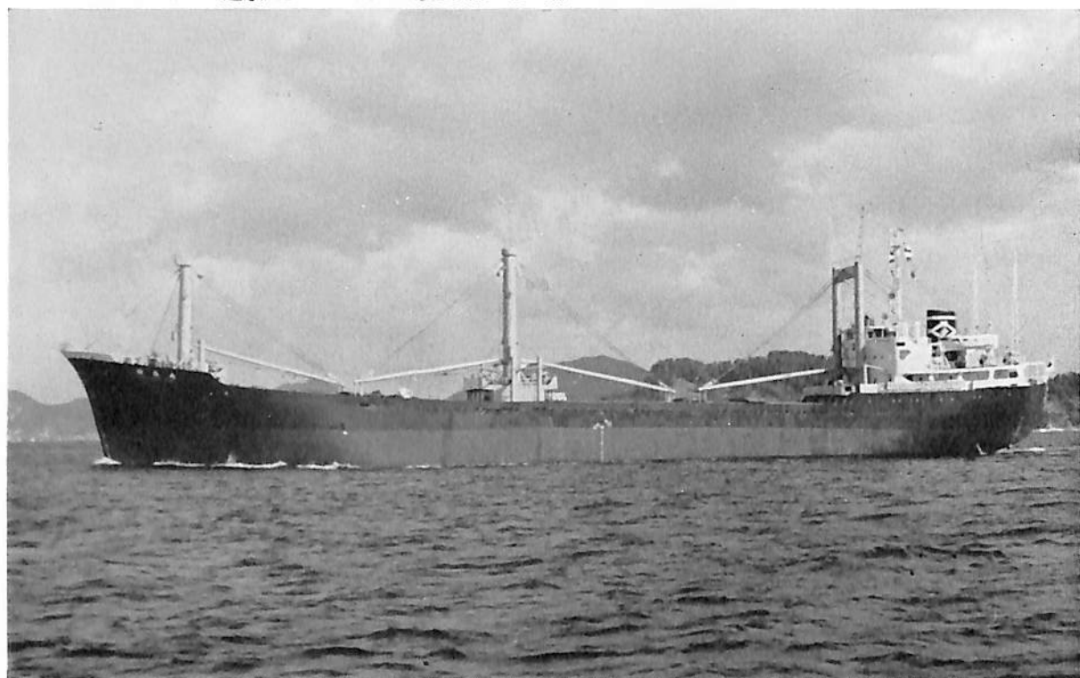
国島丸 (木材運搬船) 船主 北条協同海運株式会社 造船所 今治造船株式会社 総噸数 2,993.26 噸 純噸数 2,005.11 噸 船級 NK 載貨重量 5,666.438 噸 全長 101.30 m 長(垂) 94.00 m 幅(型) 15.7 m 深(型) 8.00 m 吃水 6.601 m 満載排水量 7,490.00 噸 主機 阪神内燃機製 Z750 A-SH 型ディーゼル機関1基 出力 2,550 PS×241 RPM 速力 12.35 ノット 貨物倉容積(ベール) 7,100.00 m 3 (グリーン) 7,471.15 m 3 燃料油倉容積 510.0 m 3 清水倉容積 374.4 m 3 乗組員数 20 名 起工 41-9-24 進水 42-2-28 竣工 42-2-15
