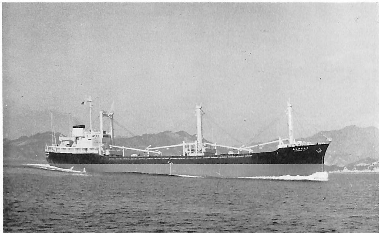
さんだかん丸 (雑貨, 木材運搬船) 船主 鶴亀海運株式会社 造船所 波止浜造船株式会社 総噸数 2,996.61 噸 純噸数 1,869.52 噸 船級 NK 載貨重量 5,051.89 噸 全長 100.60 m 長(垂) 94.00 噸 幅(型) 15.00 m 深(型) 7.70 m 吃水 6.394 m 満載排水量 6,903.00 噸 主機 赤坂鉄工所製過給機中間冷却器付単動4サイクルトランクピストン型ディーゼル機関1基 出力 2,400 PS×209 RPM 速力 12.4 ノット 貨物倉容積(ベール) 6,347.15 m 3 (グリーン) 6,712.67 m 3 燃料油倉容積 503.77 m 3 清水倉容積 313.88 m 3 燃料消費量 11 t/d 乗組員数 25 名 起工 41-9-7 進水 41-12-18 竣工 42-2-10
