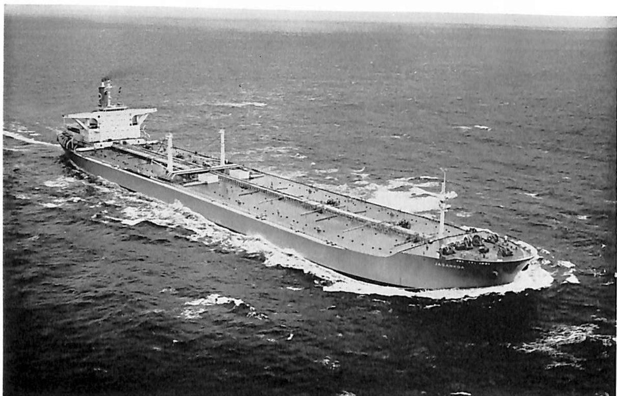
JASANKOA (油槽船) 船主 AKSJESELSKAPET KOSMOS (ノルウェー) 造船所 三菱重工・長崎造船所 長(垂) 285 m 幅(型) 48.2 m 深(型) 23.5 m 吃水 16.3 m 総噸数 92,000 噸 載貨重量 156,500 噸 速力 16.8 ノット 主機 MTP 出力 30,000 PS 船級 NV 起工 41-7-27 進水 41-10-26 竣工 42-2-25
