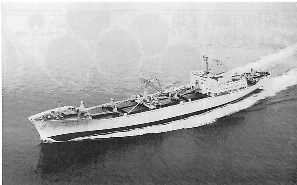
STRATHBRORA (貨物船) 船主 THE PENINSULAR & ORIENTAL STEAM NAVIGATON (英) 造船所 三井造船・玉野造船所 長(垂) 160.02 m 幅(型) 24.232 m 深(型) 13.970 m 吃水 9.146 m 総噸数 12,539.49 噸 載貨重量 12,604 噸 速力(公試) 24.59 ノット 主機 三井 B&W 984-VT 2 BF-180 型ディーゼル機関 1 基 出力(連続最大) 20,700 PS×114 RPM 船級 LR 起工 41-9-21 進水 41-12-15 竣工 42-3-31 同型船 STRATHARDLE (4号に概要記載)
