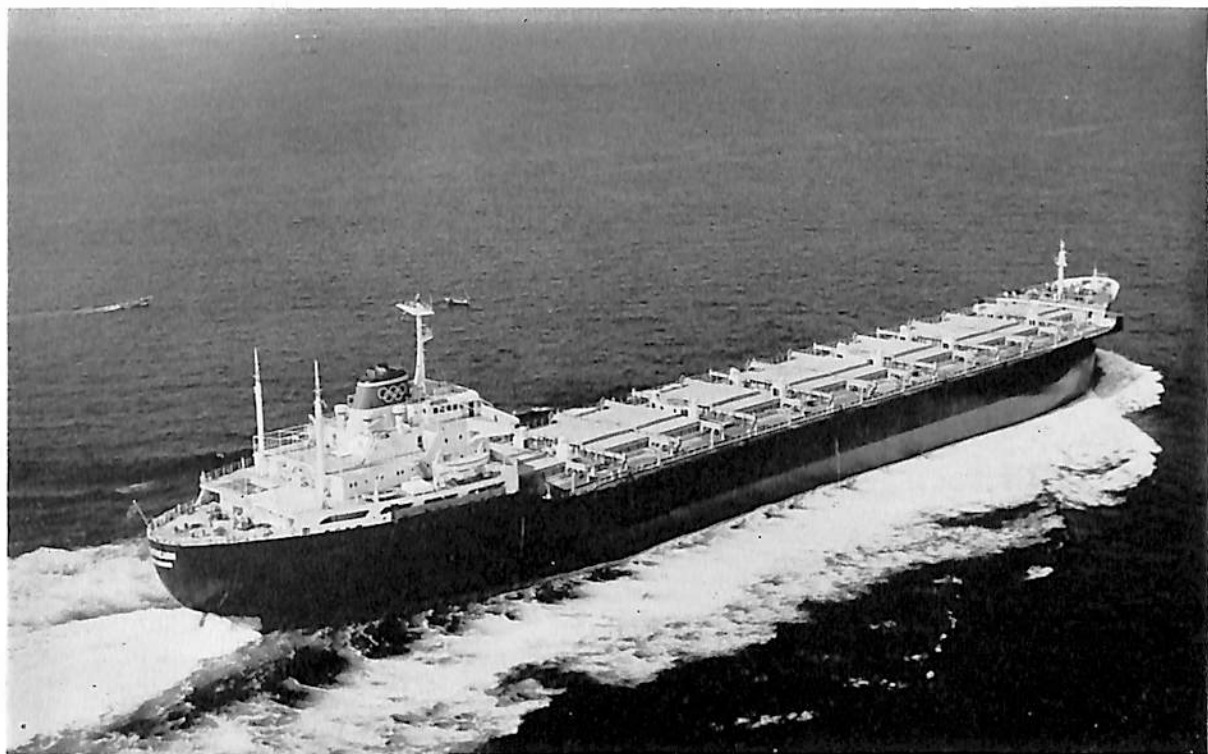
STRATHEARN (ばら積貨物船) 船主 MOSGULF SHIPPING CO. (ルーマニア) 造船所 浦賀重工・浦賀工場 長(垂) 210.0 m 幅(型) 32.2 m 深(型) 16.9 m 吃水 11.55 m 総噸数 32,911 噸 載貨重量 52,288 噸 速力(公試) 17.5 ノット 主機 浦賀スルザー 8 RD 90 型 ディーゼル機関 1 基 出力 17,600 PS×119 RPM 船級 NV 起工 41-9-3 進水 41-12-20 竣工 42-3-25
