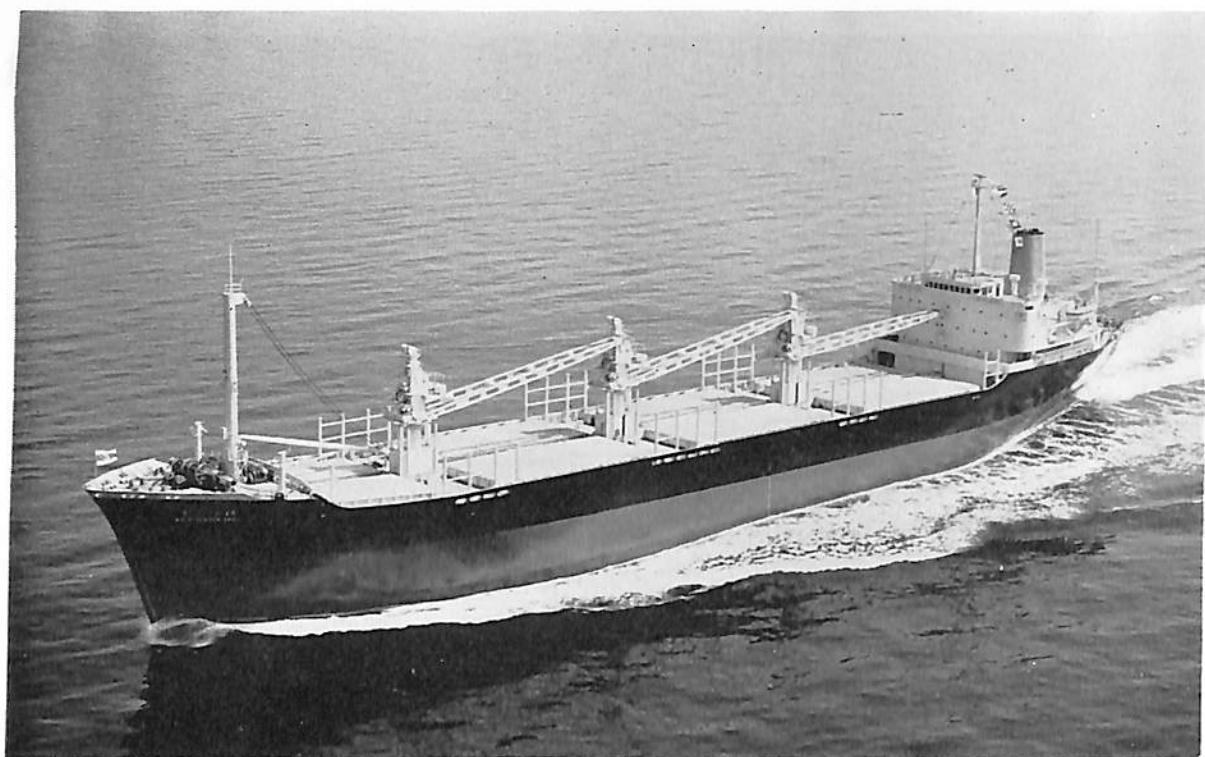
若竹山丸 (木材専用船) 船主 新栄船舶株式会社 造船所 株式会社 藤永田造船所 総噸数 10,045.67 噸 純噸数 5,631.46 噸 船級 NK 載貨重量 15,144 噸 全長 147.000 m 長(垂) 138.000 m 幅(型) 22.000 m 深(型) 11.800 m 吃水 8.645 m 満載排水量 19,574 噸 主機 三井 B&W 762 VT 2 BF-140 型ディーゼル機関 1 基 出力 7,140 PS×132 RPM 速力(試) 18.16 ノット 貨物倉容積(ベール) 19,000 m 3 (グレーン) 19,294 m 3 燃料油倉容積 1,195 m 3 清水倉容積 703 m 3 乗組員数 32 起工 41-10-20 進水 41-12-28 竣工 42-3-23
