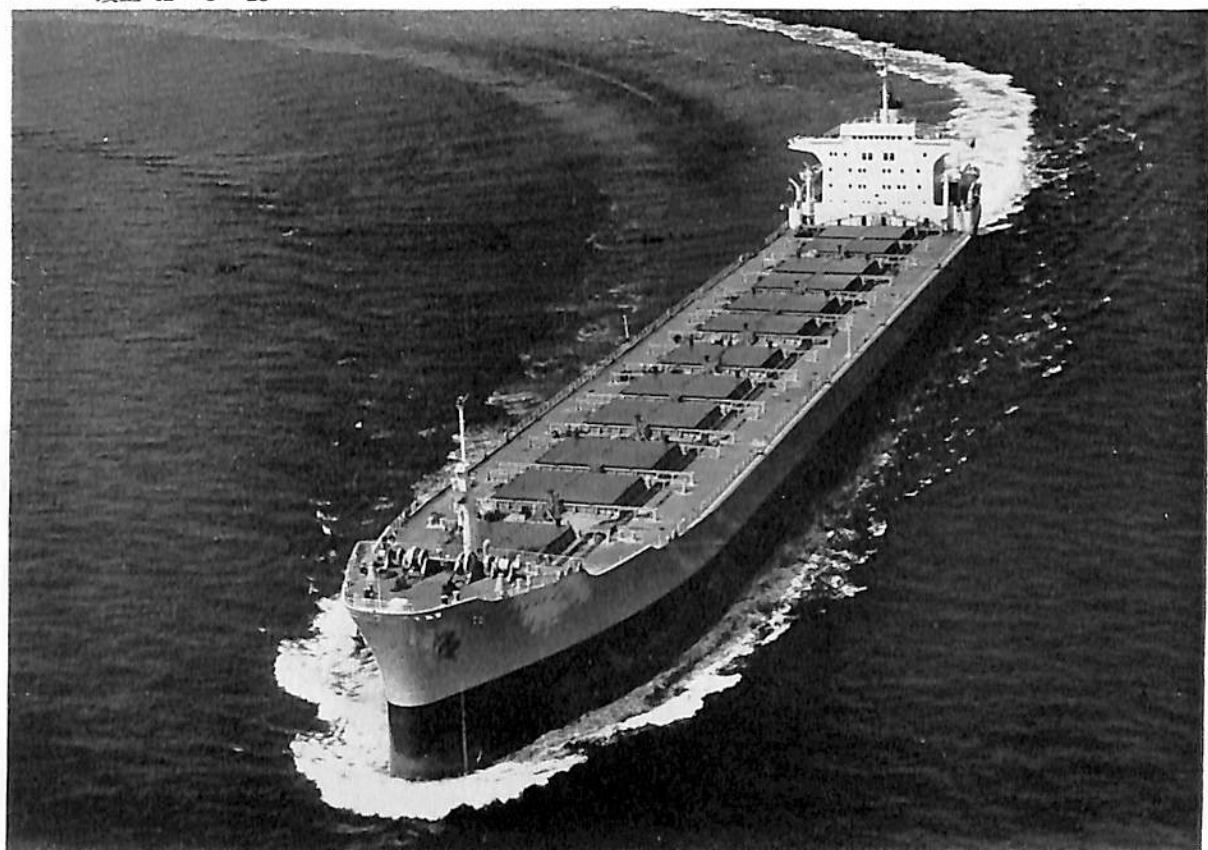
JASAKA (ばら積貨物船) 船主 AKESJESELSKAPET KOSMOS (ノルウェー) 造船所 日本鋼管・鶴見造船所 長(垂) 216.40 m 幅(型) 31.09 m 深(型) 17.526 m 吃水 11.913 m 総噸数 34,000 噸 載貨重量 55,000 噸 速力 16.4 ノット 主機 浦賀スルザー 8 RD 90 型ディーゼル機関 1 基 出力 17,600 PS×119 RPM 船級 NV 起工 41-12-2 進水 42-2-9 竣工 42-4-14
