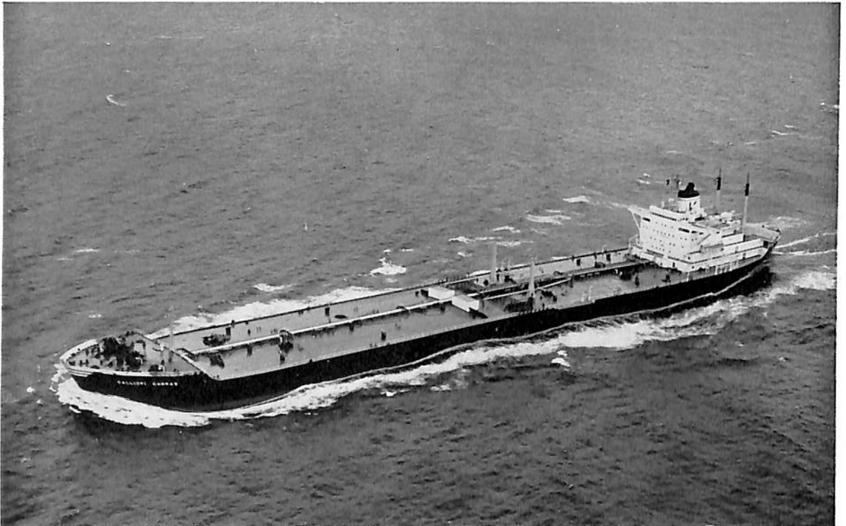
CALLIOP CALLAS (油槽船) 船主 ALMA SHIPPING CORP. (リベリア) 造船所 三菱重工・横浜造船所 長(垂) 237.0 m 幅(型) 37.2 m 深(型) 18.5 m 吃水 12.8 m 総噸数 44,000 噸 載貨重量 79,000 噸 速力 16.1 ノット 主機 GE タービン 出力 19,200 PS 船級 AB 起工 41-7-1 進水 41-12-7 竣工 42-3-15
