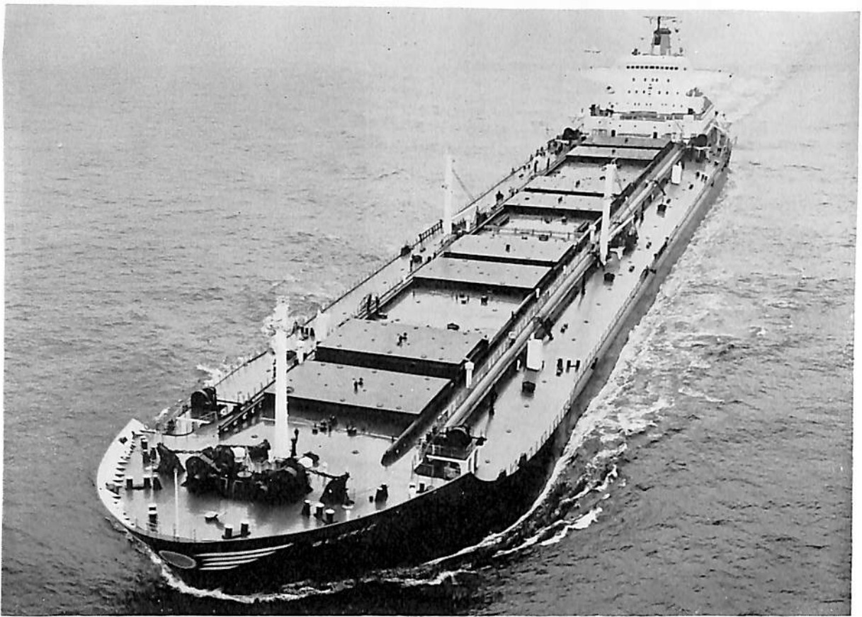
GLORIC (油・鉱石運搬船) 船主 VIRLD SHIPPING COMPANY (パナマ) 造船所 株式会社 呉造船所 全長 254.25 m 長(垂) 240.0 m 幅(型) 37.8 m 深(型) 17.50 m 吃水 13.307 m 総噸数 48,747.03 噸 載貨重量 82,547.00 噸 速力 15.7 ノット 主機 IHI ス ルザー 9RD90 型ディーゼル機関 1 基 出力(連続最大) 20,000 PS 船級 AB 起工 41-8-25 進水 41-12-1 竣工 42-4-11
