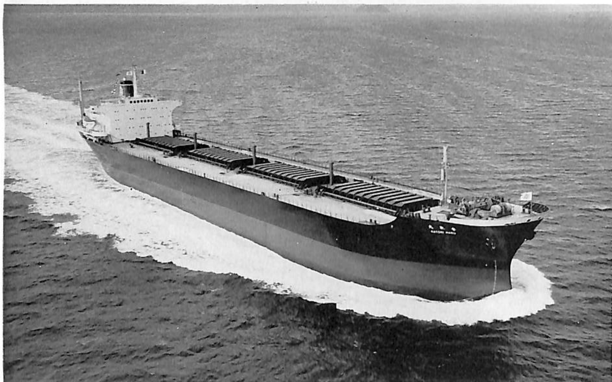
香 取 丸 (鉱石貨物船) 船主 昭国海運株式会社 造船所 株式会社 呉造船所 全長 193.50 m 長(垂) 183.00 m 幅(型) 30.00 m 深(型) 14.90 m 吃水 10.03 m 総噸数 24,194.89 噸 載貨重量 37,524.00 噸 速力 14.75 ノット 主機 IHI スルザー8 RD 76 型 ディーゼル機関1基 出力(連続最大) 12,800 PS 船級 NK 起工 41-9-28 進水 42-1-9 竣工 42-3-29
