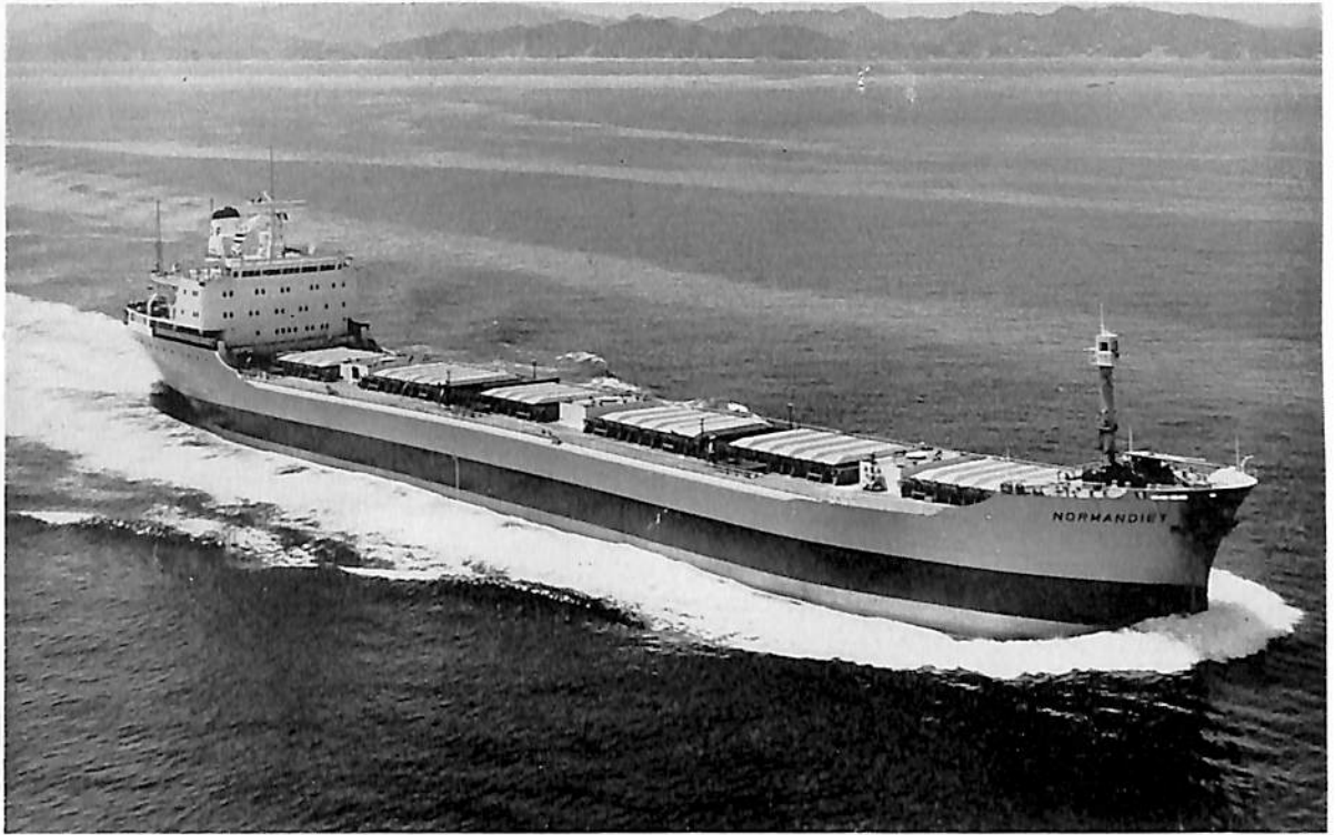
NORMANDIET (ばら積貨物船) 船主 DET DANSK FRANSICE DAMPSKIPSSLSKAB (デンマーク) 造船所 株式会社 藤永田造船所 総噸数 15,572.23 噸 純噸数 8,997.75 噸 船級 LR 載貨重量 25,046 噸 全長 178.000 m 長(垂) 168.000 m 幅(型) 22.860 m 深(型) 13.700 m 吃水 10.175 m 満載排水量 31,935 噸 主機 三井 B&W 674 VT 2 BF-160 型ディーゼル機関 1 基 出力 9,000 PS×115 RPM 速力 15.0 ノット 貨物倉容積(グレーン) 31,430.31 m 3 燃料油倉容積 1,644 m 3 清水倉容積 268 m 3 乗組員 40 名 起工 41-10-20 進水 42-1-28 竣工 42-5-8
