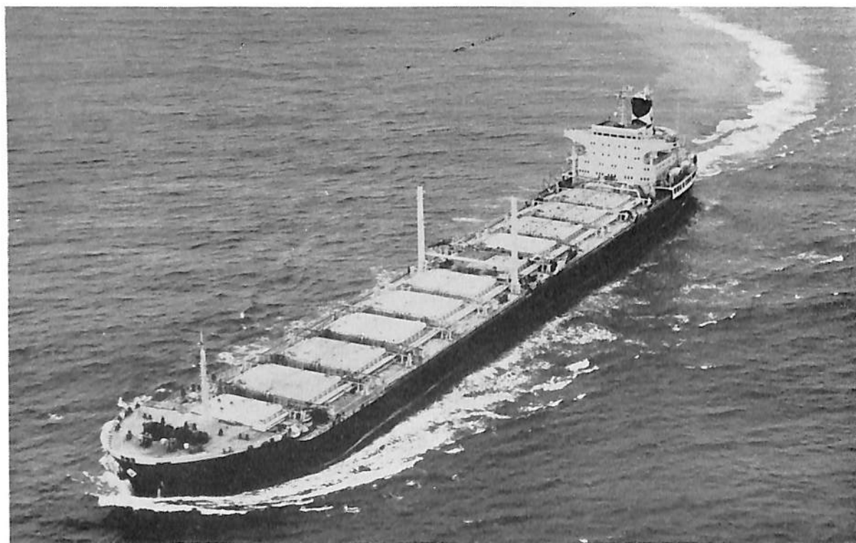
GRAFTON (ばら積兼油運搬船) 船主 PENSULAR & ORIENTAL STEAM NAVIGATION(イギリス) 造船所 日立造船・堺工場 総噸数 43,329.79噸 純噸数 27,003.79噸 船級 LR 載貨重量 73,829噸 全長 251.0m 長(垂) 244.0m 幅(型) 31.70m 深(型) 19.05m 吃水 13.8495m 満載排水量 92,915噸 主機 日立B&W984-VT2BF-180型ディーゼル機関1基 出力 17,600PS ×108RPM 速力 15.0ノット 貨物倉容積(グリーン) 82,520m 3 燃料油倉容積 4,457m 3 清水倉容積 517m 3 乗組員数 71名 起工 41-8-2 進水 42-1 8 竣工 42-4-26
