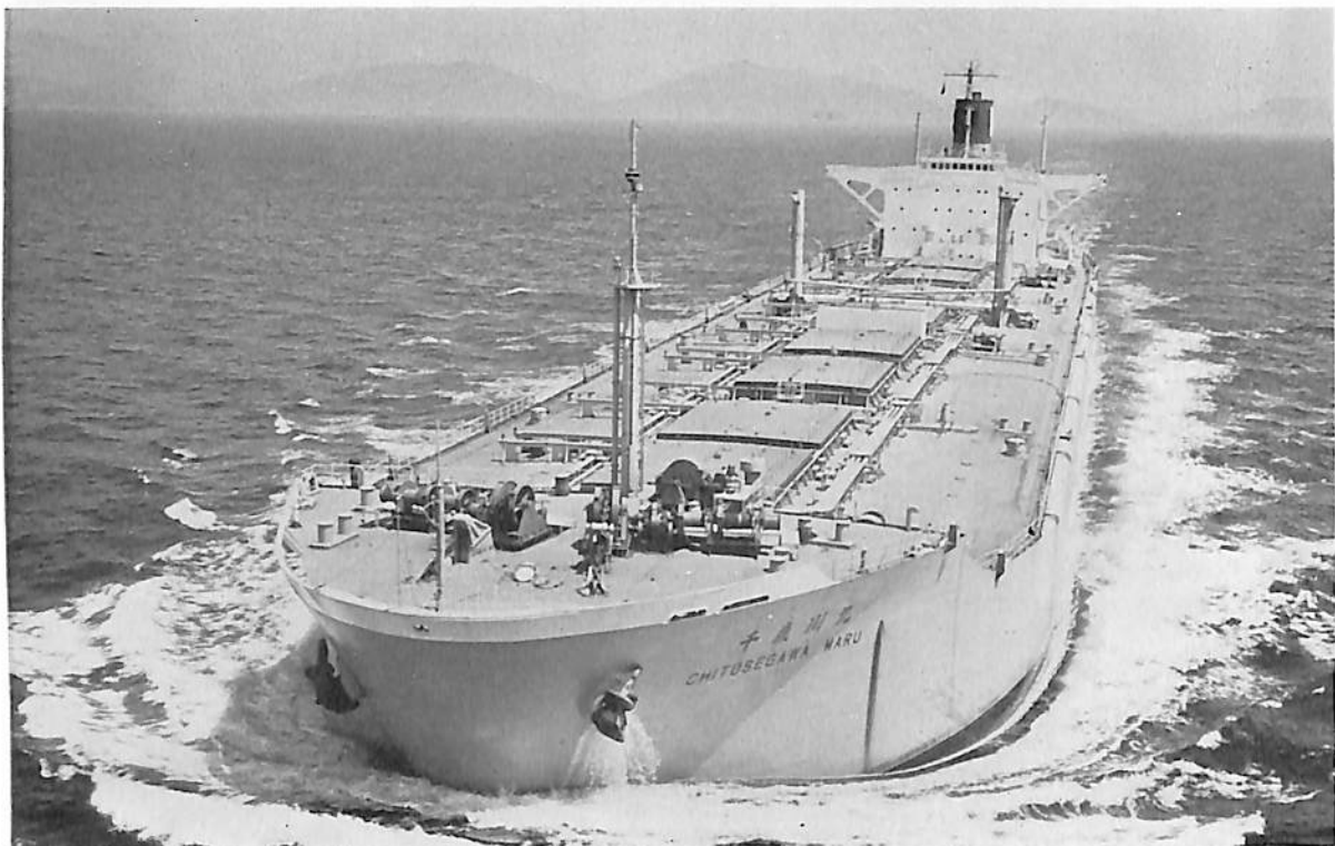
千歳川丸 (鉱石兼油運搬船) 船主 川崎汽船株式会社 造船所 三菱重工・広島造船所 長(垂) 226.0m 幅(型) 36.0m 深(型) 19.1m 吃水 12.8m 総噸数 45,000噸 載貨重量 72,900噸 速力 16.9ノット 主機 三菱スルザー 8RD90型ディーゼル機関1基 出力 18,400PS 船級 NK 起工 41-11-30 進水 42-2-26 竣工 42 5-15
