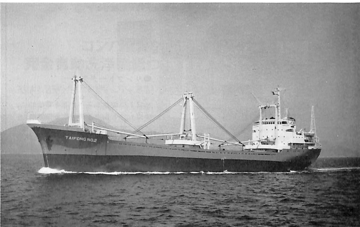
TAIFONG No.2 (貨物船) 船主 台湾海運股份有限公司(中華民國) 造船所 株式会社 来島どつく 総噸数 4,025.88 噸 純噸数 2,724.70 噸 船級 CR 載貨重量 6,353.97 噸 全長 110.90 m 長(垂) 101.00 m 幅(型) 16.40 m 深(型) 8.20 m 吃水 6.711 m 満載排水量 8,520.70 噸 主機 三菱 6UD-45 型 2 サイクル トランクピストン 型ディーゼル機関 1 基 出力 2,970 PS × 227 RPM 速力 13.2 ノット 貨物倉容積(ベール) 8,045.97 m 3 (グリーン) 8,451.19 m 3 燃料油倉容積 553.77 m 3 清水倉容積 205.97 t 乗組員 38 名 起工 41-11-16 進水 42-1-14 竣工 42-3-54
