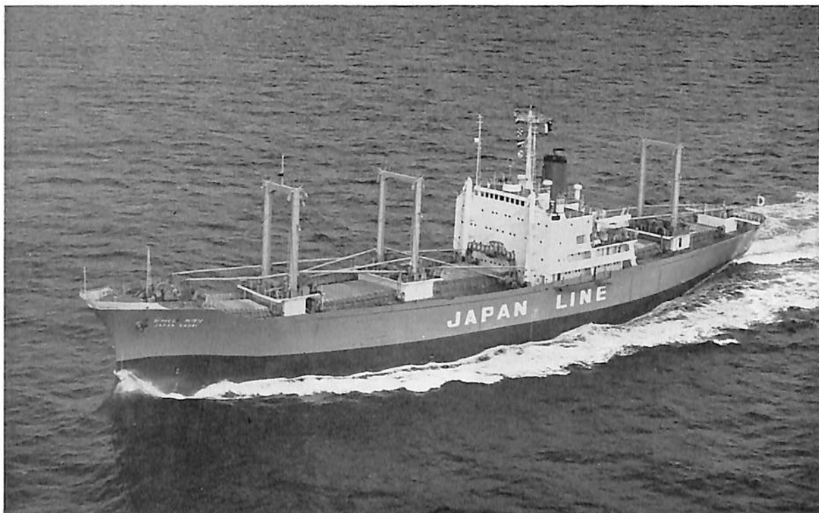
ジャパン カウリ (貨物船) 船主 ジャパンライン株式会社 造船所 石川島播磨重工・相生工場 長(垂) 130.0 m 幅(型) 19.2 m 深(型) 11.5 m 吃水 8.7 m 総噸数 7,200 噸 載貨重量 9,555 噸 速力 16.2 ノット 主機 IHI スルザー-6RD68 型ディーゼル機関1基 出力 7,200 PS 船級 NK 起工 41-9-1 進水 41-12-3 竣工 42-2-21
