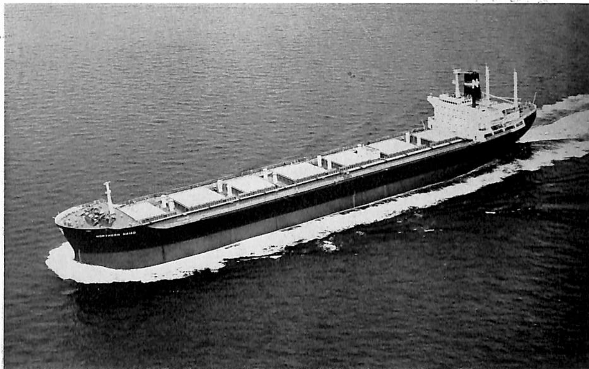
NORTHERN NAIAD (ばら積貨物船) 船主 AMBER SHIPPING CO. (リベリヤ) 造船所 三井造船・玉野造船所 長(垂) 180.00 m 幅(型) 28.956 m 深(型) 16.750 m 吃水 11.430 m 総噸数 22,599 噸 載貨重量 41,653 噸 速力(試) 16.2 ノット 主機 三井 B&W 774-VT 2 BF-160 型ディーゼル機関 1 基 出力(連続最大) 11,500 PS×119 RPM 船級 AB 起工 41-11-21 進水 42-2 竣工 42-5-12
