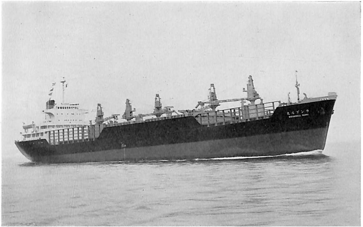
ランゲル丸 (パルプ兼木材運搬船) 船主 山下新日本汽船株式会社 造船所 日立造船・向島工場 総噸数 11,580.60 噸 純噸数 7,523.46 噸 船級 NK 載貨重量 15,830 噸 全長 149.50 m 長(垂) 140.0 m 幅(型) 21.80 m 深(型) 11.60 m 吃水 8.893 m 満載排水量 20,809 噸 主機 日立 B&W 662 VT 2 BF-140 型ディーゼル機関 1 基 出力 6,120 PS×132 RPM 速力(試) 14.2 ノット 貨物倉容積(ベール) 21,547 m 3 (グリーン) 22,673 m 3 燃料油倉容積 1,085.9 m 3 清水倉容積 602.7 m 3 乗組員数 34 名 起工 41-9-1 進水 41-12-19 竣工 42-3-17
