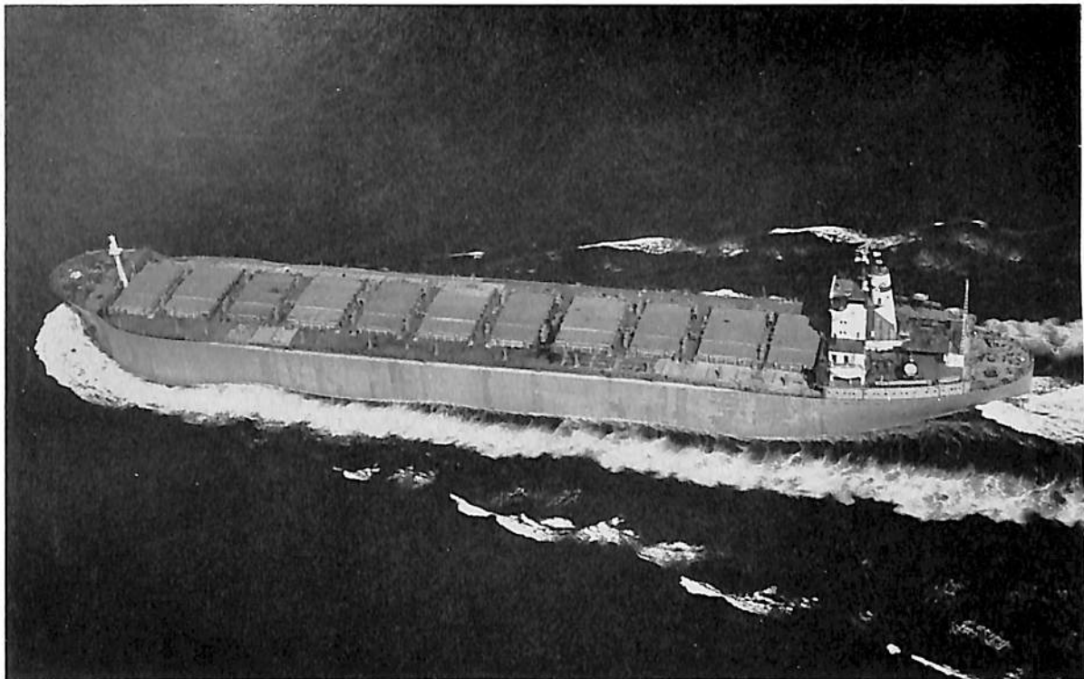
WORLD NAUTILUS (ばら積貨物船) 船主 CAPRICORN SHIPPING CO. (リベリア) 造船所 石川島播磨重工・相生工場 長(垂) 184.0 m 幅(型) 28.2 m 深(型) 16.6 m 吃水 11.325 m 総噸数 25,800 噸 載貨重量 40,098 噸 速力 14.55 ノット 主機 IHI スルザ ー 7 RD 86 型ディーゼル機関 1 基 出力 11,200 PS 船級 AB 起工 41-12-5 進水 42-2-21 竣工 42-4-24
