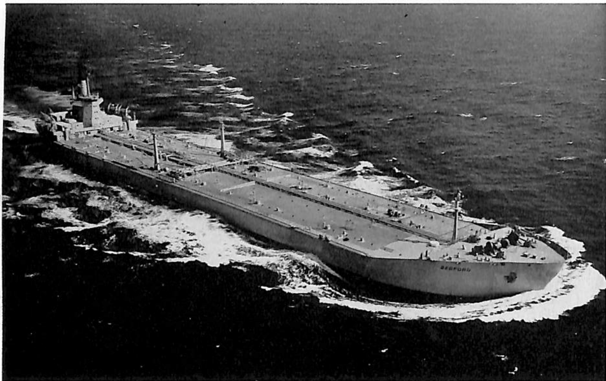
BEDFORD (油槽船) 船主 BLANDFORD SHIPPING CO. (イギリス) 造船所 佐世保重工・佐世保造船所 全長 270.00 m 長(垂) 260.00 m 幅(型) 39.00 m 深(型) 18.60 m 吃水 14.43 m 総噸数 54,059.95 噸 載貨重量 103,785.00 噸 速力 15.6 ノット 主機 IHI-GE タービン 1 基 出力(最大) 20,500 PS 船級 NV 起工 41-9-26 進水 41-12-29 竣工 42-4-26
