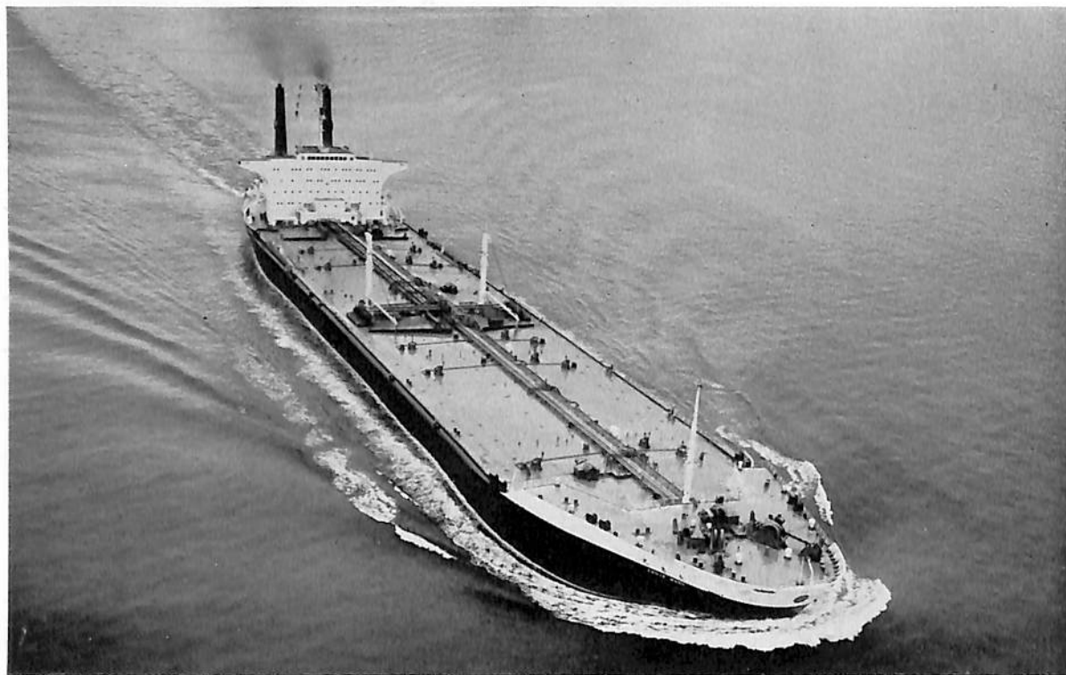
長者丸 (油槽船) 船主 シェル船舶株式会社 造船所 三菱重工・長崎造船所 長(垂) 256.0 噸 幅(型) 42.5 m 深(型) 20.6 m 吃水 15.815 m 総噸数 64,338 噸 載貨重量 122,811 噸 速力 16.4 ノット 主機 M.T.P. 出力 24,000 PS 船級 LR 起工 41-10-6 進水 41-12-25 竣工 42-4-26
