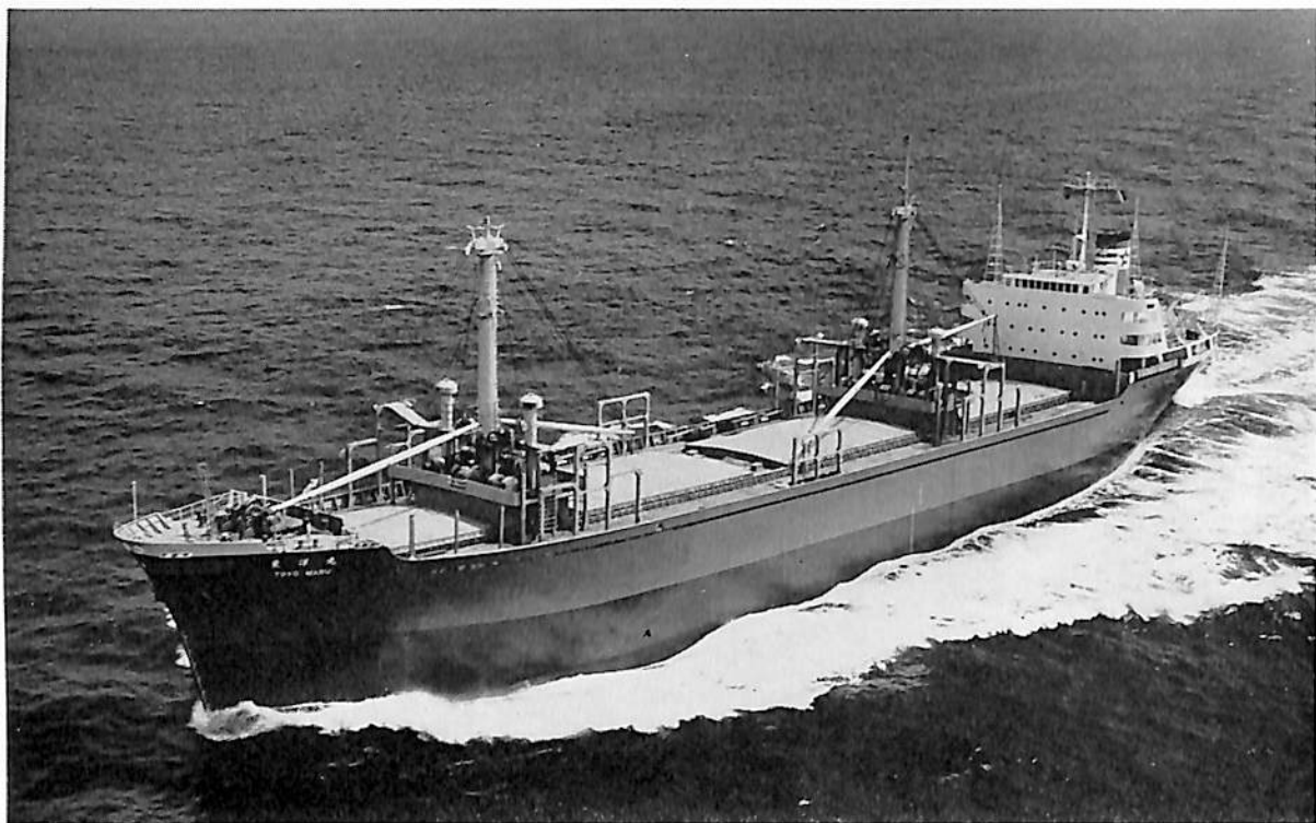
東洋丸 (木材運搬船) 船主 太平洋海運株式会社 造船所 佐世保重工・佐世保造船所 全長 139.80 m 長(垂) 130.00 m 幅(型) 21.00 m 深(型) 11.20 m 吃水 8.40 m 総噸数 8,581.19 噸 載貨重量 13,945 噸 速力(公試) 17.71 ノット 主機 三菱宇部 UEC 65 ' 135 型ディー ゼル機関 1 基 出力 7,200 PS 船級 NK 起工 41-10-31 進水 42 2 竣工 42-4-24
