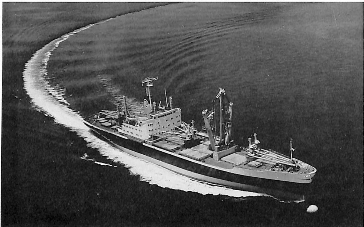
NEDER LINGE (貨物船) 船主 N.V. STOOMVAART MAATSCHAPPIJ NEDERLAND (オランダ) 造船所 日本鋼管・清水造船所 長(垂) 153.79 m 幅(型) 23.7 m 深(型) 14.0 m 吃水 8.9 m 総噸数 約 12,900 噸 載貨重量 12,000 噸 速力 約 21.0 ノット 主機 STORK sw 6× 60 / 170 型 ディーゼル機関 1 基 出力 17,000 PS×115 RPM 船級 LR 貨物倉容積(ベール) 約 18,430 m 3 ディープタンク容積 840 m 3 冷凍貨物倉容積(ベール) 1,710 m 3 起工 41-10-5 進水 42-1-21 竣工 42-6-7
