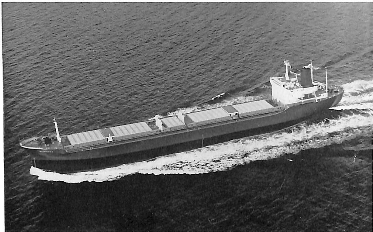
FILIPINAS 1 (ばら積貨物船) 船主 GOVERNMENT OF THE REPUBLIC OF THE PHILIPPINES. 造船所 株式会社 大阪造船所 総噸数 12,948.68 噸 純噸数 8,516.33 噸 船級 AB 載貨重量 22,073 噸 全長 165.500 m 長(垂) 156.000 m 幅(型) 23.200 m 深(型) 13.500 m 吃水 9.541 m 満載排水量 27,377 噸 主機 浦賀スルザー 6RD68型ディーゼル機関1基 出力 6,480 PS ×130 RPM 燃料消費量 26.35 LT/D 速力 13.8 ノット 貨物倉容積(ベール) 27,337.3 m 3 (グレーン) 27,859.2 m 3 燃料油倉容積 52,020 f 3 清水倉容積 21,559 f 3 乗組員 50 名 起工 41-2-4 進水 41-12-8 竣工 42-3-16 特殊設備 15 T NKK-MUNCK LOADER 2 台 装備可能
