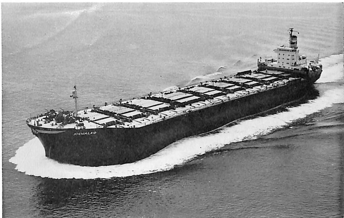
SIGWALDO (ばら積貨物船) 船主 BERGE SIGVAL BERGESEN (ノルウェー) 造船所 佐世保重工業株式会社 全長 224.00 m 長(垂) 213.62 m 幅(型) 35.82 m 深(型) 19.00 m 吃水 11.836 m 総噸数 42,410.65 噸 載貨重量 69,492.00 噸 速力 15.5 ノット 主機 佐世 保ゲタベルゲン DM 850 /1700 VGA-8 U型ディーゼル機関1基 出力(最大) 19,200 PS 船級 NV 起工 41-11-21 進水 42-3-10 竣工 42-7-6
