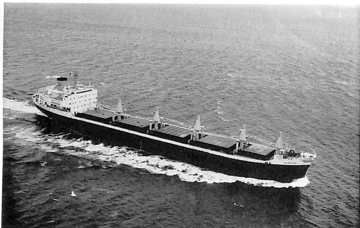
SILVERCAPE (ばら積貨物船) 船主 ST. HELEN'S SHIPPING CO., LTD, (ENGLAND) 造船所 株式会社 名村造船所 総噸数 12,669.17 噸 純噸数 7,561.31 噸 船級 LR 載貨重量 18,911 噸 全長 157.15 m 長(垂) 148.00 m 幅(型) 22.50 m 深(型) 12.90 m 吃水 9.318 m 満載排水量 24,415 噸 主機 三井 B&W 762 VT 2 BF-140 型ディーゼル機関 1 基 出力 7,650 PS× 135 RPM 速力 14.9 ノット 燃料消費量 31.65 kt/d 貨物倉容積(ペール) 25,940 m 3 (グリーン) 26,729 m 3 燃料油倉容積 1,660.1 m 3 清水倉容積 264.4 m 3 乗組員数 63 名 起工 41-10-20 進水 42-2-25 竣工 42-5-16
