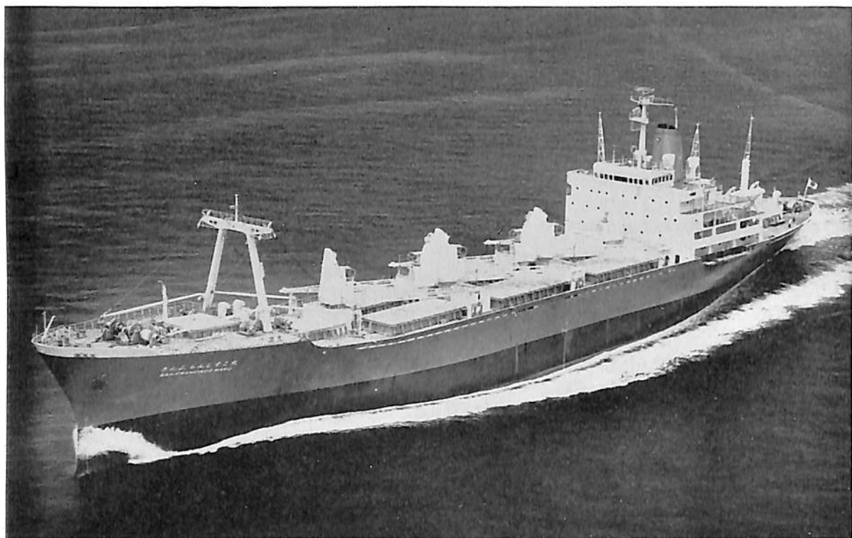
さんふらんしすこ丸 (貨物船) 船主 大阪商船三井船舶株式会社 造船所 日立造船・因島工場 全長 155.75 m 長(垂) 145.00 m 幅(型) 21.80 m 深(型) 13.20 m 吃水 9.00 m 総噸数 10,457.49 噸 載貨重量 11,740.00 噸 速力(試) 22.878 ノット 主機 日立 B&W 774-VT 2 BF-160 型ディーゼル機関 1 基 出力(最大) 11,200 PS 船級 NK 乗組員数 42 名 起工 41-12-26 進水 42-3-25 竣工 42-7-17
