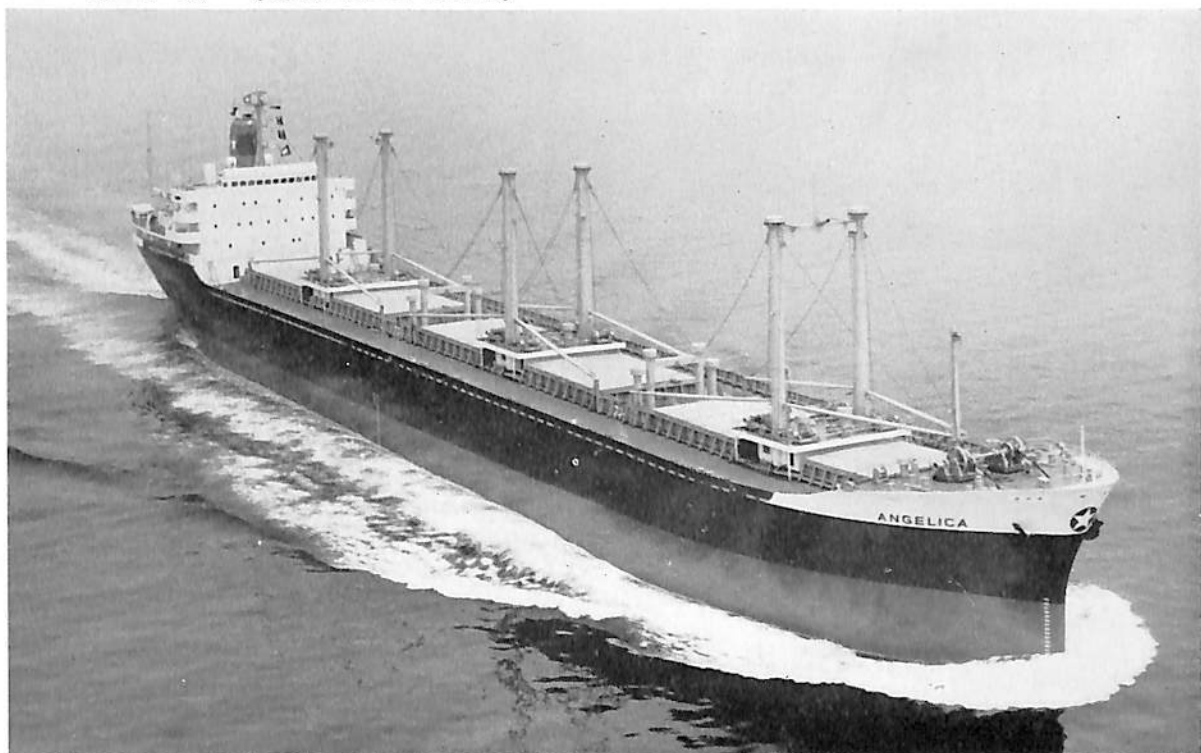
ANGELICA (ばら積貨物船) 船主 INTERNATIONAL MARINE DEVELOPMENT CORP. (リベリア) 造船所 株式会社 藤永田造船所 総噸数 15,362.49 噸 純噸数 9,602 噸 船級 AB 載貨重量 25,037 噸 全長 176.60 m 長(垂) 168.00 m 幅(型) 23.20 m 深(型) 13.95 m 吃水 9.903 m 満載排水量 31,460 噸 主機 浦賀スルザー 7 RD 76 型ディーゼル機関 1 基 出力 10,080 PS×118 RPM 速力 15.5 ノット 貨物倉容積(グリーン) 1,195.385 m 3 燃料油倉容積 1,713.2 LT 清水倉容積 420.3 LT 乗組員数 48 名 起工 42-1-9 進水 42-3-30 竣工 42-7-7
