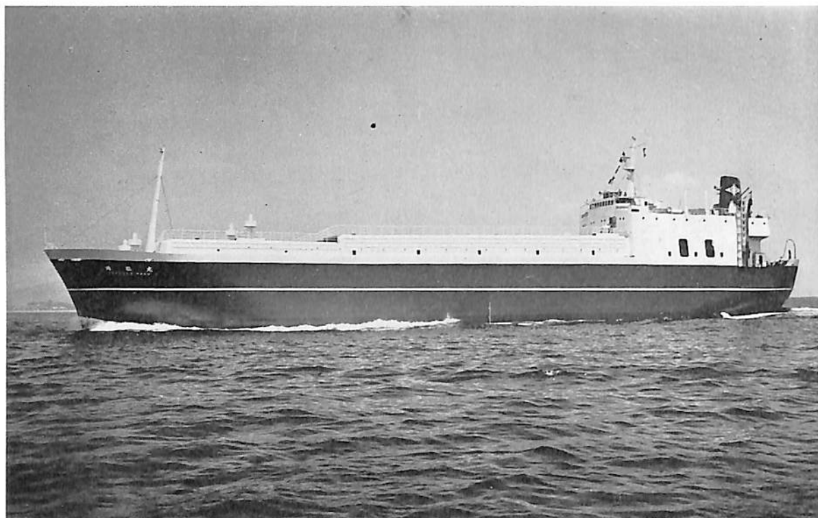
勇 弘 丸 (自動車運搬船) 船主 株式会社 ジャパン近海 造船所 株式会社 金指造船所 総噸数 3,486.14 噸 純噸数 2,618.18 噸 載貨重量 1,294.69 噸 全長 99.19 m 長(垂) 91.15 m 幅(型) 12.50 m 深(型) 10.20 m 吃水 4.30 m 満載排水量 3,872.88 噸 主機 伊藤鉄工所製 M477 LHS ディーゼル機関1基 出力 2,550 PS×237 RPM 速力 13.00 ノット 貨物倉容積(グリーン) 8,087 m 3 燃料油倉容積 230.58 m 3 清水倉容積 173.0 m 3 乗組員数 19 名 起工 41-11-21 進水 42-4-9 竣工 42-6-12 (甲板5層, 中型乗用車 409 台, 船内自走斜路方式)
