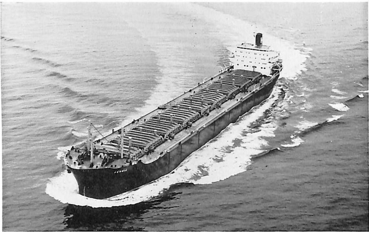
FERNIE ((ばら積貨物船) 船主 PENINSULAR & ORIENTAL STEAM NAVIGATION COMPANY (イギリス) 造船所 三井造船・玉野造船所 長(垂) 251.473 m 幅(型) 32.207 m 深(型) 18.593 m 吃水 13.608 m 総噸数 42,445.50 噸 載貨重量 74,422.00 噸 速力 16.0 ノット 主機 三井 B&W 984-VT 2 BF-180 型ディーゼル機関 1 基 出力(最大) 20,700 PS×114 RPM 船級 LR 起工 41- 10-5 進水 42-1-19 竣工 42-6-22
