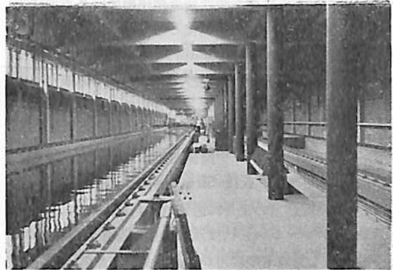
写真1 水槽室内。窓は北側だけにあり、所々に排 気扇がついていて、暖房中でも一日中廻されてい る。左側が主水槽で手前が造波機側、右が回流兼 浅水々槽で、レンガの仕切りが見える。壁もレン ガ造り、この2階が研究室になつている。
