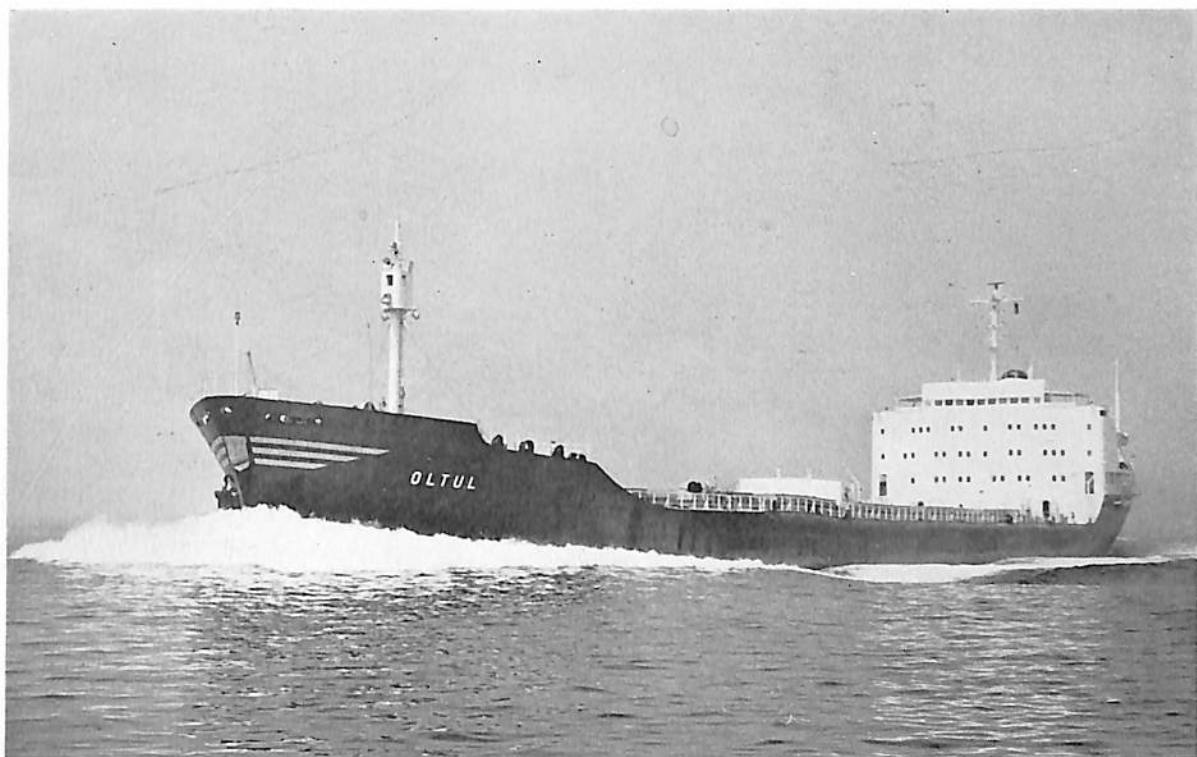
OLTUL (鉍石運搬船) 船主 INDUSTRIALEXPORT.(ルーマニア) 造船所 日立造船・因島工場 総噸数 16,601.01噸 純噸数 5,380.0噸 船級 LR 載貨重量 25,829噸 全長 181.10m 長(垂) 172.00m 幅(型) 24.80m 深(型) 12.90m 吃水 9.50m 満載排水量 32,540噸 主機 日立 B&W 774-VT 2BF-160型ディーゼル機関1基 出力 10,500 PS×115 RPM 速力 16.0ノット 貨物 倉容積(グリーン) 13,017.69 m 3 燃料油倉容積 2,723.31 m 3 清水倉容積 408.72 m 3 乗組員数 54名 起工 42-3-2 進水 42-5-9 竣工 42-7-26 同型船 CARPATI 外5隻
