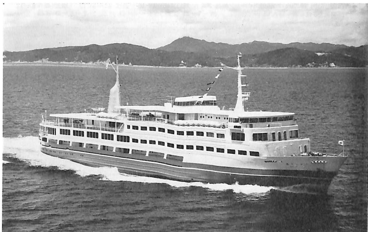
こぼると丸 (旅客船) 船主 関西汽船株式会社 造船所 三菱重工・神戸造船所 長(垂) 82.00 m 幅(型) 13.40 m 深(型) 6.25 m 吃水 3.90 m 総噸数 2,998.52 噸 速力(最大) 21.49 ノット 主機 三菱 8 UET 39 /65 C 型ディーゼル機関 2 基 出力(最大) 3,500 PS×2 旅客定員 特別室 2 名, 特等室 40 名, 1 等室 152 名, 特 2 等室 185 名, 2 等室 901 名, 計 1,280 名 乗組員数 70 名 起工 42-1-24 進水 42-5-10 竣工 42-8-7 同型船 あいぼり丸
