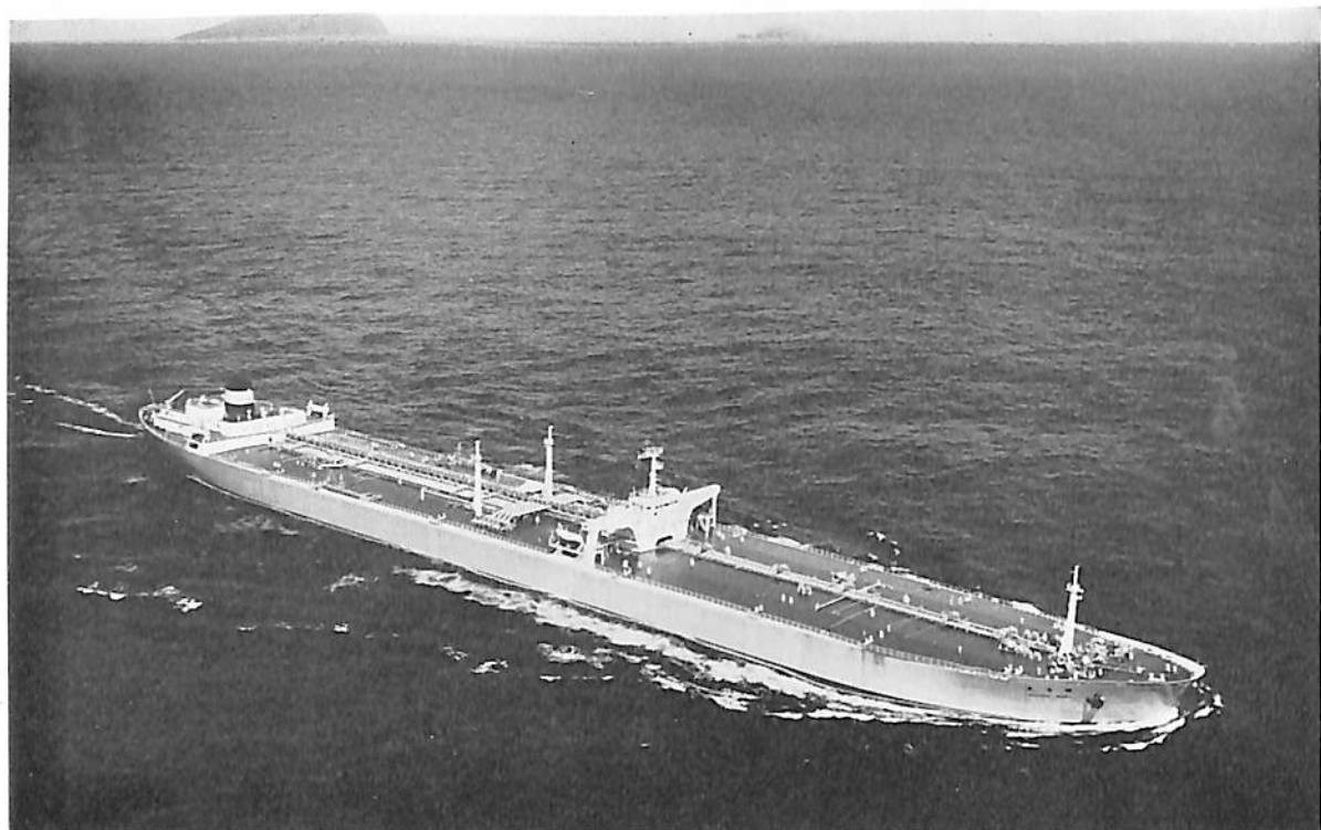
明 扇 丸 (油 槽 船) 船 主 明 治 海 運 株 式 会 社 造 船 所 三 井 造 船 ・ 千 葉 造 船 所 長(垂) 304.00 m 幅(型) 44.00 m 深(型) 24.20 m 吃水 16.00 m 総噸数 約 89,700 噸 載貨重量 約 150,000 噸 載貨容積 約 186,000 m 3 速力(滿載) 16.5 ノット 主機 IHI-タービン 出力(常用) 25,200 PS×101 RPM 船級 NK 起工 42-1-16 進水 42-5-22 竣工 42-8-12 乗組員 38 名
