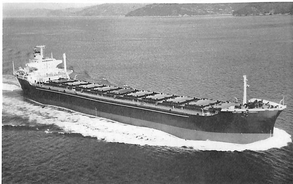
CAPTAIN W.D. CARGILL (ばら積貨物船) 船主 VICTORIA MARINE CO. (リベリア) 造船所 株式会社 呉造船所 全長 223.94 m 長(垂) 213.00 m 幅(型) 32.225 m 深(型) 19.00 m 吃水 12.217 m 総噸数 35,302.98 噸 載貨重量 56,278.00 噸 速力 15.6 ノット 主機 IHI-スルザー 6 RD 90 型ディーゼル機関 1 基 出力 14,400 PS 船級 AB 起工 42-1-10 進水 42-4-10 竣工 42-7-27
