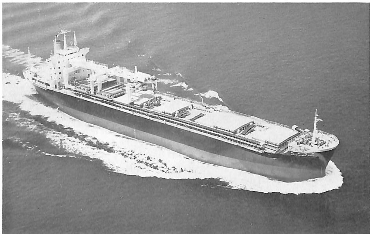
中越山丸 (チップ運搬船) 船主 大阪船舶株式会社・大阪商船三井船舶株式会社 造船所 三井造船・玉野造船所 長(垂) 166.00 m 幅(型) 25.60 m 深(型) 17.00 m 吃水 10.74 m 総噸数 20,072.79 噸 載貨重量 28,210.00 噸 速力(連続最大) 15.55 ノット 主機 三井 B&W 674 VT 2 BF-160型ディーゼル機関1基 出力(連続最大) 9,010 PS×119 RPM 船級 NK 起工 42-3-15 進水 42-5-10 竣工 42-7-29
