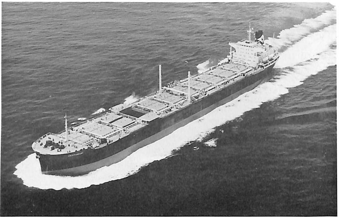
HEYTHROP (ばら, 油, 運搬船) 船主 PENINSULAR & ORIENTAL STEAM NAVIGATION CO. (英国) 造船所 日立造船・堺工場 総噸数 43,329.79 噸 純噸数 27,028.92 噸 船級 LR 載貨重量 74,981.00 噸 全長 251.00 m 長(垂) 244.00 m 幅(型) 31.70 m 深(型) 19.05 m 吃水 13.8595 m 満載排水量 92,915 噸 主機 日立 B&W 984-VT 2 BF-180 型ディーゼル機関 1 基 出力 17,600 PS×108 RPM 燃料消費量 66.3 t/d 速力 15.0 ノット 燃料油倉容積 4,457 m 3 清水倉容積 517 m 3 乗組員 68 名 起工 41-12-3 進水 42-3-26 竣工 42-6-30 同型船 GRAFTON
