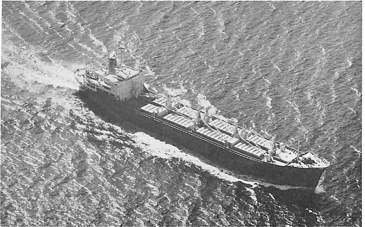
りおぐらんで丸 (貨物船) 船主 大阪商船三井船舶株式会社 造船所 佐野安船渠株式会社 総噸数 7,895.27噸 純噸数 4,830.12噸 船級 NK 載貨重量 11,420噸 全長 139.95m 長(垂) 130.00m 幅(型) 19.00m 深(型) 11.50m 吃水 8.727m 主機 三井 B&W 662 VT 2 BF-140 型ディーゼル機関1基 出力 7,200 PS×139 RPM 速力 15.4ノット 貨物倉容積(ベール) 14,822.5 m 3 (グレーン) 15,898.3 m 3 乗組員数 40名 起工 42-2-3 進水 42-5-24 竣工 42-8-4
