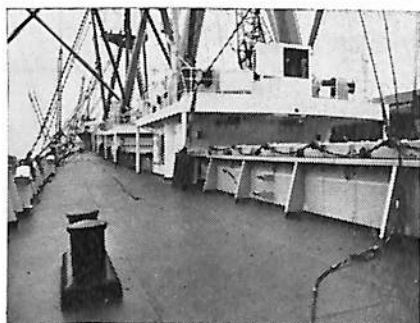
露天甲板用マック・グレゴ シングル・プル型ハッチカバー
