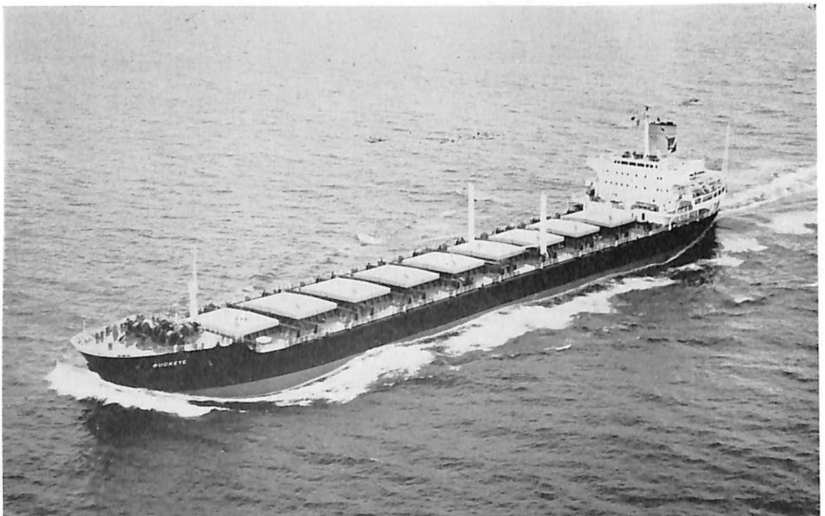
BUCKEYE (ばら, 鉱石, 原油運搬船) 船主 TANKORE CORP. (パナマ) 造船所 三菱重工・神戸造船所 長(垂) 194.00 m 幅(型) 28.90 m 深(型) 16.80 m 吃水 10.97 m 総噸数 27,400 噸 載貨重量 40,480 噸 速力(試) 15.9 ノット 主機 三菱スルザー 6RD 90 型ディーゼル機関 1 基 出力(最大) 15,800 PS 船級 AB 起工 41-12-5 進水 42-3-10 竣工 42-7-12
