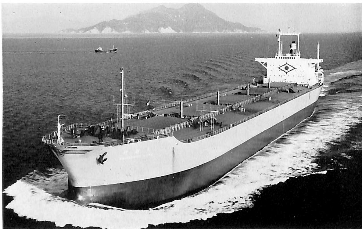
神 旭 丸 (鉾石運搬船) 船主 日本郵船株式会社 造船所 三菱重工・広島造船所 長(垂) 211.0 m 幅(型) 31.8 m 深(型) 17.5 m 吃水 11.7 m 総噸数 35,000 噸 載貨重量 55,950 噸 速力 14.8 ノット 主機 三菱 6 UEC 85 / 160 C 型ディーゼル機関 1 基 出力 14,400 PS 船級 NK 起工 42-2-3 進水 42-6-6 竣工 42-8-31
