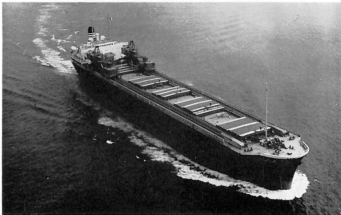
本 州 丸 (チップ運搬船) 船主 日本郵船株式会社 造船所 日本鋼管・清水造船所 長(垂) 153.0 噸 幅(型) 23.7 m 深(型) 17.0 m 吃水 9.7 m 総噸数 17,500 噸 載貨重量 22,000 噸 速力 15.9 ノット 主機 三菱 6 UEC 65 / 135 C 型ディーゼル機関 1 基 出力 8,100 PS ×145 RPM 船級 NK 起工 42-3-31 進水 42-6-7 竣工 42-9-2
