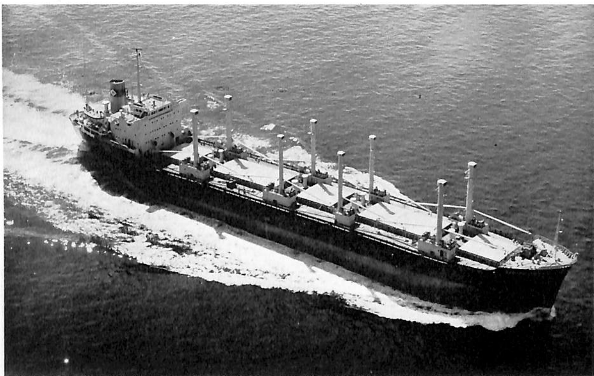
MARITIME LEADER (ばら積貨物船) 船 主 CAMBRIDGE NAVIGATION (パナマ) 造 船 所 佐 野 安 船 渠 株 式 会 社 総 噸 数 9,547.90 噸 純 噸 数 6,124.74 噸 載 貨 重 量 16,299.00 噸 全 長 147.52 m 長 (垂) 140.00 m 幅 (型) 20.56 m 深 (型) 12.55 m 吃 水 9.057 m 主 機 川 崎 M A N K 6 Z 70 / 120 C 型 デ ィ ー ゼ ル 機 関 1 基 出 力 7,200 P S × 135 R P M 速 力 14.4 ノ ッ ト 貨 物 倉 容 積 (グ レ ー ン) 20,702.2 m 3 乗 組 員 50 名 起 工 42-4-20 進 水 42-6-28 竣 工 42-8-30
