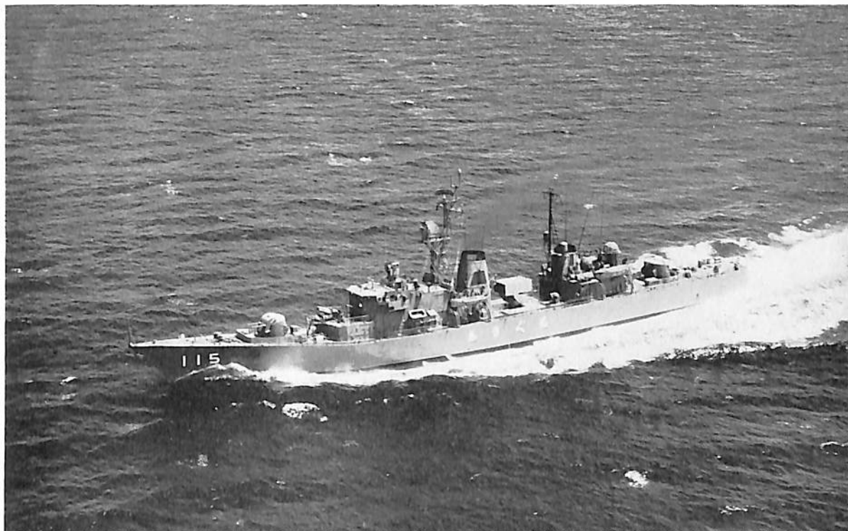
あ さ ぐ も (護 衛 艦) 船 主 防 衛 庁 造 船 所 舞 鶴 重 工 ・ 舞 鶴 造 船 所 長 さ 114.0 m 幅 11.8 m 深 さ 7.9 m 吃 水 3.9 m 基 準 排 水 量 2,050.00 噸 速 力 27 ノ ッ ト 主 機 12 U E U デ ィ ー ゼ ル 機 関 6 基 軸 数 2 軸 軸 出 力 26,500 P S 乗 組 員 数 210 名 兵 装 50 口 徑 3 イ ン チ 速 射 砲 × 2 ア ス ロ ッ ク ラ ン チ ャ ー × 1 ボ フ ォ ー ス ロ ケ ッ ト ラ ン チ ャ ー × 1 短 魚 雷 発 射 管 × 2 起 工 40-6-24 進 水 41-11-25 竣 工 42-8-29
