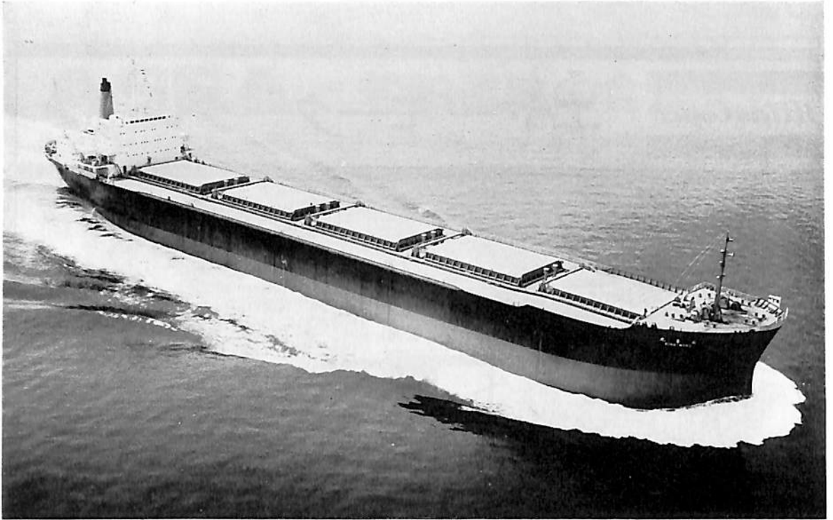
永 豪 丸 (石炭運搬船) 船主 山下新日本汽船株式会社 造船所 日立造船・因島工場 総噸数 26,080.83 噸 純噸数 16,447.14 噸 船級 NK 載貨重量 41,145 噸 全長 193.00 m 長(垂) 183.00 m 幅(型) 29.60 m 深(型) 16.40 m 吃水 11.00 m 滿載排水量 49,760 噸 主機 日立 B&W 874-VT 2 BF-160 型ディーゼル機関 1 基 出力 11,200 PS×113 RPM 速力 15.38 ノット 貨物倉容積(グレーン) 53,200.22 m 3 燃料油倉容積 2,831.45 m 3 清水倉容積 683.36 m 3 旅客数 2 名 乗組員数 35 名 起工 41-12-21 進水 42-5-28 竣工 42-8-10
