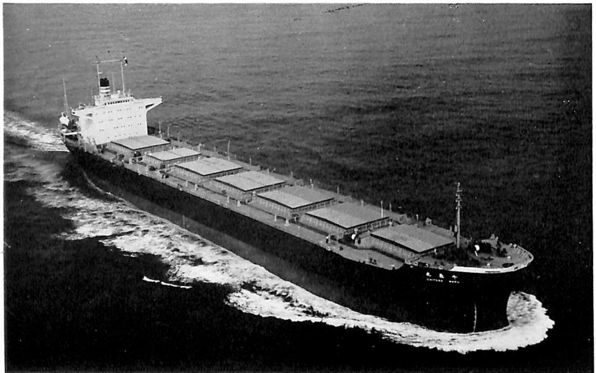
千 歳 丸 (石炭運搬船) 船主 日本郵船株式会社 造船所 日本鋼管・鶴見造船所 長(垂) 184.0 m 幅(型) 29.5 m 深(型) 16.1 m 吃水 10.95 m 総噸数 24,000 噸 載貨重量 41,350 噸 速力 14.2 ノット 主機 NKK SEMT ピールスチック 12 PC 2 V 型ディーゼル機関 1 基 出力 10,600 PS×112 RPM 船級 NK 起工 42-1-27 進水 42-6-14 竣工 42-9-7
