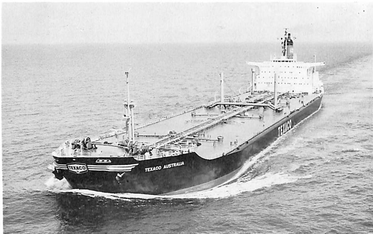
TEXACO AUSTRALIA (油槽船) 船主 OCEAN TANKSHIP.(リベリア) 造船所 三菱重工・長崎造船所 長(垂) 223.0m 幅(型) 37.2m 深(型) 17.8m 吃水 12.82m 総噸数 41,186.79噸 載貨重量 78,170.00噸 速力 15.8ノット 主機 三菱MTP 出力 19,000PS 船級 AB 起工 42-2-15 進水 42-5-5 竣工 42-8-31
