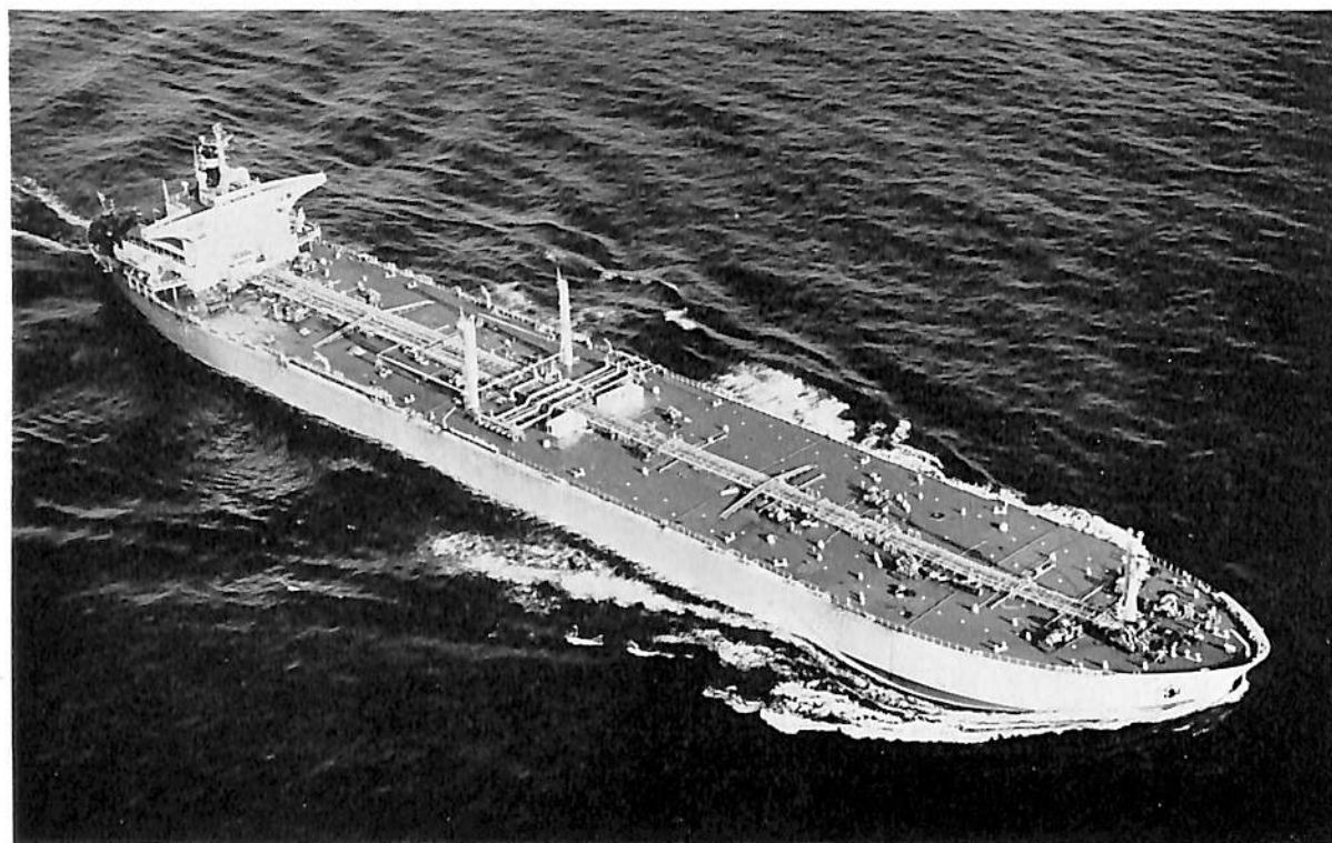
昭 洋 丸 (油槽船) 船主 大洋商船株式会社 造船所 佐世保重工業・佐世保造船所 全長 294.00m 長(垂) 281.00m 幅(型) 46.20m 深(型) 25.00m 吃水 16.60m 総噸数 96,229.58噸 載貨重量 153,140.00噸 荷油槽容積 191,698m 3 速力 15.55ノット 主機 三菱 ウェスティングタービン1基 出力 28,000PS 船級 NK 起工 42-4-7 進水 42-6-1 竣工 42-9-12
