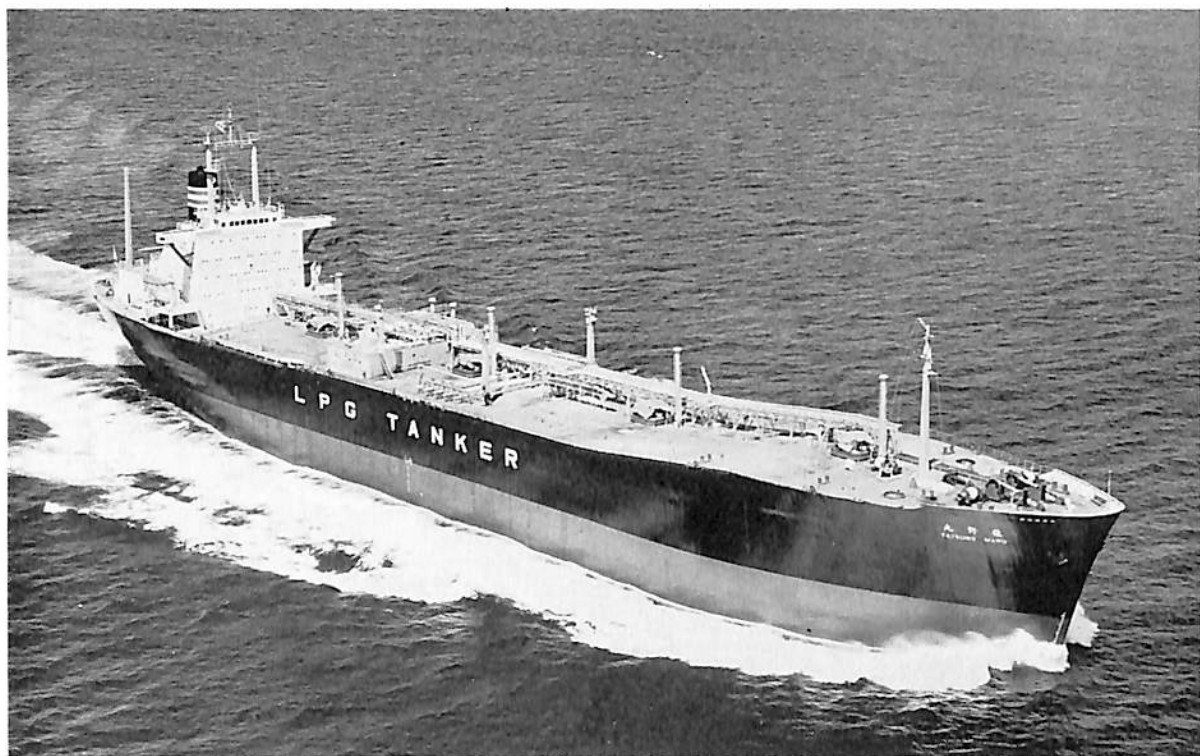
龍野丸 (LPG 運搬船) 船主 日本郵船株式会社 造船所 三菱重工・横浜造船所 総噸数 31,137.47 噸 純噸数 20,265.34 噸 船級 NK 載貨重量 38,628 噸 全長 202.12 m 長(垂) 190.00 m 幅(型) 30.00 m 深(型) 19.90 m 吃水 11.825 m 主機 三菱長崎 UEC ディーゼル機関 1 基 出力 12,240 PS×119 RPM 燃料消費量 45.5 t/d 速力 15.5 ノット 貨物油倉容積 50,670 m 3 燃料油倉容積 2,319.7 m 3 清水倉容積 704.3 m 3 乗組員 39 名 起工 41-11-30 進水 42-2-26 竣工 42-8-25
