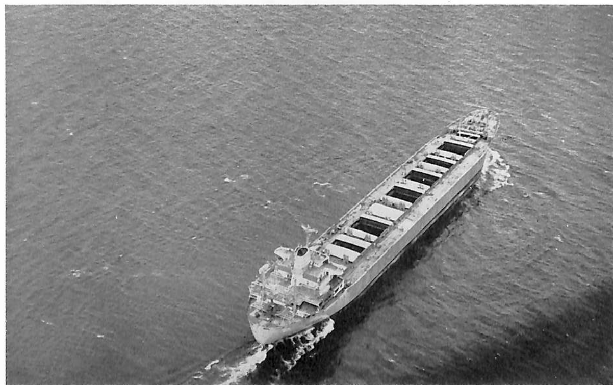
FOTINI L" (ばら積貨物船) 船主 ELCAPITAINE INC. (リベリア) 造船所 函館ドック・函館造船所 総噸数 36,364.49 噸 純噸数 27,193 噸 船級 AB 載貨重量 74,203 噸 全長 261.56 m 長(垂) 243.84 m 幅(型) 32.31 m 深(型) 18.30 m 吃水 13.545 m 満載排水量 90,153 噸 主機 浦賀スルザー9 RD 96型ディーゼル機関1基 出力 18,630 PS×115 RPM 速力 16.25 ノット 貨物倉容積(ベール) 2,931,623 ft 3 (グレーン) 2,961,329 ft 3 燃料油倉容積 170,893 ft 3 清水倉容積 11,857 ft 3 乗組員 41 名 起工 41-12-10 進水 42-6-24 竣工 42-9-21
