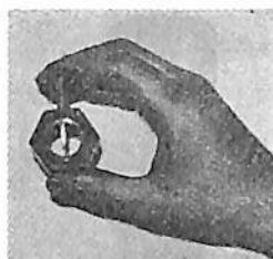
第6図 機械ナットにヒルティ銃を押し込んだところ、このような狭い面にも何の危険もなく仕事ができる。
