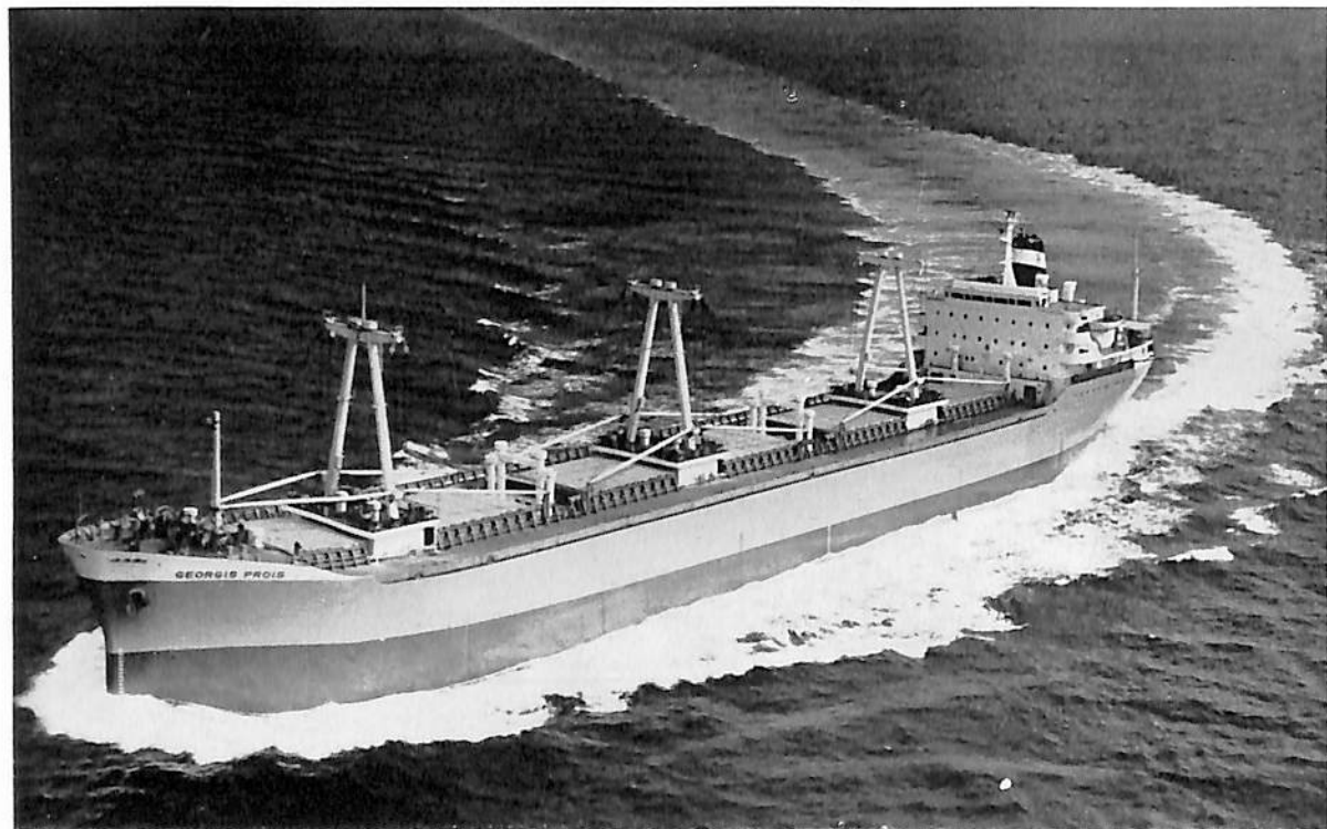
GEORGIS PROIS (ばら積貨物船) 船主 MARFO COMPANIA (パナマ) 造船所 三井造船・藤永田造船所 総噸数 15,413.71 噸 純噸数 9,648 噸 船級 AB 載貨重量 25,055 噸 全長 176.60 m 長(垂) 168.00 m 幅(型) 23.20 m 深(型) 13.95 m 吃水 9.90 m 満載排水量 31,460 噸 主機 浦賀 スルザー 7 RD 76 型ディーゼル機関 1 基 出力 10,080 PS×118 RPM 速力 15.5 ノット 貨物 倉容積(グリーン). 1,195.385 cf 燃料油倉容積 1,713.2 LT 清水倉容積 420.3 LT 乗組員 44 名 起工 42-4-5 進水 42-6-26 竣工 42-9-28 同型船 MARGARITE
