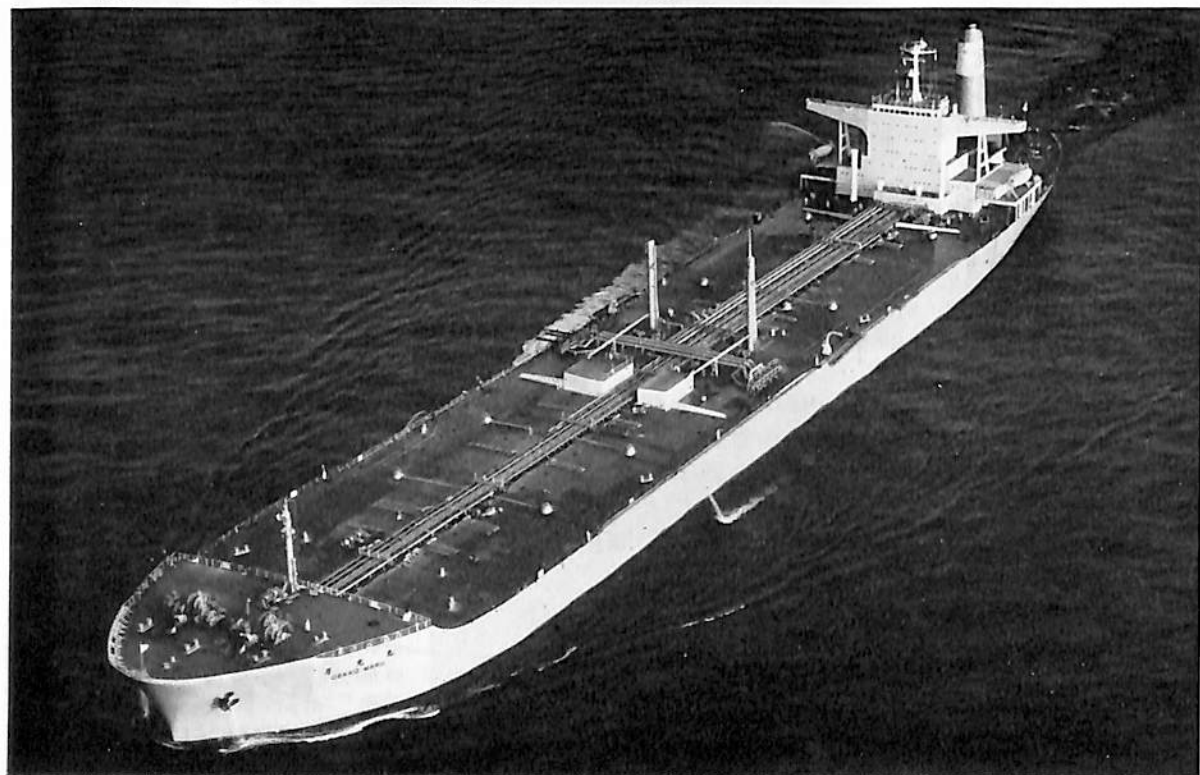
月 光 丸 (油 槽 船) 船 主 三光汽船株式会社 造船所 日立造船・堺工場 総噸数 77,041.32 噸 純噸数 49,610.5 噸 船級 NK 載貨重量 137,108 噸 全長 288.0 m 長(垂) 274.0 m 幅(型) 45.6 m 深(型) 21.6 m 吃水 15.38 m 満載排水量 159,563 噸 主機 日立 B&W 1284-VT 2 BF-180 型ディーゼル機関 1 基 出力 25,200 PS×110 RPM 速力 15.6 ノット 貨物油倉容積 160,248.9 m 3 燃料油倉容積 6,134.1 m 3 清水倉容積 1,058 m 3 乗組員数 38 名 起工 42-3-6 進水 42-7-17 竣工 42-9-13
