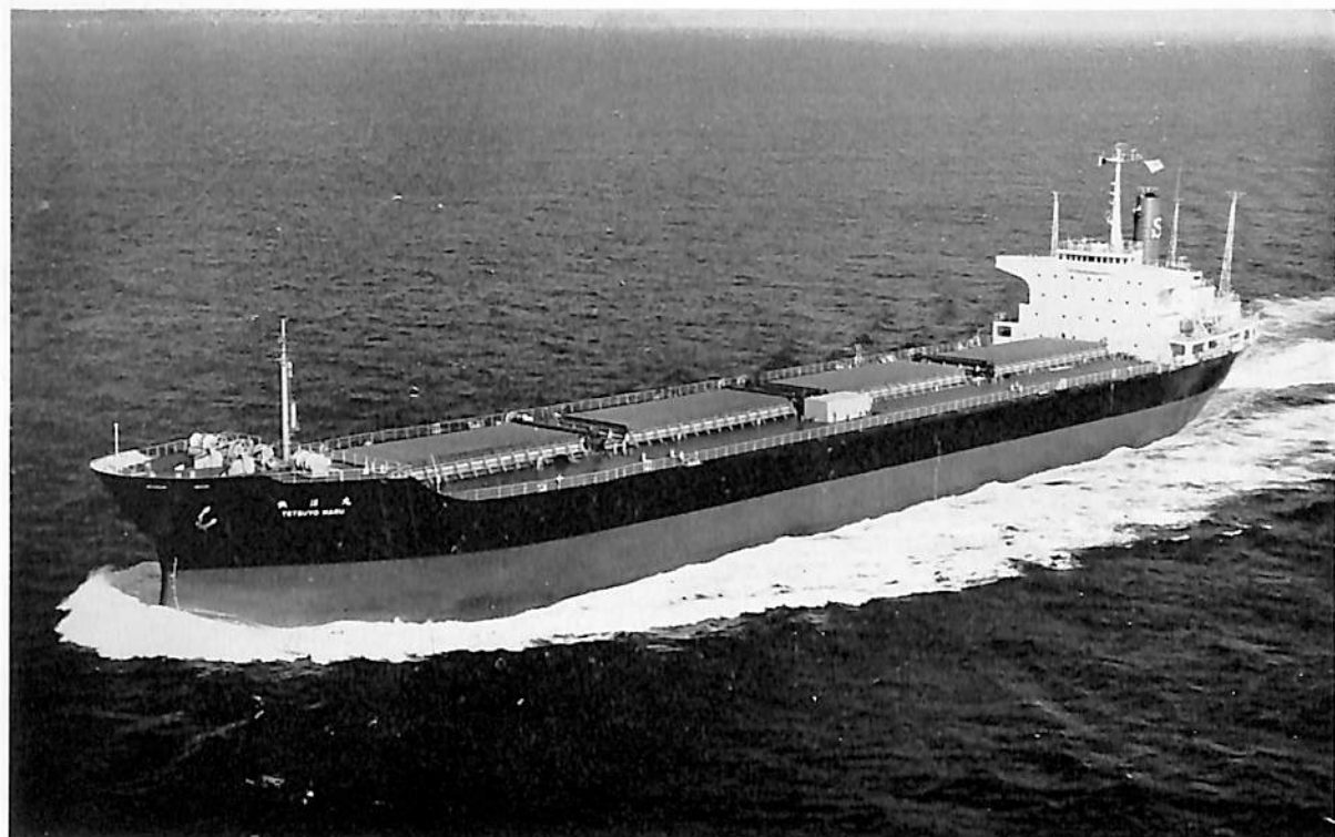
鉄 洋 丸 (鉄鉱運搬船) 船主 新和海運株式会社 造船所 佐世保重工・佐世保造船所 全長 192.60 m 長(垂) 183.00 m 幅(型) 30.00 m 深(型) 15.00 m 吃水 10.03 m 総噸数 25,329.99噸 載貨重量 38,272.00噸 速力(試) 16.7 ノット 主機 佐世保ゲタベルケン DM 750/1600 VGS-6 U型ディーゼル機関1基 出力(最大) 11,400 PS 船級 NK 起工 42-2-15 進水42-7 竣工 42-9-30
