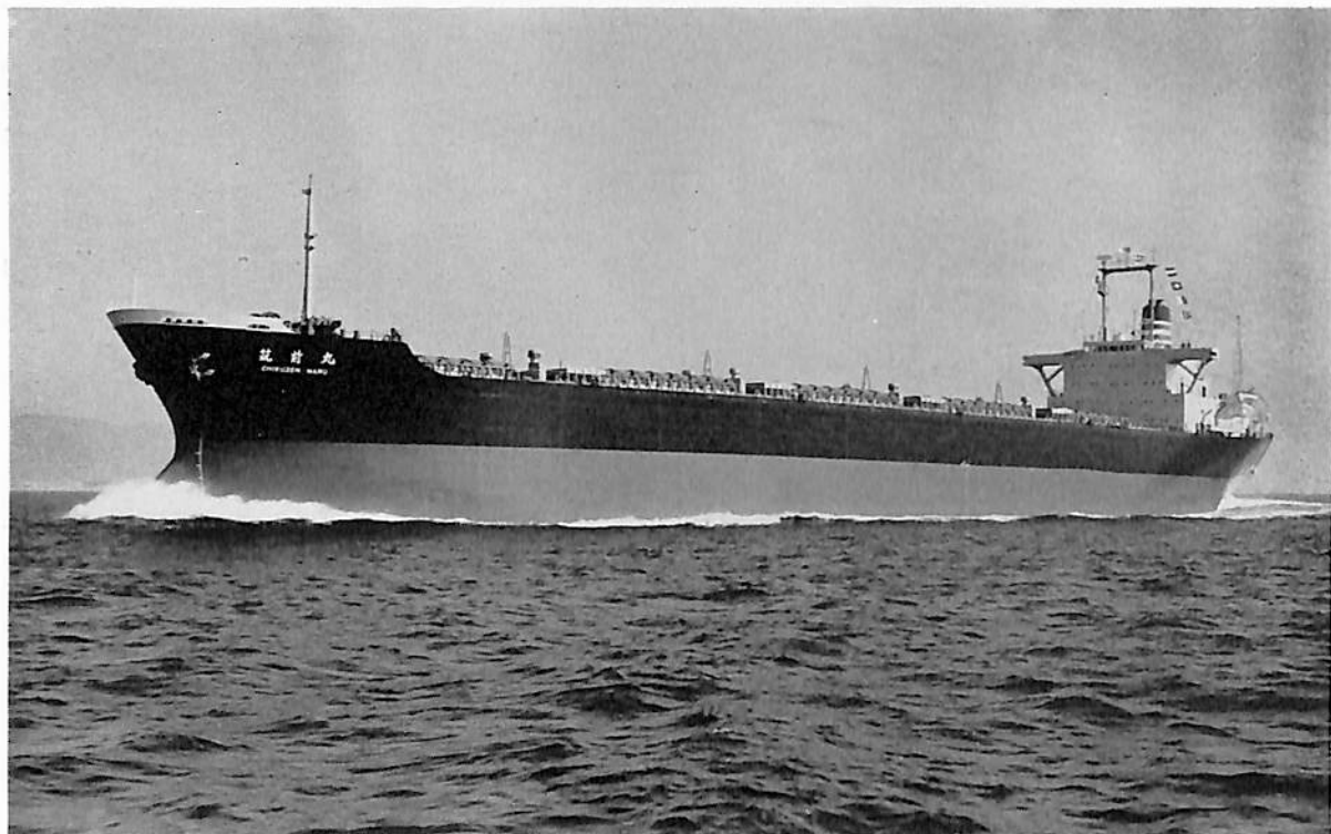
筑 前 丸 (ばら積貨物船) 船主 日本郵船株式会社 造船所 三菱重工・神戸造船所 長(垂) 184.0 m 幅(型) 29.5 m 深(型) 16.7 m 吃水 11.0 m 総噸数 25,782.61 噸 載貨重量 41,643 噸 速力(試) 16.26 ノット 主機 三菱スルザー6 RD 76型ディーゼル機関1基 出力(最大) 9,600 PS 船級 NK 起工 42-3-9 進水 42-7 竣工 42-9-30
