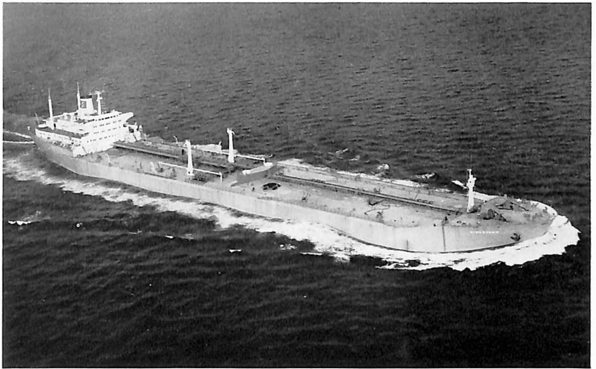
GIMLEVANG (油槽船) 船主 A/S HAANES REDERI (ノルウェー) 造船所 三井造船・玉野造船所 長(垂) 234.696 m 幅(型) 36.881 m 深(型) 17.221 m 吃水 13.295 m 総噸数 42,449.77 噸 載貨重量 79,582.00 噸 速力(試) 16.92 ノット 主機 三井 B&W 984-VT 2 BF-180 型ディーゼル機 関 1 基 出力(連続最大) 20,700 PS×114 RPM 船級 NV 乗組員 43 名 起工 42-4-15 進水 42-7 竣工 42-10-12
