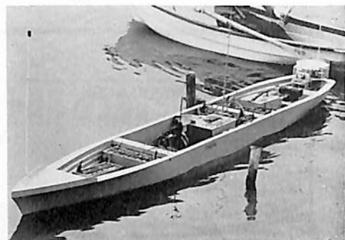
模型試験——進路安定性、操縦性試験
