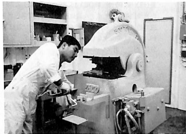
ケーブル接続作業（200 T プレス）
