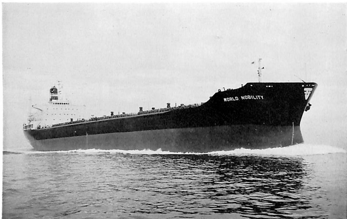
WORLD NOBILITY (ばら積貨物船) 船主 JADE SHIPPING CO.(リベリヤ) 造船所 株式会社 呉造船所 全長 191.01 m 長(垂) 180.00 m 幅(型) 28.956 m 深(型) 16.750 m 吃水 11.558 m 総噸数 22,549.43 噸 載貨重量 41,647.00 噸 速力 14.3 ノット 主機 三井 B&W 774-VT 2 BF-160 型ディーゼル機関 1 基 出力(連続最大) 11,500 PS 船級 AB 起工 42-4-7 進水 42-8-5 竣工 42-11-9
