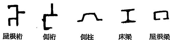
第2図 アルミコンテナ型材断面形状
