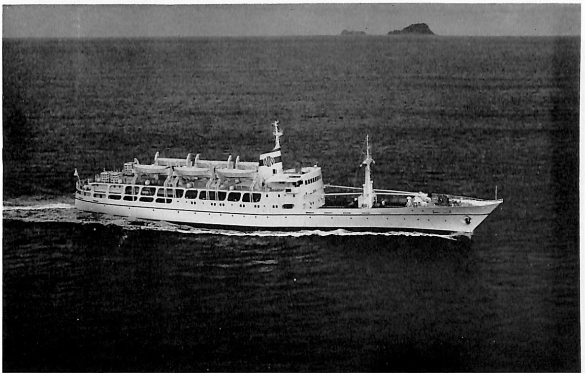
DON JULIO (貨客船) 船主 NEGROS NAVIGATION CO. (フィリピン) 造船所 舞鶴重工・舞鶴造船所 全長 95.65 m 長(垂) 85.00 m 幅(型) 13.80 m 深(型) 7.50 m 吃水 5.158 m 総噸数 2,115.78 噸 貨物倉 1,536 m 3 速力(試) 19.5 ノット 主機 日立 B&W 842-VT 2 BF 型ディーゼ ル機関 1 基 出力(連続最大) 4,400 PS 船級 AB 起工 42-6-29 進水 42-9-16 竣工 42-12-9
