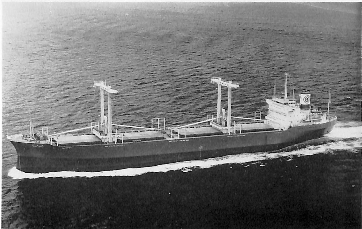
空 光 丸 (ばら積貨物船) 船主 三光汽船株式会社 造船所 佐野安船渠株式会社 総噸数 11,463.95噸 純噸数 6,411.49噸 船級 NK 載貨重量 18,438噸 全長 155.04 m 長(垂) 146.00 m 幅(型) 22.80 m 深(型) 12.50 m 吃水 8.90 m 主機 IHI スルザー 7 RD 68型ディーゼ ル機関1基 出力(最大) 8,400 PS×135 RPM 速力 14.6ノット 貨物倉容積(ベール) 21,785.1 m 3 (グリーン) 22,649.8 m 3 乗組員 34名 起工 42-7-3 進水 42-9-25 竣工 42-11-29
