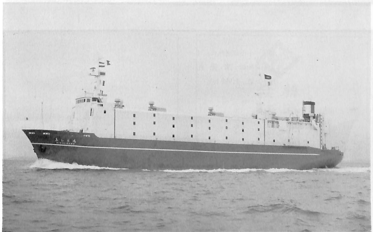
あ い ち 丸 (自動車運搬船) 船主 泉汽船株式会社, 船舶整備公団 造船所 尾道造船株式会社 総噸数 2,611.19 噸 純噸数 1,784.21 噸 載貨重量 1,300 噸 全長 96.70 m 長(垂) 86.80 m 幅(型) 14.60 m 深(型) 7.65 m 吃水 4.791 m 満載排水量 4,115.00 噸 主機 日立 B&W 642 -VBF-75 型ディーゼル機関 1 基 出力 2,500 PS×240 RPM 速力 13.50 ノット 貨物倉(ベール) 12,850.50 m 3 (グリーン) 14,208.30 m 3 燃料油倉 155.31 m 3 清水倉容積 131.13 m 3 乗組員数 19 名 起工 42-4-26 進水 42-9-16 竣工 42-11-27 設備 ランプドア, 可変式スロープウェイ, ローラ移動式仮設甲板
