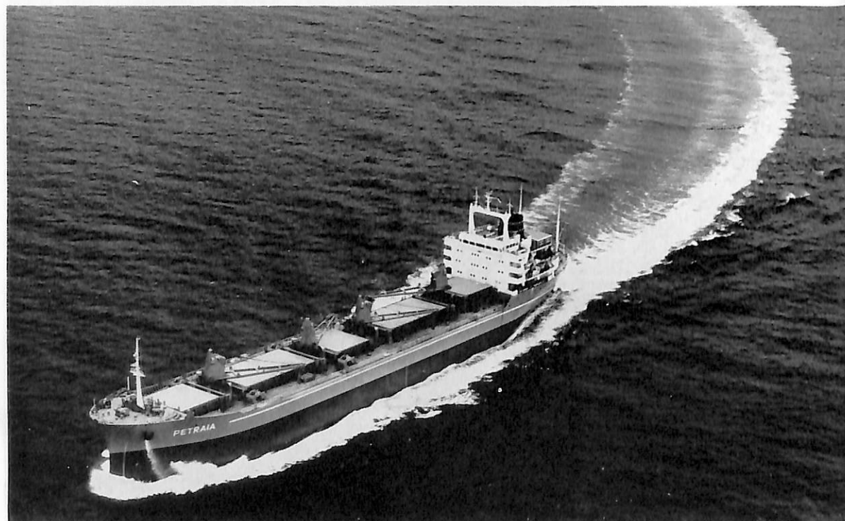
PETRAIA (ばら積貨物船) 船主 UNION NAVALE (フランス) 造船所 佐野安船渠株式会社 総噸数 10,668.29 噸 純噸数 7,250.75 噸 船級 BV 載貨重量 16,373 噸 全長 147.52 m 長(垂) 140.00 m 幅(型) 20.50 m 深(型) 12.55 m 吃水 9.092 m 船型 凹甲板船尾機関型 主機 IHI ピールスチック 10 PC 2 V 型ディーゼル機関 2 基 出力(連続最大) 2×4,520 PS×428 RPM 航続距離 9,400 海里 速力(試運転最大) 18.17 ノット (満載航海) 14.9 ノット 貨物倉(グリーン) 23,509.5 m 3 乗組員数 34 名 起工 42-5-30 進水 42-8-9 竣工 42-11-18
