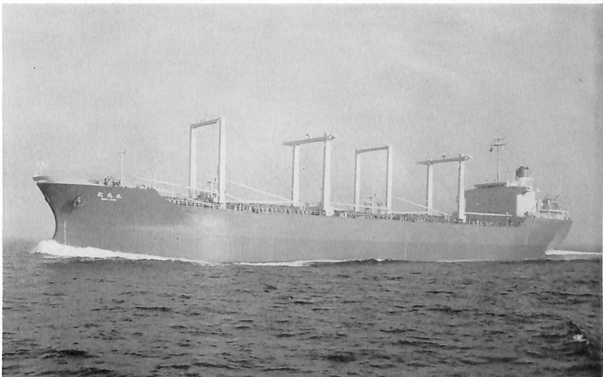
武 光 丸 (ばら積貨物船) 船主 三光汽船株式会社 造船所 株式会社 大阪造船所 長(垂) 158.00 m 幅(型) 22.80 m 深(型) 14.00 m 吃水 10.13 m 総噸数 14,594.76噸 載貨重量 23,489.00噸 速力(試) 17.3ノット 主機 IHI スルザー 6 RD 76型ディーゼル機関1基 出力 9,600 PS×119 RPM 船級 NK 起工 42-7-11 進水 42-9-9 竣工 42-11-30
