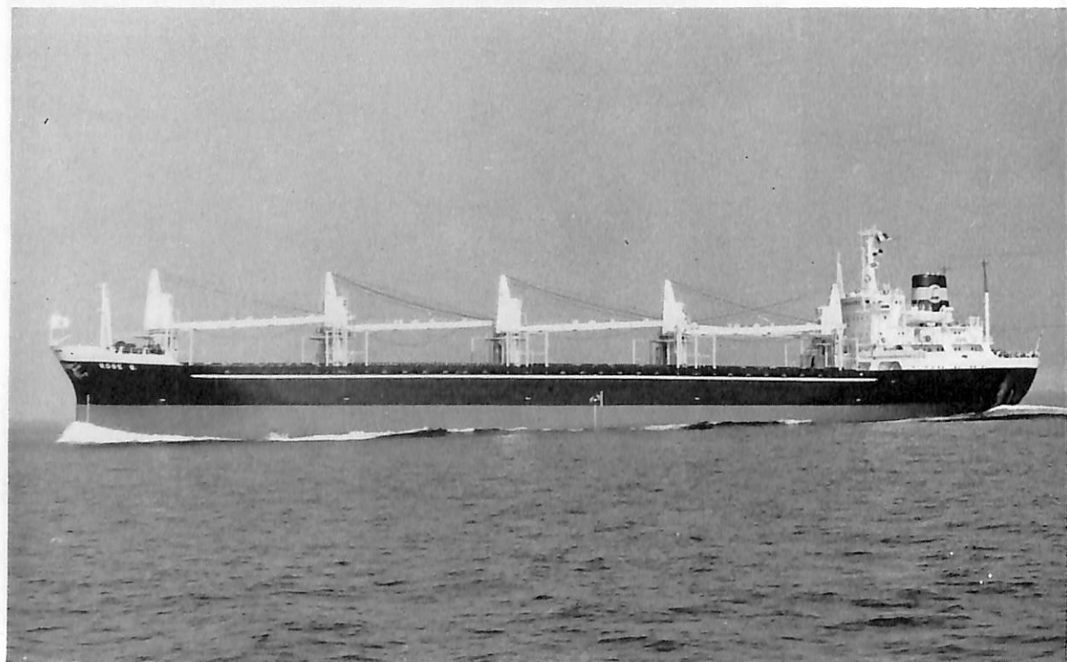
ROSE S. (ばら積貨物船) 船主 GREAT PACIFIC SHIPPING.(リベリヤ) 造船所 笠戸船渠株式会社 総噸数 11,719.82 噸 純噸数 6,922 噸 船級 LR 載貨重量 18,991 噸 全長 158.00 m 長(垂) 148.00 m 幅(型) 22.60 m 深(型) 13.30 m 吃水 31'-2 1 / 2 " 満載排水量 24,992 噸 主機 IHI スルザー 7 RD 68 型ディーゼル機関 1 基 出力 7,560 PS×137 RPM 速力 14.5 ノット 貨物倉(ベール) 872,824 Ft 3 (グリーン) 898,029 Ft 3 燃料油倉 51,943.3 Ft 3 清水倉 8,415.5 Ft 3 乗組員数 41 名 起工 42-2-21 進水 42-7-22 竣工 42-11-7
