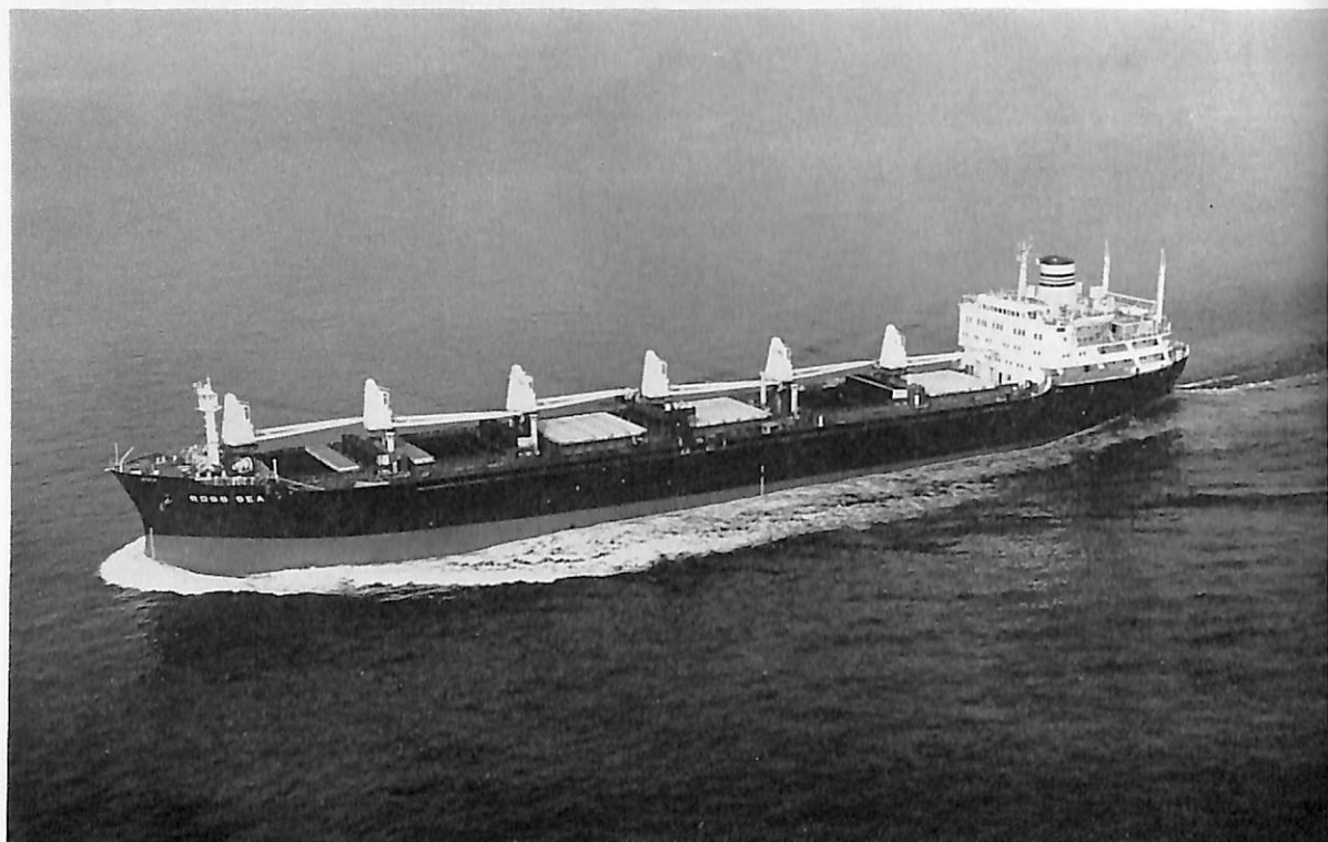
ROSS SEA (ばら積貨物船) 船主 ROSSHAVET A/S (ノルウェー) 造船所 株式会社 名村造船所 総噸数 15,704.29 噸 純噸数 9,635.87 噸 船級 NV 載貨重量 23,602 噸 全長 174.37 m 長(垂) 164.5 m 幅(型) 22.8 m 深(型) 14.2 m 吃水 9.906 m 満載排水量 30,478 噸 主機 三井 B&W 774 VT 2 BF-160 型ディーゼル機関 1 基 出力 10,500 PS×115 RPM 速力 15.5 ノット 貨物倉(ベール) 32,048 m 3 (グリーン) 32,901 m 3 燃料油倉 3,106 m 3 清水倉 163 m 3 乗組員数 44 名 起工 42-3 7 進水 42-7-11 竣工 42-11-30
