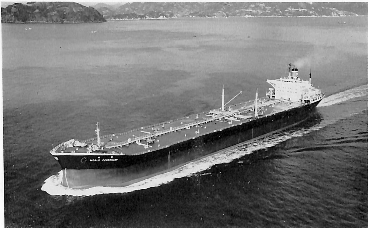
WORLD CENTENARY (油槽船) 船主 LIBERIAN MERIDIAN TRANSPORTS. (リベリア) 造船所 佐世保重工・佐世保造船所 全長 271.00 m 長(垂) 260.00 m 幅(型) 39.00 m 深(型) 18.80 m 吃水 14.148 m 総噸数 49,339.06 噸 載貨重量 101,686 噸 速力 15.4 ノット 主機 IHI スルザー9RD 90型ディーゼル機関1基 出力(最大) 20,700 PS 船級 LR 起工 42 7-18 進水 42-10-12 竣工 42-12-21
