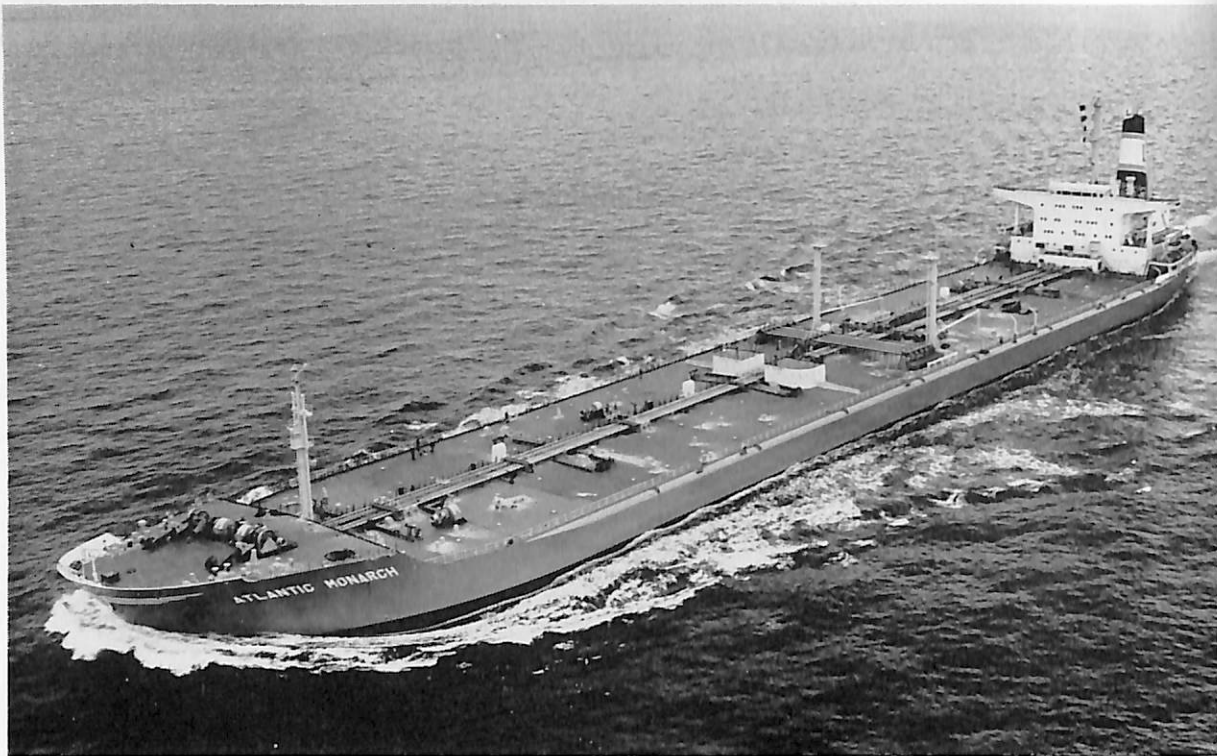
ATLANTIC MONARCH (油槽船) 船主 ATLANTIC MONARD SHIPING CO. (リベリヤ) 造船所 三菱重工・長崎造船所 長(垂) 263.0m 幅(型) 38.5m 深(型) 18.8m 吃水 13.7m 総噸数 49,800噸 載貨重量 98,920噸 速力 15.1ノット 主機 三菱タービン 出力 20,000 PS 船級 LR 起工 42-7-12 進水 42-10-16 竣工 42-12
