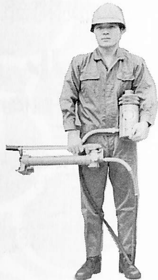
50トﾝ手動油圧ポンプユニット、超高压ポンプのため、ラムが非常に小型化され、作業の上にも持ち運びにも極めて便利に出来て居ります。
