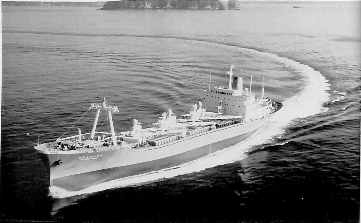
せんとうすいす丸 (貨物船) 船主 大阪商船三井船舶株式会社 造船所 日本鋼管・鶴見造船所 長(垂) 145.0 m 幅(型) 21.8 m 深(型) 13.2 m 吃水 9.0 m 総噸数 10,300 噸 載貨重量 17,700 噸 速力 18.5 ノット 主機 三菱スルザー 7RD76 型ディーゼル機関 1 基 出力 11,200 PS×122 RPM 船級 NK 起工 42-4-20 進水 42-10-3 竣工 42-12-20
