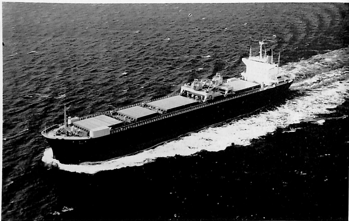
王子丸 (チップ運搬船) 船主 山下新日本汽船株式会社, 日正汽船株式会社 造船所 舞鶴重工・舞鶴造船所 全長 176.20 m 長(垂) 165.00 m 幅(型) 25.00 m 深(型) 17.50 m 吃水 10.023 m 総噸数 20,697.85 噸 載貨重量 26,613.2 噸 貨物倉容積 48,879 m 3 速力(試) 16.66 ノット 主機 日立 B&W 862-VT 2 BF-140 型ディーゼル機関 1 基 出力(連続最大) 9,600 PS 船級 NK 起工 42-4-21 進水 42-9-27 竣工 42-12-23
